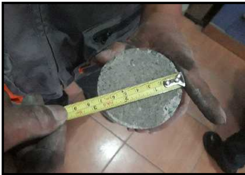
FIGURA 36: SE OBSERVA LA MEDICION DE LAS MUESTRAS, EL ANCHO QUE SE MANEJO PARA EL ENSAYO A COMPRESION FUE DE UN RADIODE R=3.5\text{CM} FUENTE: EL AUTOR
