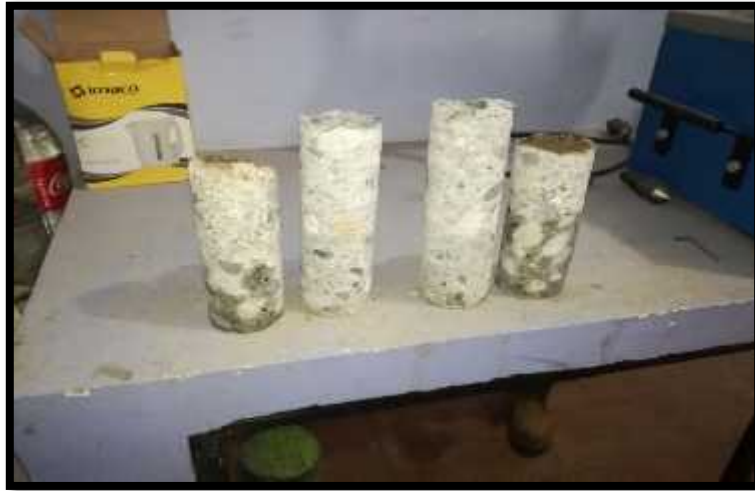
FIGURA 13: EXTRACCION DE CORAZONES FUENTE: EL AUTOR
