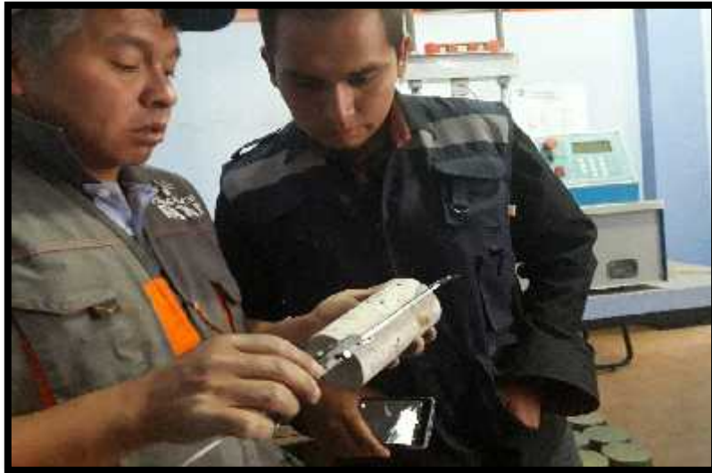
FIGURA 37: SE OBSERVA LA MEDICION DE LAS MUESTRA CON AYUDA DE LOS EQUIPOS SOFISTICADOS Y EL EQUIPO TECNICO PARA PROCEDER A LA RUPTURA DE CONCRETO. FUENTE: EL AUTOR
