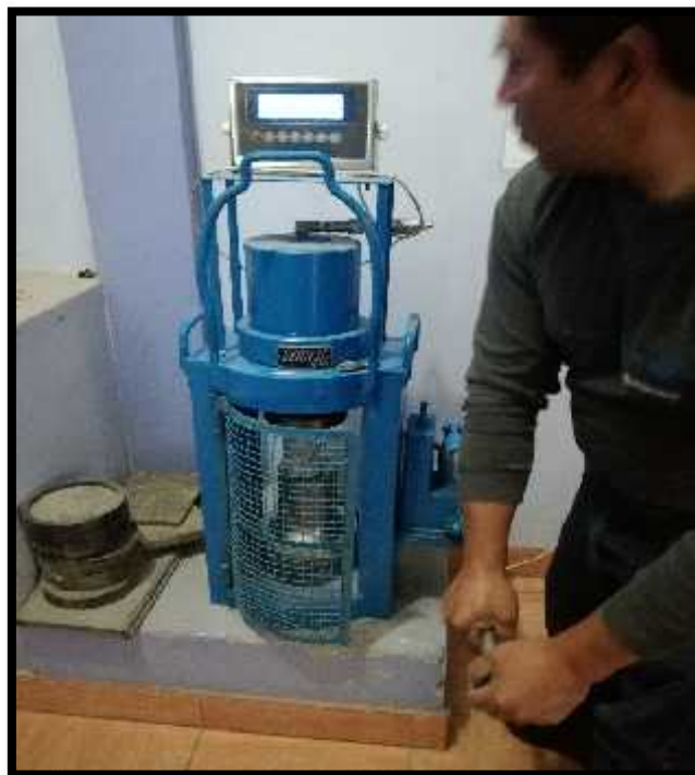
FIGURA 38: SE REALIZA LA COLOCACION Y SEGUIDAMENTE LA RUPTURA DE LA PRIMERA MUESTRA (M1).ESTA PERTENECE A LA AV.28 DE JULIO, DE LA PROVINCIA DE YUNGAY FUENTE: EL AUTOR
