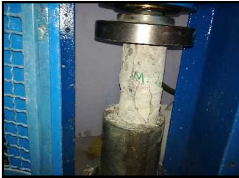
FIGURA 43: SE OBSERVA EL ACABADO DEL TESTIGO NUMERO 2 EN LA MAQUINA PARA ENSAYOS DE CONCRETO FUENTE: EL AUTOR
