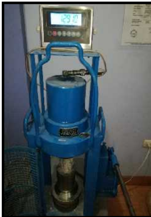
FIGURA 42: SE REALIZO LA RUPTURA DE LA SEGUNDA MUESTRA, ESTA NOS DIO EL VALOR DE M_2=12,910 KG, LA PRIMERA MUESTRA DE LA AV.28 DE JULIO. FUENTE: EL AUTOR
