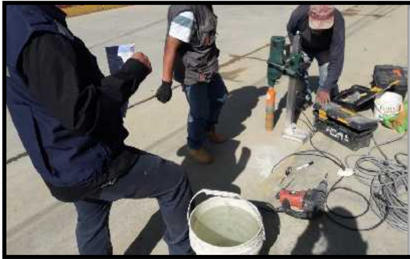
FIGURA 25: SE OBSERVA LA EXTRACCION DE LA MUESTRA CON LA AYUDA DEL EQUIPO DE DIAMANTINA EN LA AV 28 DE JULIO FUENTE: EL AUTOR
