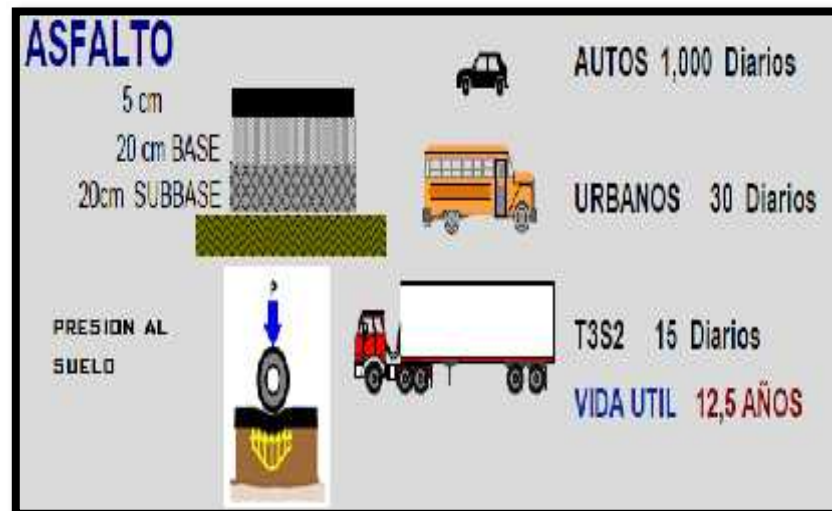
FIGURA 02: PAVIMENTO FLEXIBLE FUENTE: JAVIER M (2010)- Deterioro en pavimentos rígidos y flexibles
