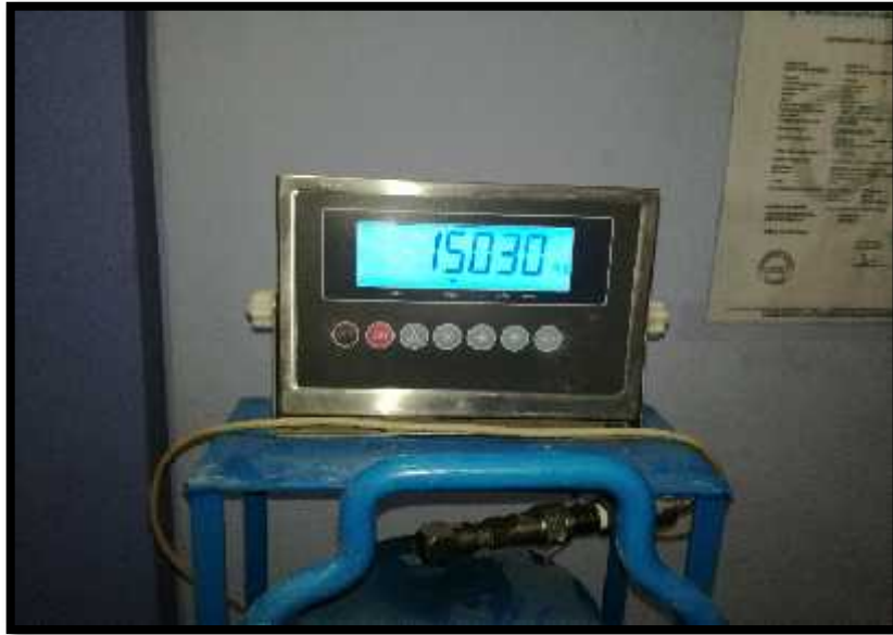
FIGURA 39: SE REALIZO LA RUPTURA DE LA PRIMERA MUESTRA, ESTA NOS DIO EL VALOR DE M1=15030 KG, LA PRIMERA MUESTRA DE LA AV.28 DE JULIO. FUENTE: EL AUTOR
