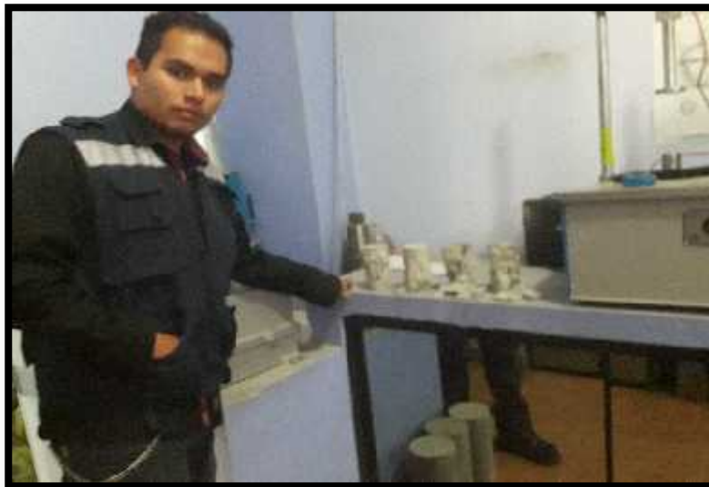
FIGURA 52: SE OBSERVA LAS MUESTRAS, ESTAS YA UNA VEZ SIDO LLEVADAS A EQUIPO DE RUPTURA DE CONCRETO. FUENTE: EL AUTOR
