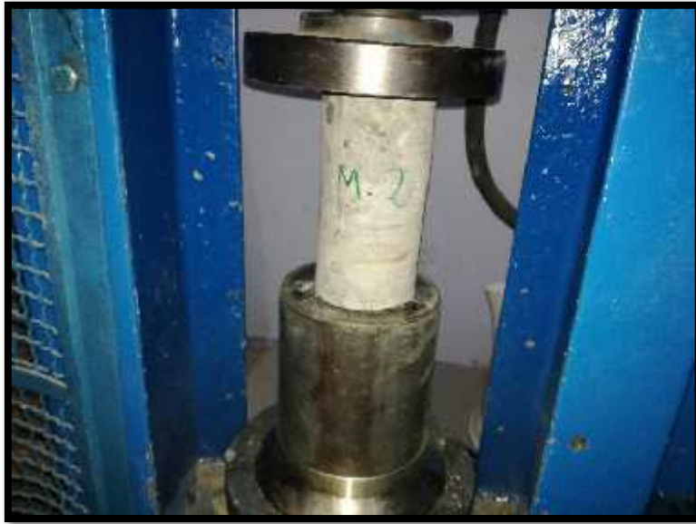
FIGURA 41: SE REALIZA LA COLOCACION Y SEGUIDAMENTE LA RUPTURA DE LA SEGUNDA MUESTRA (M2).ESTA PERTENECE A LA AV.28 DE JULIO, DE LA PROVINCIA DE YUNGAY FUENTE: EL AUTOR
