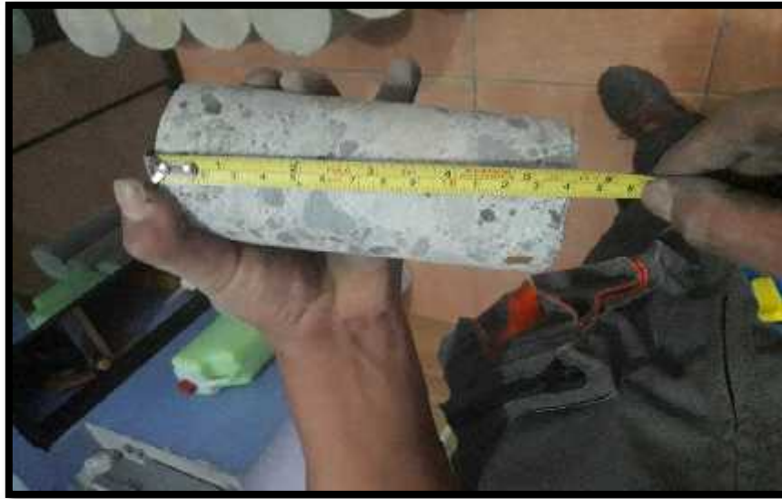
FIGURA 35: SE OBSERVA LA MEDICION DE LAS MUESTRAS, ESTAS TIENEN UN LARGO DE 14.50 CM DE LARGO. FUENTE: EL AUTOR
