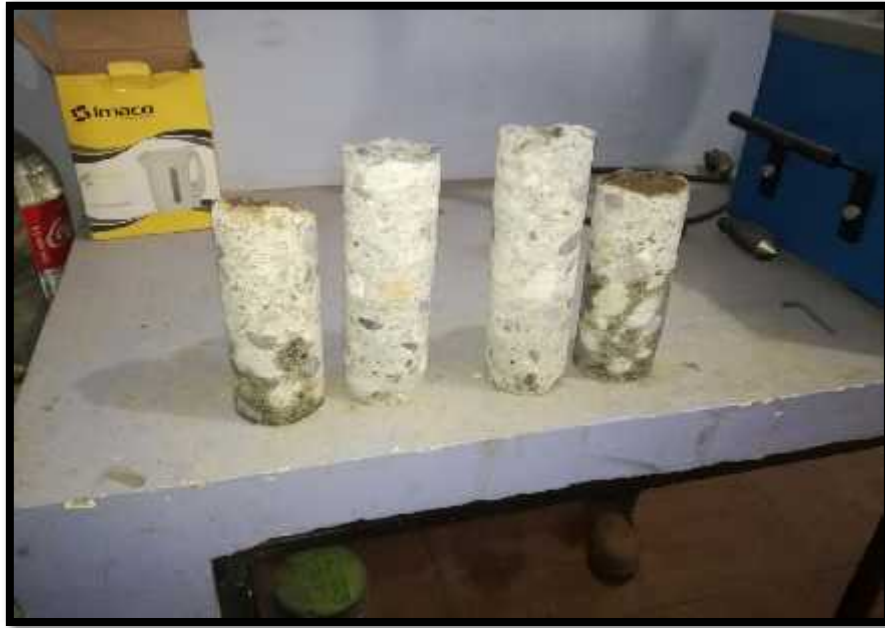
FIGURA 33: SE OBSERVA LAS MUESTRAS EXTRAIDAS, ESTAS SERAN CORTADAS HASTA LLEGAR A UNA CARA PLANA, PARA ASI PODER VERIFICAR SU RESISTENCIA DE CONCRETO CON LA AYUDA DE LOS EQUIPOS FUENTE: EL AUTOR
