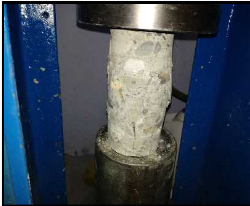
FIGURA 40: SE OBSERVA EL ACABADO DEL TESTIGO NUMERO 1 EN LA MAQUINA PARA ENSAYOS DE CONCRETO FUENTE: EL AUTOR
