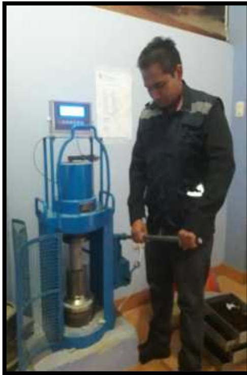
FIGURA 51: SE OBSERVA A MI PERSONA REALIZANDO LA RUPTURA DE CONCRETO, DEACUERDO A LAS ESPECIFICACIONES TECNICAS FUENTE: EL AUTOR
