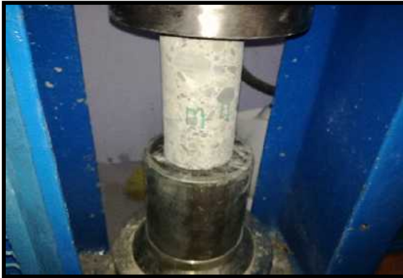
FIGURA 47: SE REALIZA LA COLOCACION Y SEGUIDAMENTE LA RUPTURA DE LA CUARTA MUESTRA (M4).ESTA PERTENECE A LA AV. ARIAS GRAZZINI NORTE, DE LA PROVINCIA DE YUNGAY FUENTE: EL AUTOR
