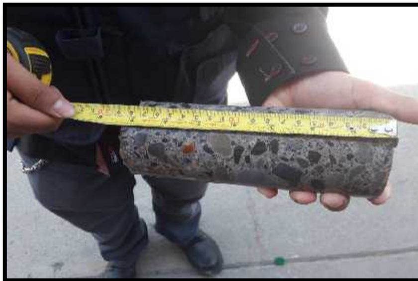
FIGURA 28: SE OBSERVA LA MEDICION DE LAS MUESTRAS UNA VEZ REALIZADA LA EXTRACCION EN EL SEGUNDO PUNTO, AV ARIAS GRAZZINI NORTE FUENTE: EL AUTOR
