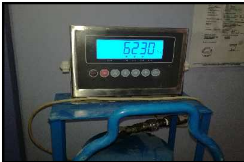
FIGURA 48 SE REALIZO LA RUPTURA DE LA CUARTA MUESTRA, ESTA NOS DIO EL VALOR DE M_2=6,230 KG, LA PRIMERA MUESTRA DE LA AV.ARIAS GRAZZINI NORTE FUENTE: EL AUTOR
