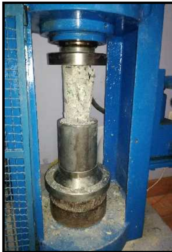
FIGURA 46: SE OBSERVA EL ACABADO DEL TESTIGO NUMERO 3 EN LA MAQUINA PARA ENSAYOS DE CONCRETO FUENTE: EL AUTOR
