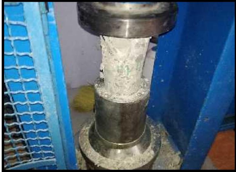
FIGURA 49: SE OBSERVA EL ACABADO DEL TESTIGO NUMERO 4 EN LA MAQUINA PARA ENSAYOS DE CONCRETO FUENTE: EL AUTOR
