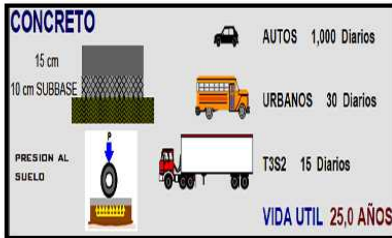
FIGURA 03: PAVIMENTO RIGIDO FUENTE: JAVIER M (2010)- Deterioro en pavimentos rígidos y flexibles
