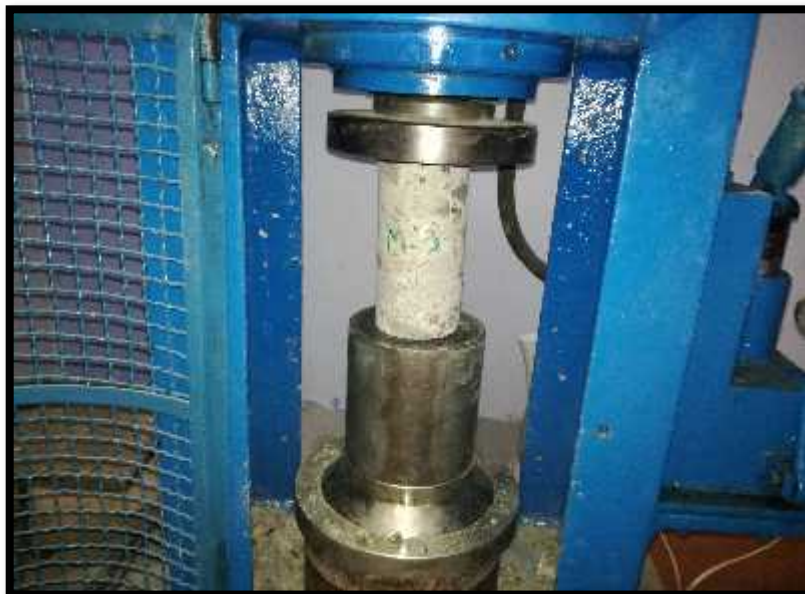
FIGURA 44: SE REALIZA LA COLOCACION Y SEGUIDAMENTE LA RUPTURA DE LA TERCERA MUESTRA (M3).ESTA PERTENECE A LA AV. ARIAS GRAZZINI NORTE, DE LA PROVINCIA DE YUNGAY FUENTE: EL AUTOR
