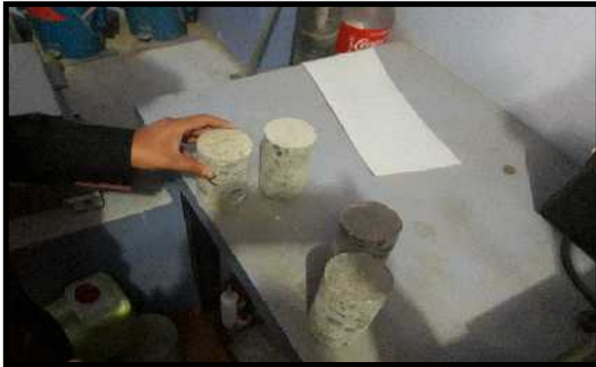
FIGURA 34: SE PROCEDIO A LLEVAR A LAS MUESTRAS AL LABORATORIO, DONDE ESTAS SERAN CORTADAS A UNA ALTURA DE 14.5 CM DE ALTO PARA SER COLOCADAS ESTAS A LOS 7 DIAS EN LA MAQUINA PARA ENSAYOS DE CONCRETO O RUPTURA DE CONCRETO FUENTE: EL AUTOR
