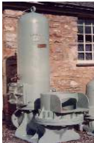
Figura 40. Cuerpo del ariete hidráulico fabricado mediante fundición Fuente: Ortega, 2013.
