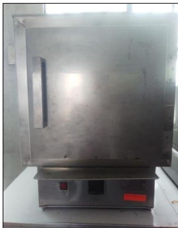
Horno fijo activación de T máxima de 1200 ° c trifásico.
