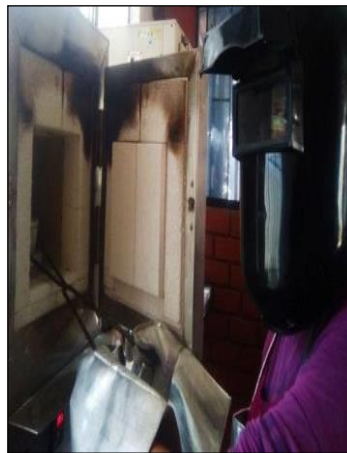
Tratamiento térmico en atmósfera inerte a 600 °C
