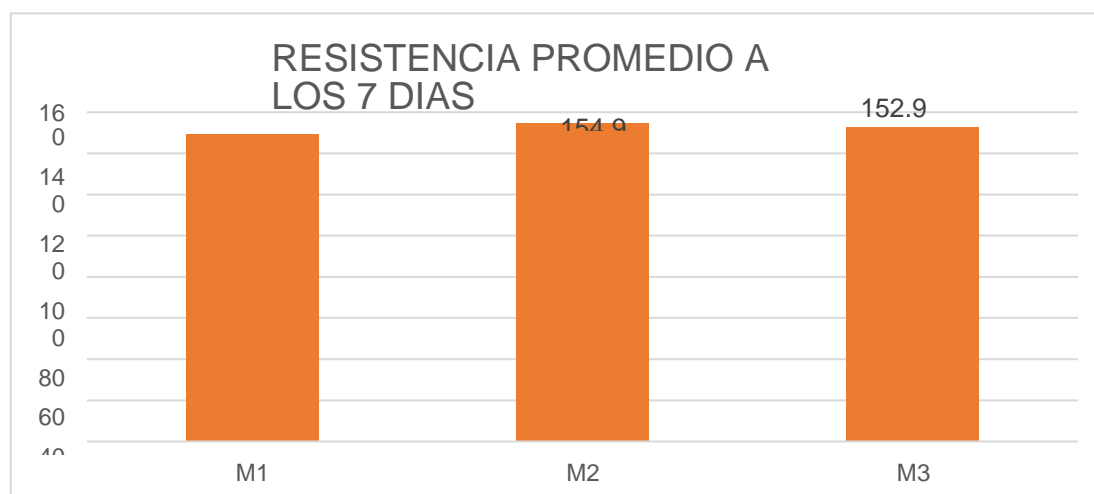
Figura N° 6: Resistencia experimental con sustitución del 5 % a la edad de 7 días de curado.
