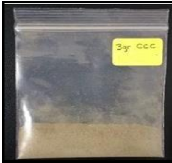
FIGURA N° 17: MUESTRA, MOLIDA Y TAMIZADA POR LA MALLA N° 200 PARA REALIZAR EL ENSAYO ANÁLISIS TÉRMICO DIFERENCIAL.
