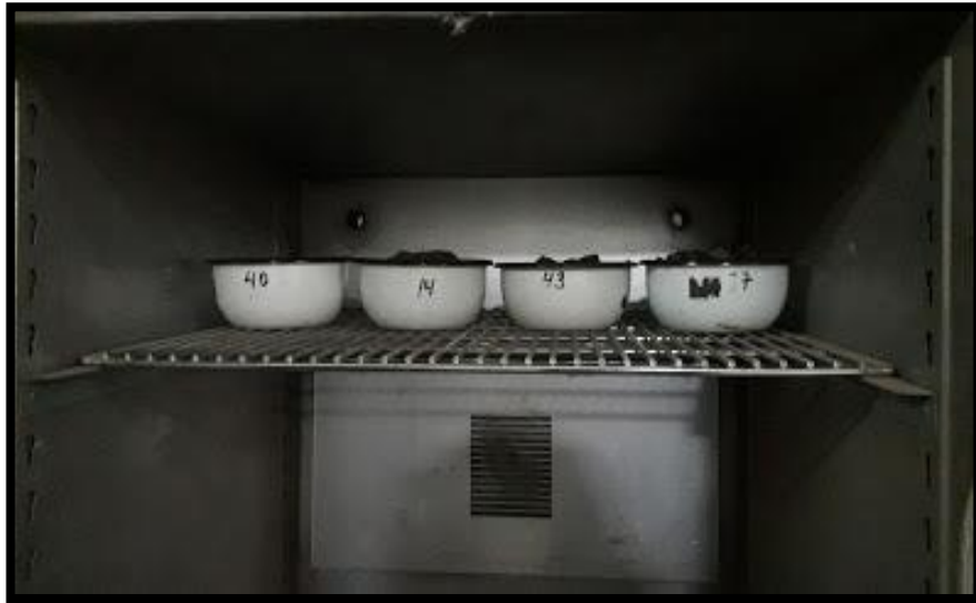
FIGURA N° 19: CONTENIDO DE HUMEDAD.
