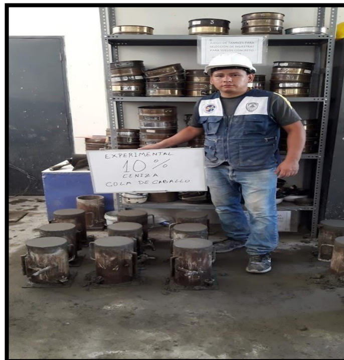
FIGURA N° 32: ELABORACIÓN DEL CONCRETO EXPERIMENTAL 10% F'C= 210 KG/CM2
