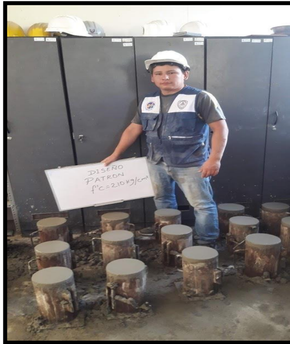
FIGURA N° 27: ELABORACIÓN DEL CONCRETO PATRÓN f'c=210 \text{ KG/CM}^2
