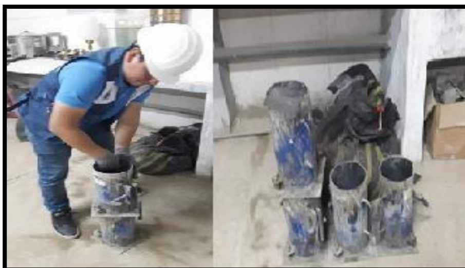
FIGURA N° 24: HACEMOS LA LIMPIEZA Y ARMADO PARA EL VACIADO DE LA MEZCLA.
