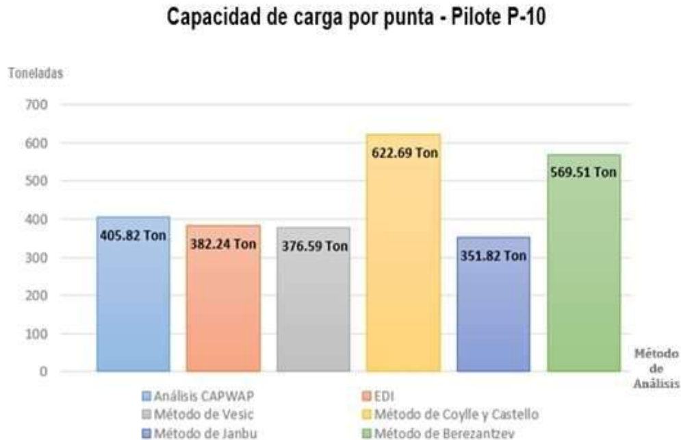
Figura 13: Capacidad de carga por punta – Pilote P-10 del Estribo Izquierdo Puente Huambacho.
