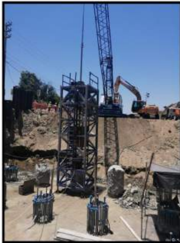
Fotografía N°06: Prueba de Carga Dinámica (ASTM D 4945).
