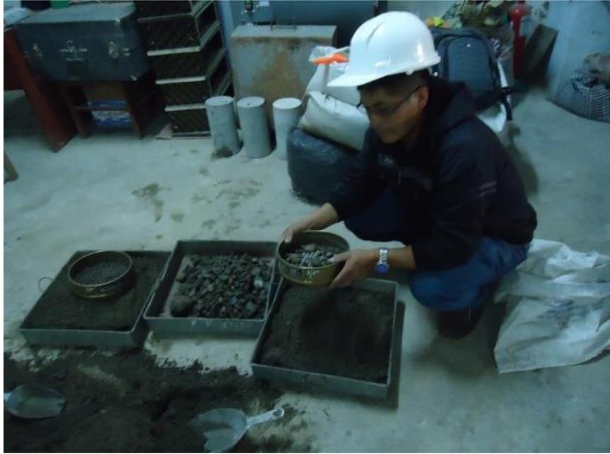
Figura 12. Tamizado del agregado natural de la cantera Tacllan, en el laboratorio
