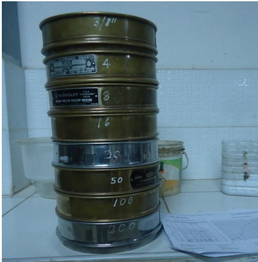
Figura 15. Tamiz para la malla 3/8" hasta la N°200 para el tamizado de los agregados
