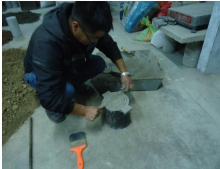
Figura 19. Peso unitario compactado del agregado grueso en el laboratorio
