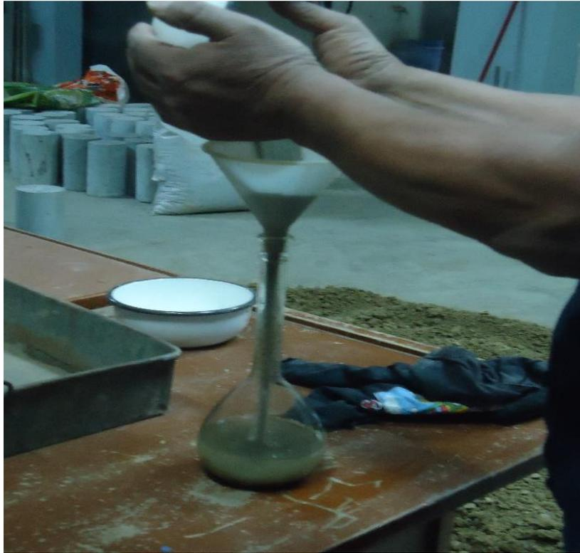
Figura 32. Filtrado del agregado en una fiola
