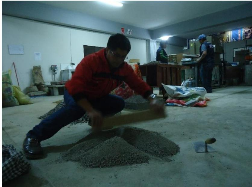
Figura 25. Cuarteo para el agregado reciclado de construcción y demolición
