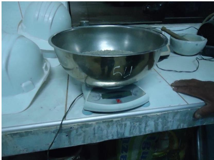
Figura 27. Pesado del agregado reciclado de construcción y demolición para la granulometría
