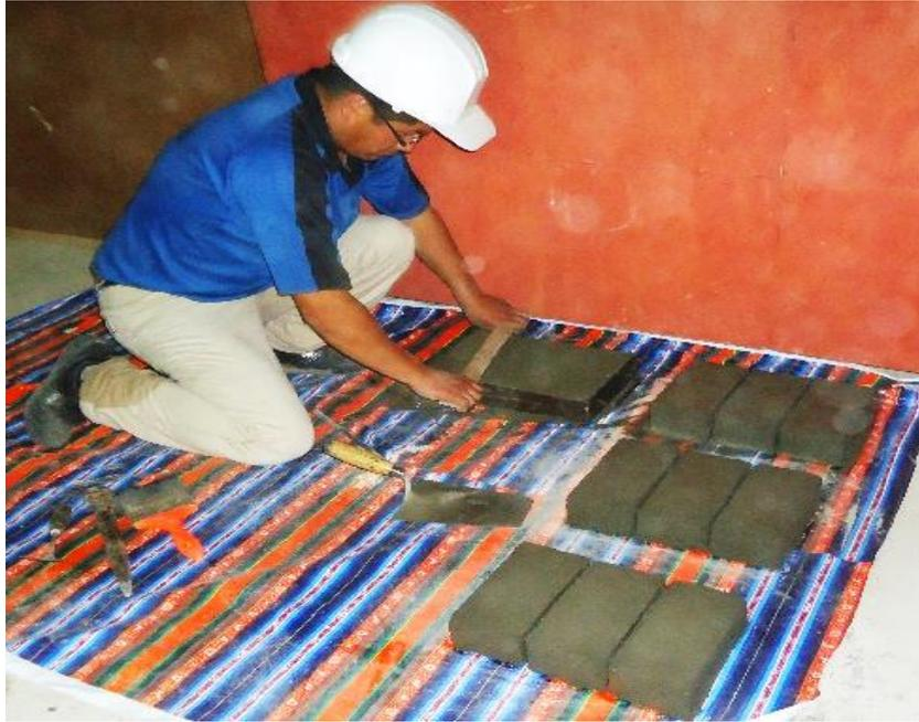
Figura 42. Adoquines de concreto patrón y experimental en estado fresco
