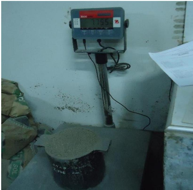
Figura 17. Peso unitario suelto de los agregados
