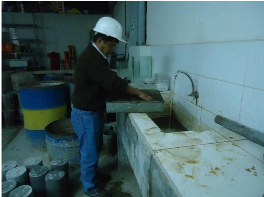
Figura 13. Peso específico del agregado natural de la cantera Tacllan, en el laboratorio
