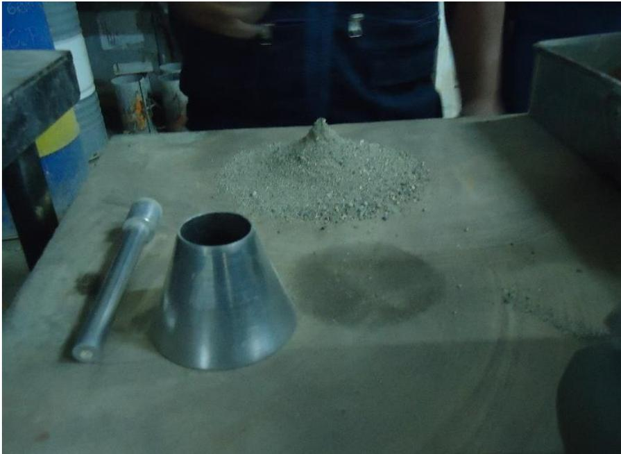
Figura 31. Cantidad de agregado que se puede contener la humedad a tres tiempos de los 24 golpes
