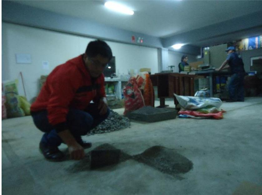
Figura 26. Selección de una parte del agregado reciclado de construcción y demolición para la granulometría
