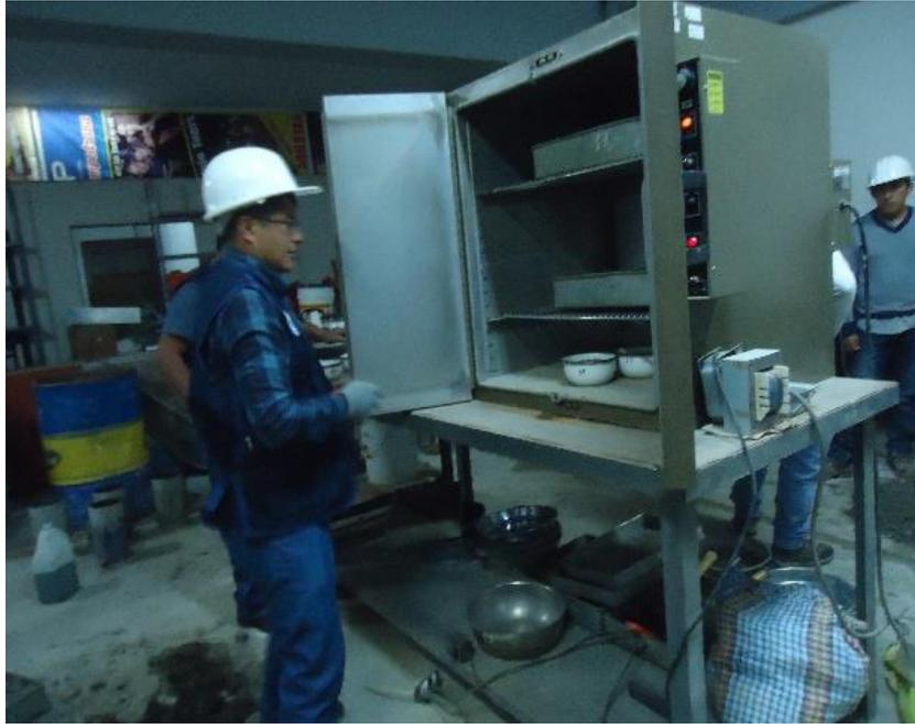
Figura 22. Humedad del agregado de construcción y demolición
