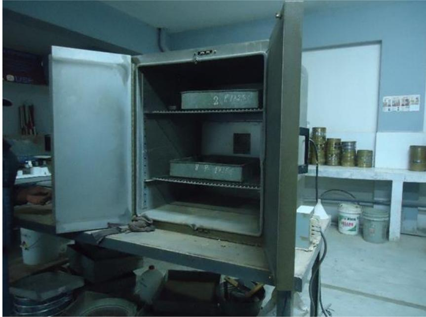
Figura 14. Secado en el horno del agregado natural de la cantera Tacllan, en el laboratorio
