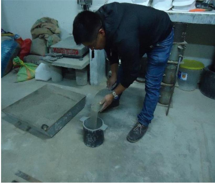
Figura 16. Peso unitario suelto de los agregados
