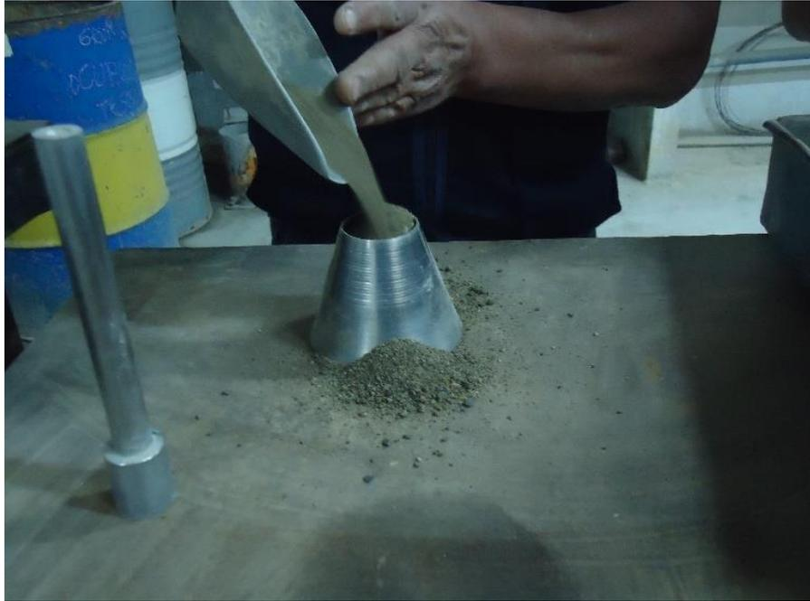
Figura 30. Cono de agregado fino de humedad a tres tiempos de los 24 golpes
