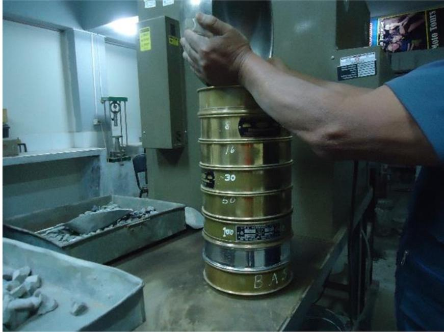
Figura 28. Tamices de las mallas estándares para hacer el tamizado de agregado reciclado
