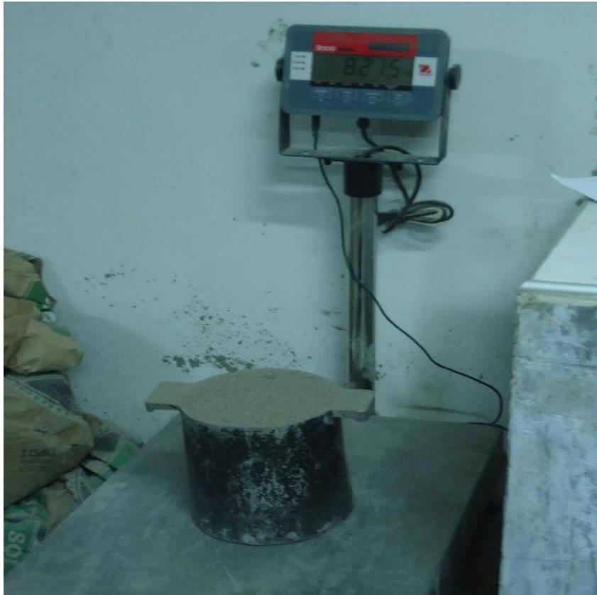
Figura 20. Peso unitario compactado del agregado reciclado de demolición y construcción
