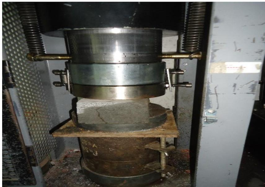
Figura 46. Equipo para la prueba de rotura de la resistencia del adoquín experimental 5%
