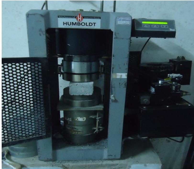
Figura 45. Equipo para la prueba de rotura de la resistencia del adoquín patrón
