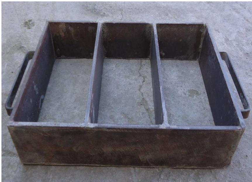
Figura 41. Molde para agregar la mezcla de cemento y agua para elaboración de adoquines
