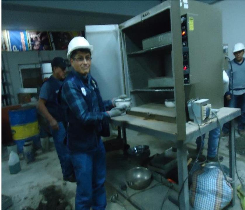
Figura 36. Horno para la prueba de humedad del agregado reciclado de demolición
