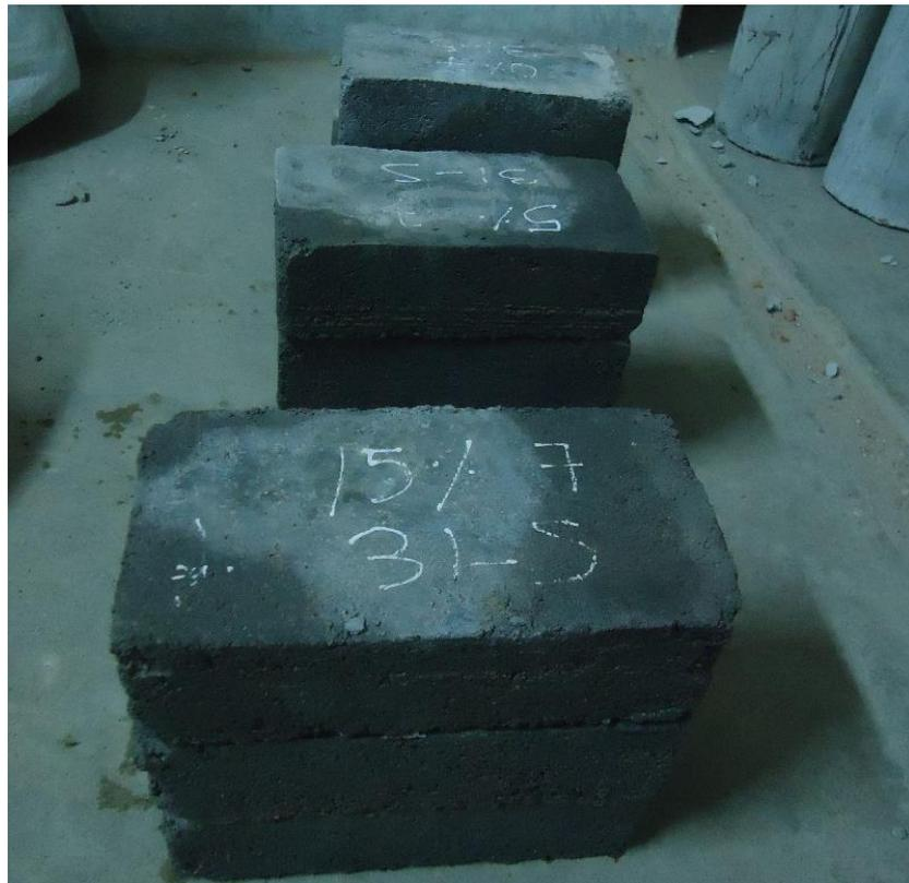
Figura 43. Adoquines de concreto patrón y experimental en estado fresco
