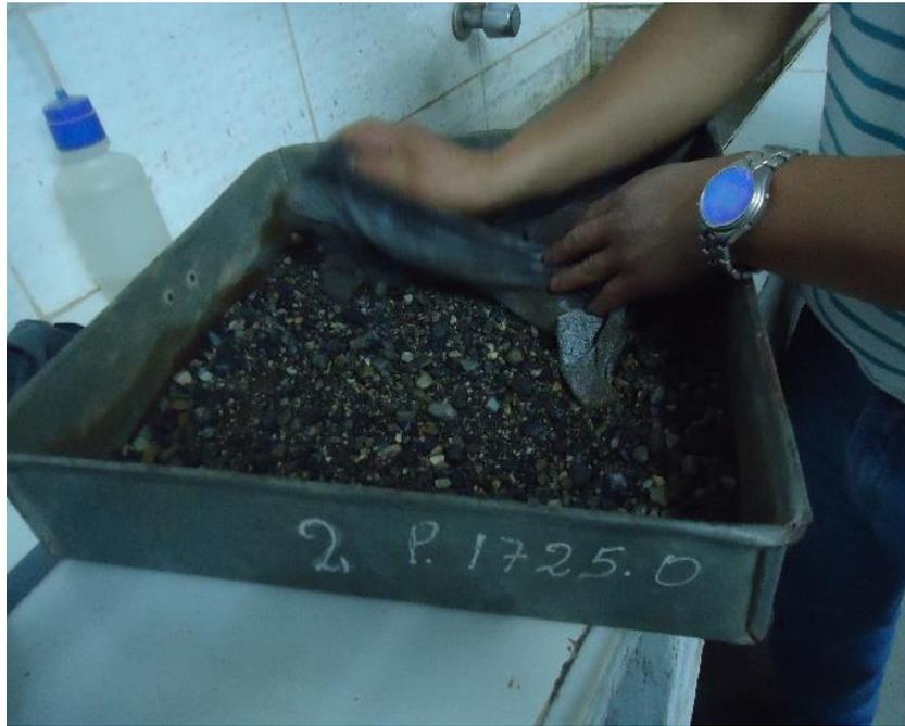
Figura 24. Secado de los agregados naturales
