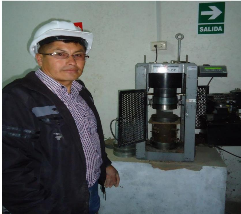
Figura 47. Equipo para la prueba de rotura de la resistencia del adoquín experimental 15%
