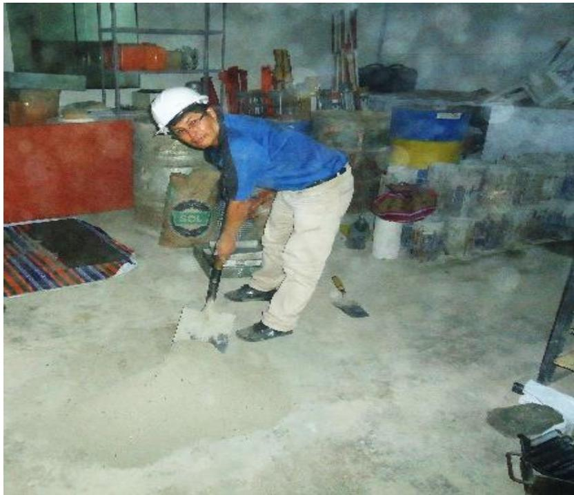
Figura 39. Preparado de la mezcla para elaboración de adoquines
