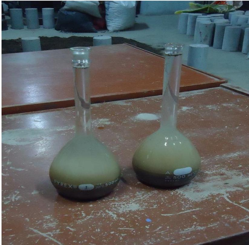
Figura 34. Absorción y saturado del agregado fino natural en una fiola
