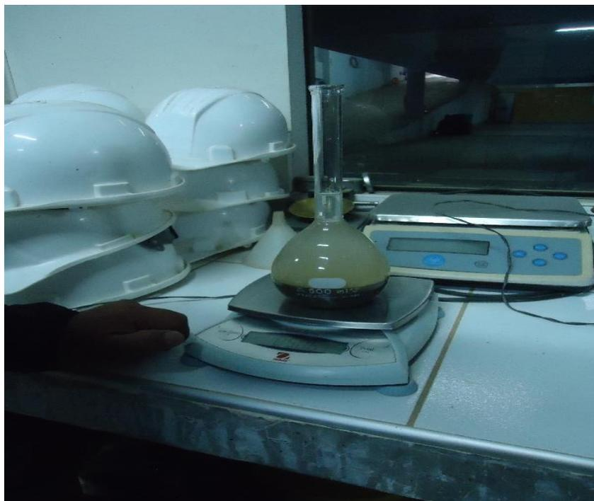
Figura 35. Pesado del agregado fino natural en una fiola
