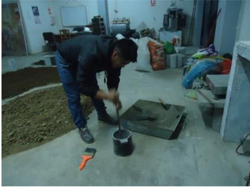
Figura 18. Peso unitario compactado del agregado fino en el laboratorio
