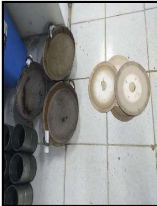
*Figura 41. Se agrega las muestras en un recipiente con agua y detergente para que lo suelte un poco de la gasolina*
