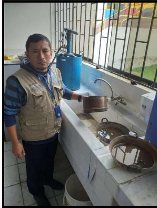
*Figura 42. Después se realiza el lavado por la malla 200*
