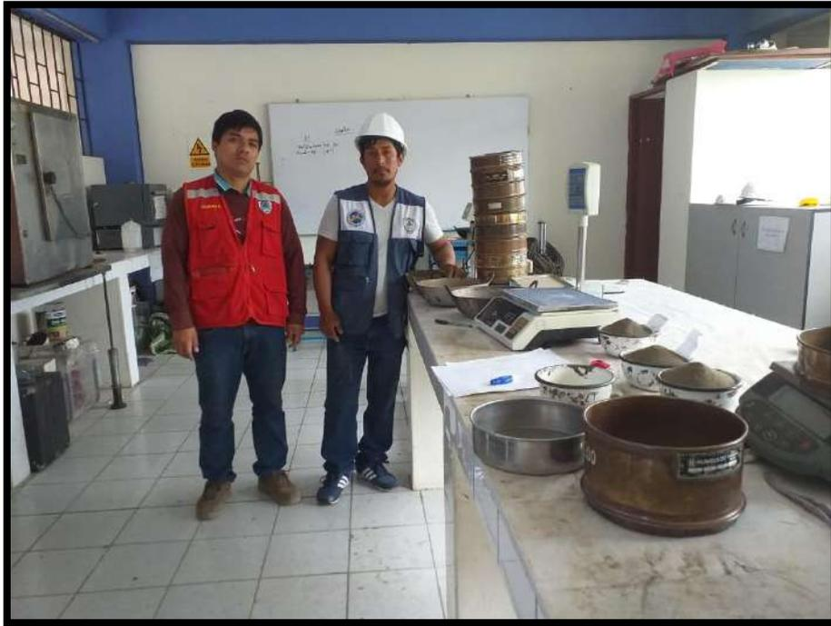
*Figura 44. Después de secado se realiza el pesado para ver el contenido óptimo de líquido asfáltico, y finalmente se realiza la granulometría*
