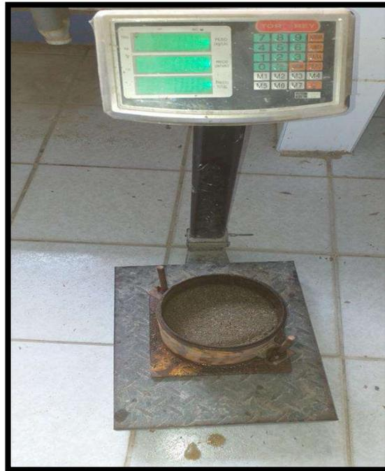
*Figura 34. Después de saturar 4 días, se retira del agua y se procede a pesar para ver la absorción*
