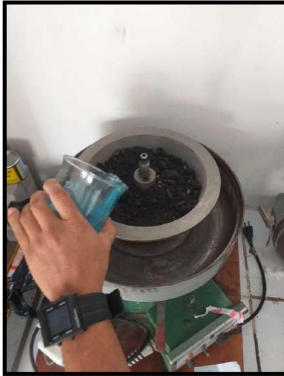
*Figura 36. Realizando el lavado asfáltico de las tres calicatas para eso necesitamos 1500 gramos de cada calicata y gasolina de 90 octanos*
