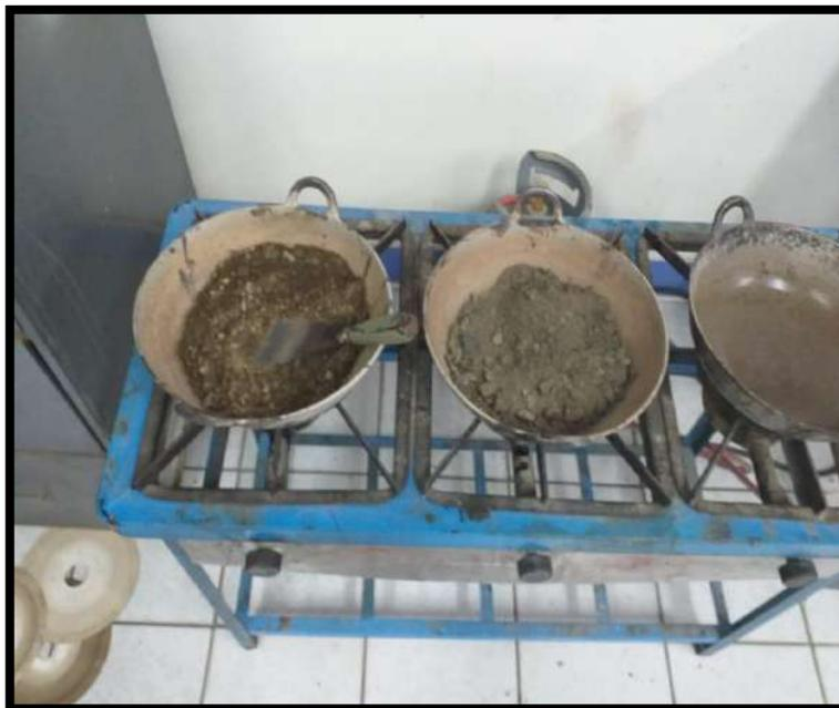
*Figura 43. Después de lavar se lleva al horno por 24 horas o se seca en estufa*
