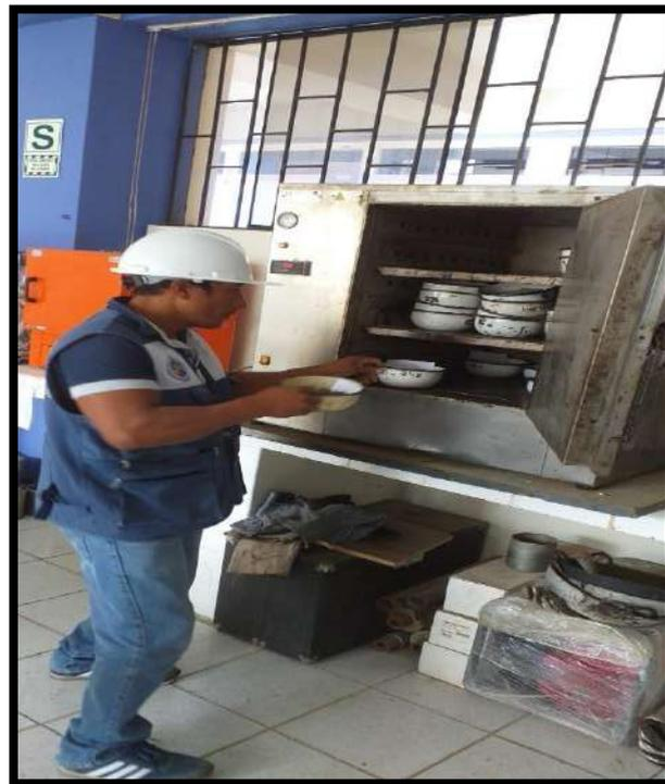
*Figura 26. Se seca la muestra para luego obtener los datos y poder realizar el CBR*
