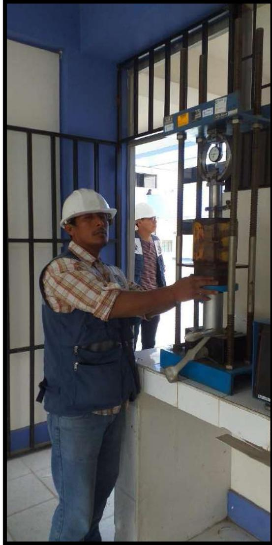
*Figura 35. Después de pesar procedemos a realizar la penetración en la máquina de CBR*
