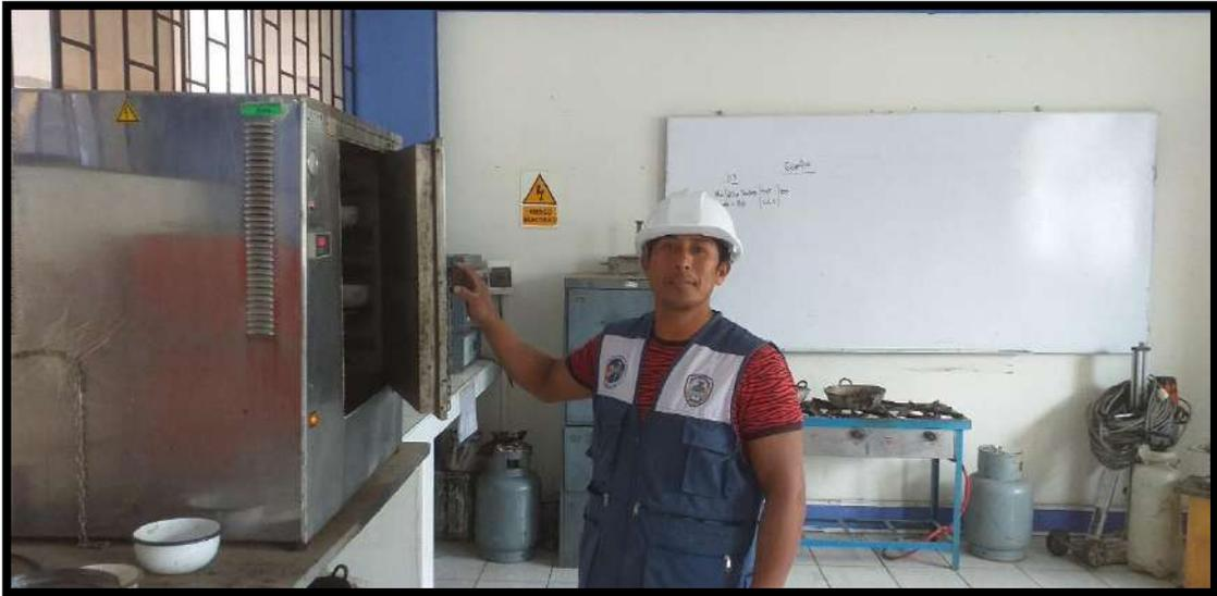
*Figura 17. Después de lavado secamos al horno a 110 grados*
