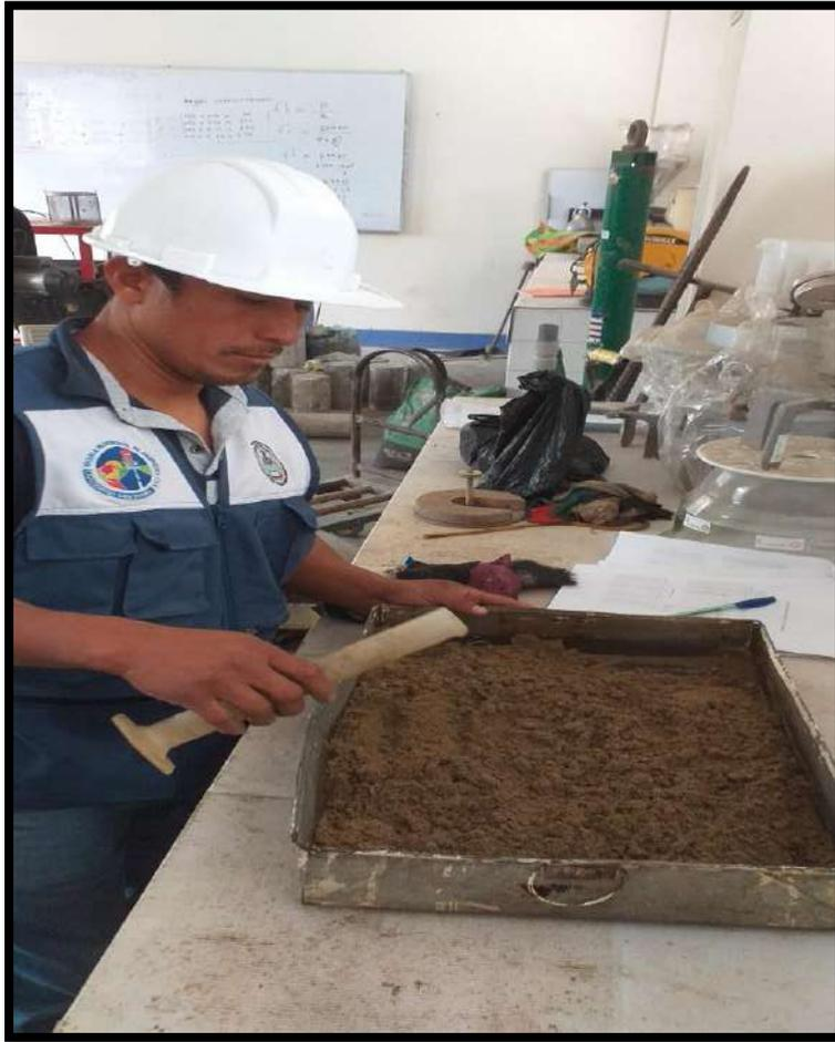
*Figura 19. Realizando el proctor de la sub rasante método A, lo cual necesitamos como muestra 4 muestras de 3 kilogramos*
