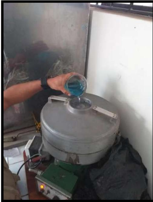
*Figura 38. Ya todo cerrado el equipo empezamos hacer el lavado agregando la gasolina de 90 octanos*
