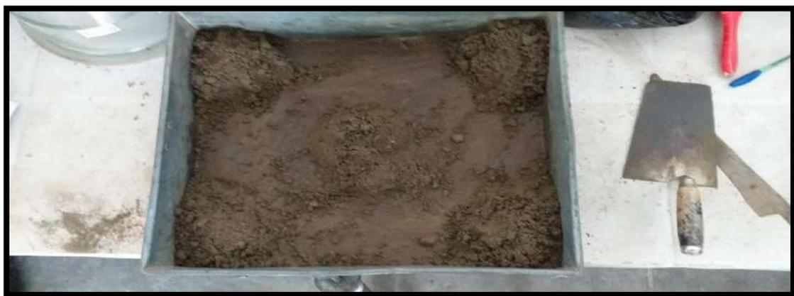
*Figura 20. La muestra se divide en 5 capas iguales y se procede a la compactación*
