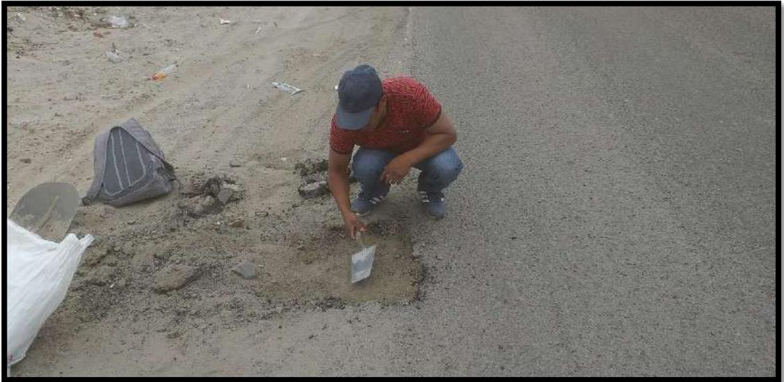
*Figura 11. Revisando el espesor del pavimento*
