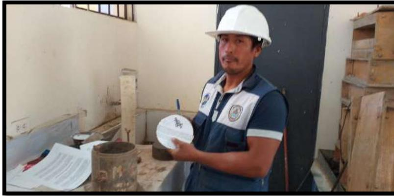
*Figura 31. Se coloca un papel filtro enzima del suelo compactado para luego colocar las pesas*
