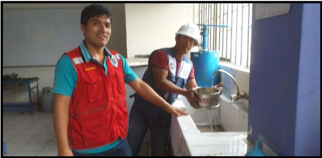
*Figura 16. Realizando la granulometría por lavado por la malla 200*
