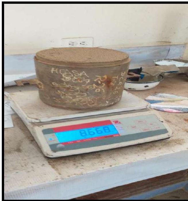
*Figura 30. Pesamos la muestra y luego apuntamos los datos, para luego calcular los resultados*
