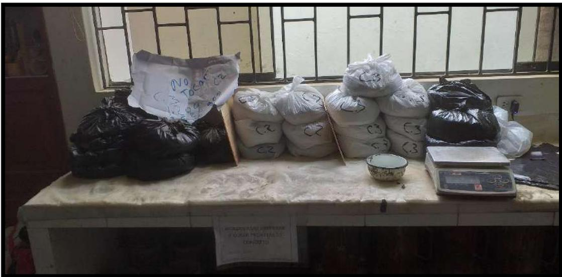
*Figura 18. Pesado y listo para realizar los ensayo de laboratorio ( proctor y CBR)*
