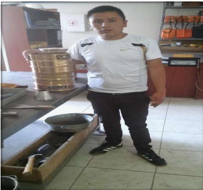
Figura 10. Tamices listo para realizar la granulometría
