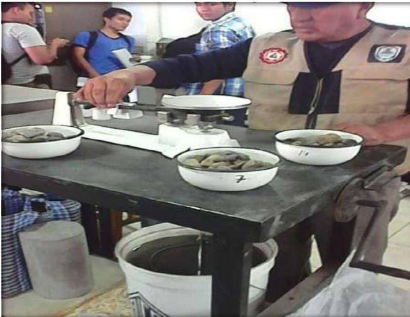
Figura 20. Gravedad específica del agregado grueso
