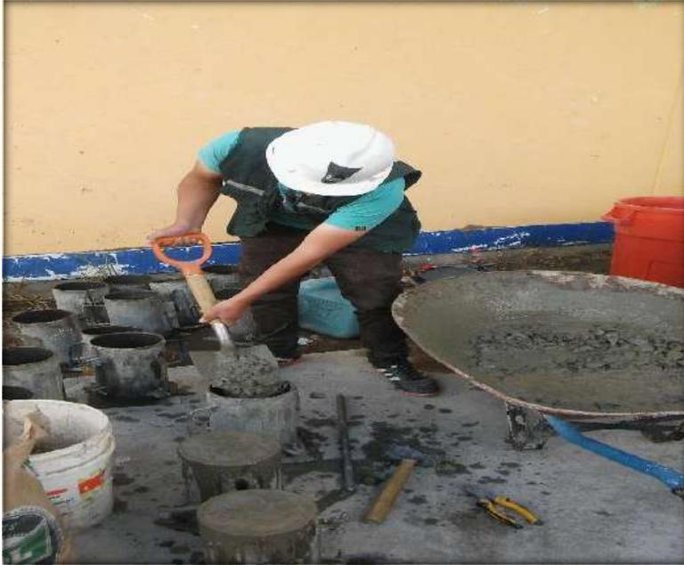
Figura 23. Realizando el vaciado de los moldes
