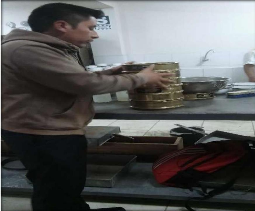
Figura 11. Realizando el tamizado de los agregados
