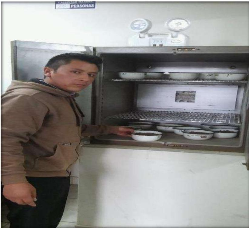
Figura 13. Hallando el contenido de humedad del agregado
