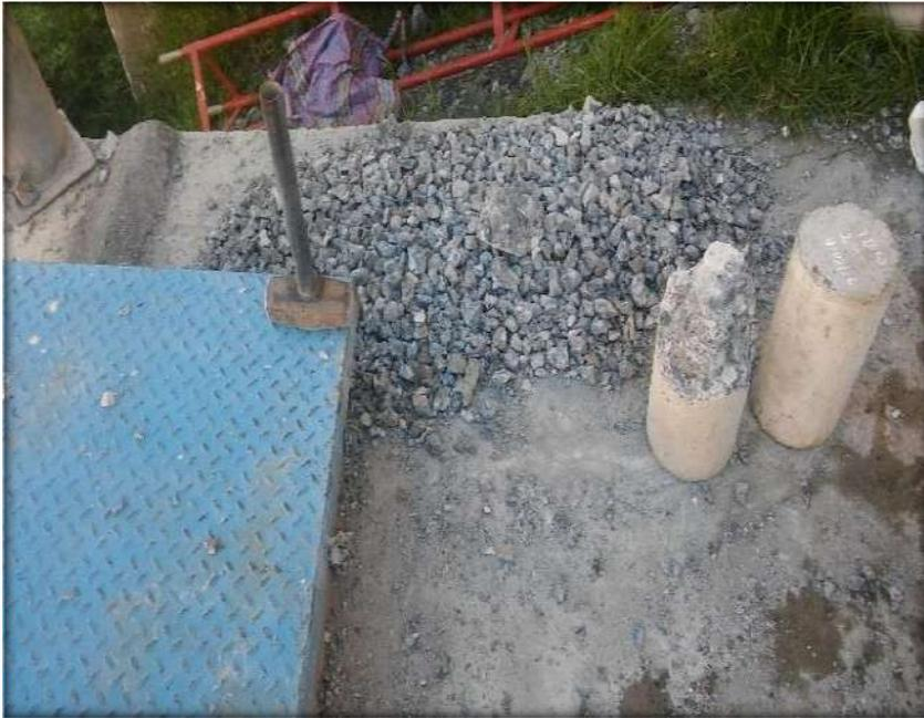
Figura 7. Chancado de probetas para agregado reciclado
