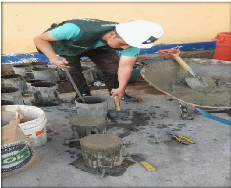
Figura 24. Realizando el varillado en 3 capas
