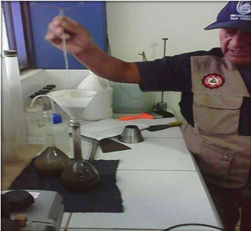
Figura 18. Realizando el llenado de la muestra en la fiola
