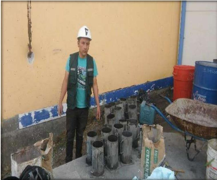
Figura 21. Limpieza de moldes para el vaciado de concreto
