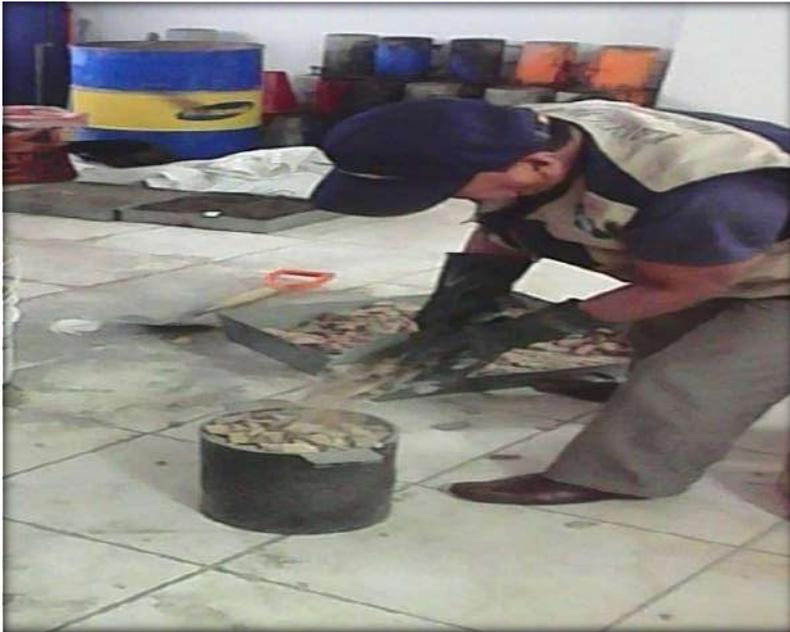
Figura 15. Peso unitario del agregado grueso
