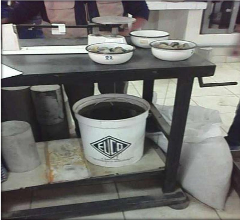
Figura 19. Peso del agregado grueso
