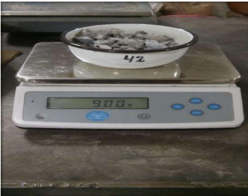
Figura 12. Realizando el pesado de la muestra para llevar al horno
