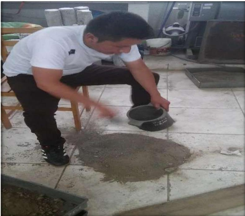
Figura 16. Peso unitario del agregado fino
