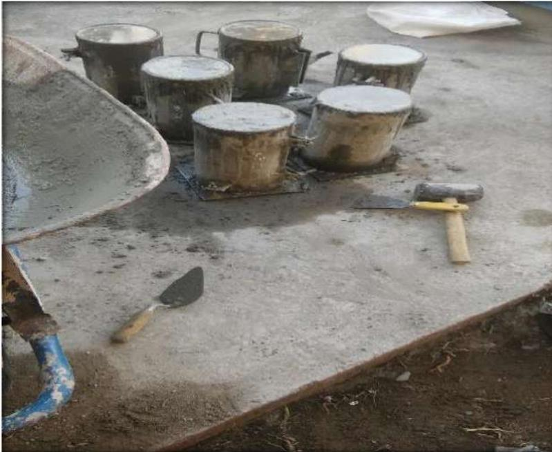
Figura 25. Probetas ya vaciadas
