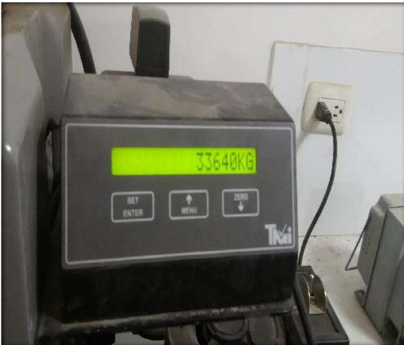
Figura 28. Resultado de la resistencia a compresión
