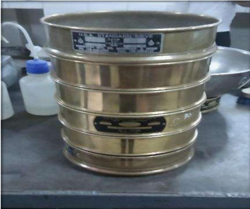
Figura 9. Tamices seleccionados para la granulometría
