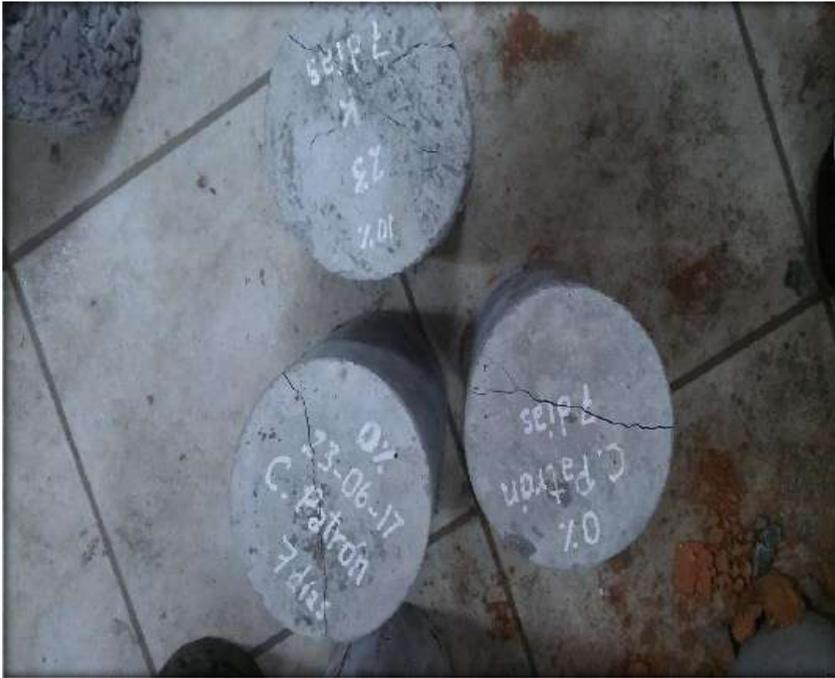
Figura 29. Probetas fracturadas por compresión
