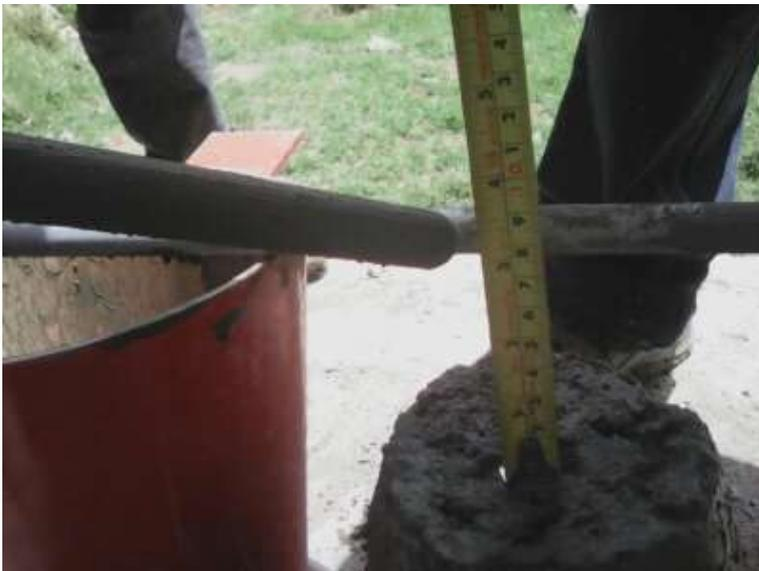
Figura 29. : Realizando la mezcla tanto patrón y con PEAD en los diferentes porcentajes y observando la imagen se realizó el SLUMP.
