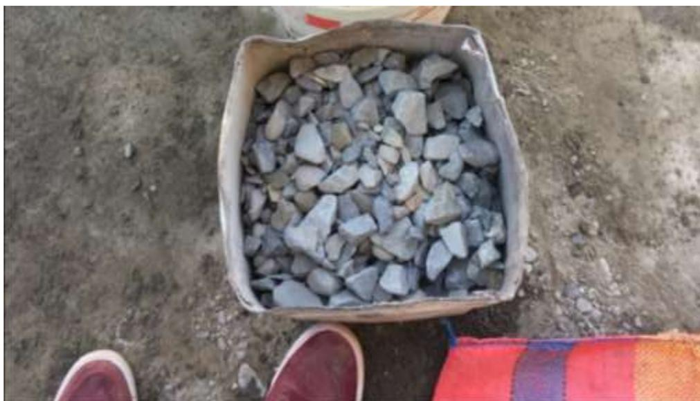
Figura 23. Agregado grueso a su posterior pesado para la dosificación correspondiente.
