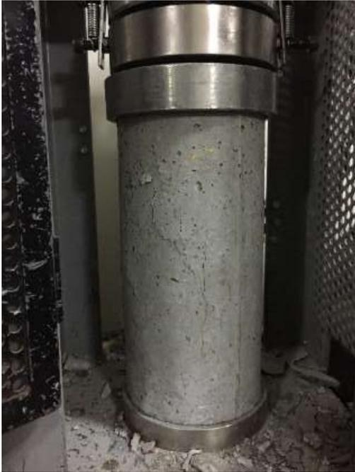
Figura 44. Posterior a la ruptura del probeta 7 días visualización de la presión de maquina ejercida.
