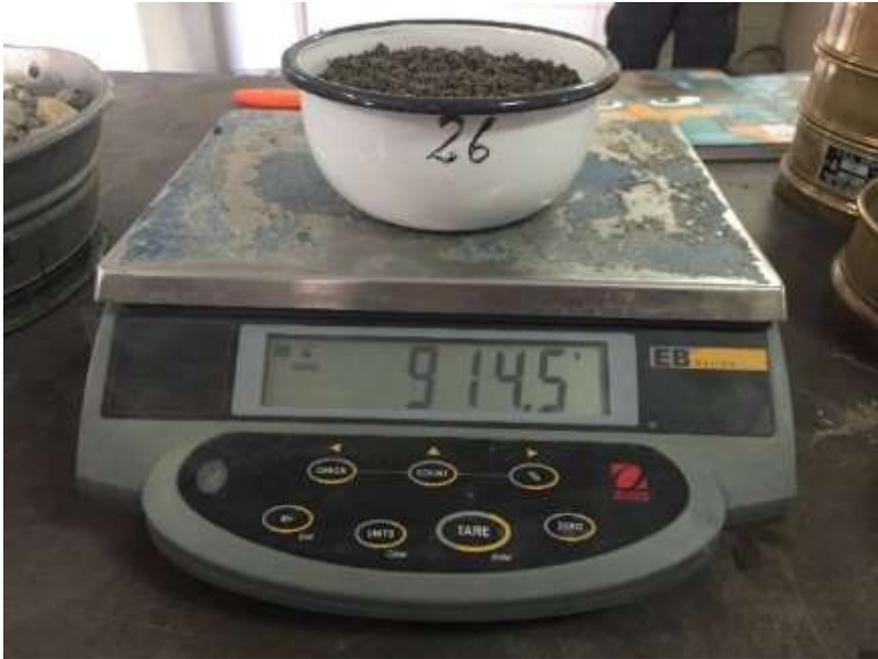
Figura 16. Peso agregado fino, tazón N°.26 = 914.5g. para el contenido de humedad.
