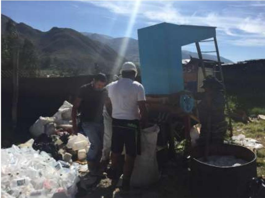
Figura 6. PEAD envase de suero se hace un retiro de etiqueta luego lavado posterior triturado en partículas.
