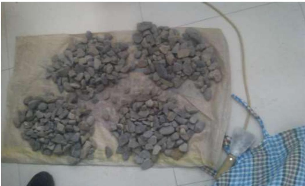
Figura 21. Agregado grueso cuarteado para la granulometría.
