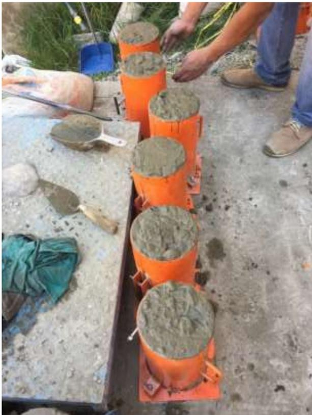
Figura 31. Posteriormente al llenado de la mezcla se procede al varillado.
