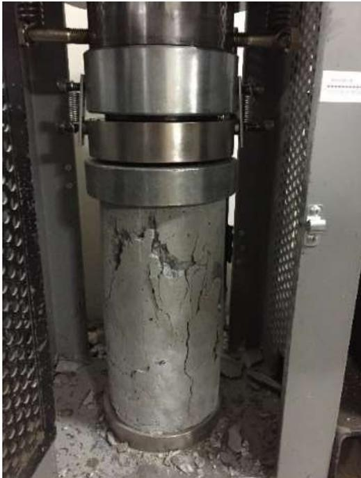
Figura 39. Posterior a la ruptura del probeta patrón visualización de la presión de maquina ejercida.
