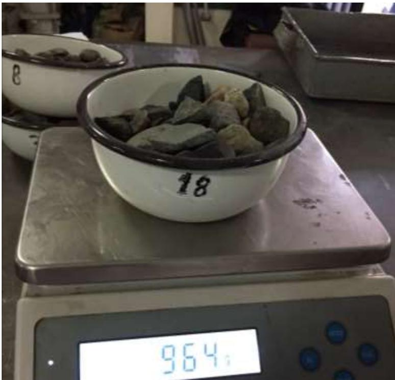
Figura 15. Peso agregado grueso, tazón N°.18 = 964g. para el contenido de humedad.
