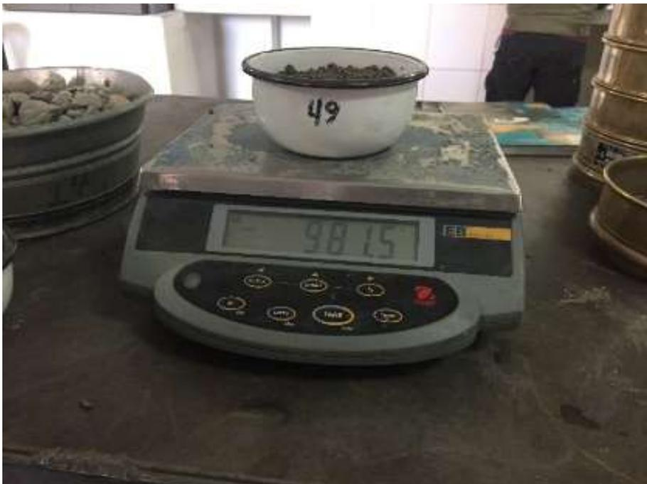
Figura 17. Peso agregado fino, tazón N°.49 = 981.5g. para el contenido de humedad.
