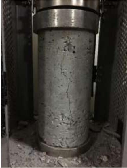
Figura 42. Posterior a la ruptura del probeta 7 días visualización de la presión de maquina ejercida.
