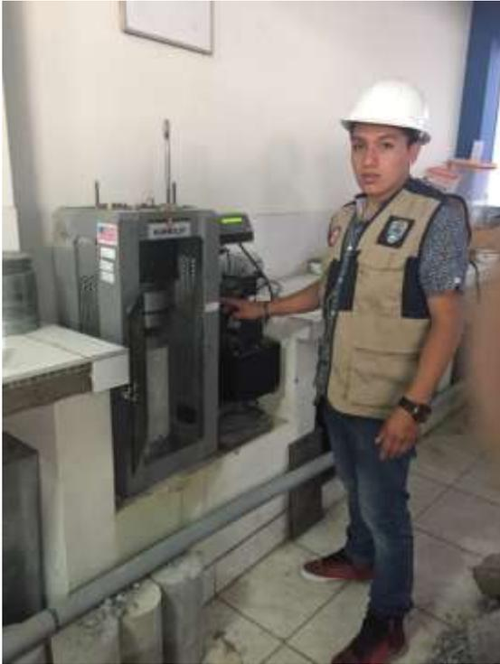
Figura 36. Las probetas a los 7, 14 y 28 días después de pasar la máquina compresión para una resistencia 210 KG/CM2.
