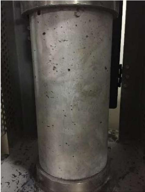
Figura 48. Posterior a la ruptura del probeta patrón 14 días visualización de la presión de maquina ejercida.
