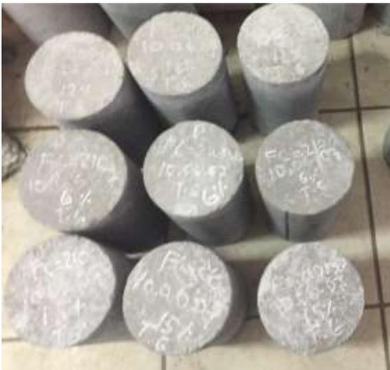
Figura 35. Posterior al curado secado al aire libre, 12 testigos 3 de cada uno para rotura a los 28 días.
