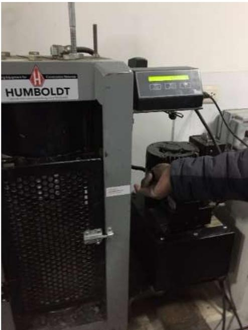
Figura 45. Posterior a la ruptura del probeta 7 días visualización de la presión de maquina ejercida.
