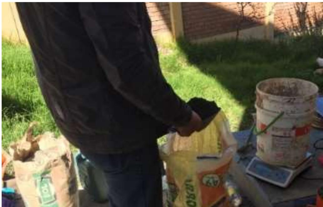
Figura 22. Peso de los agregados fino para la dosificación correspondiente.
