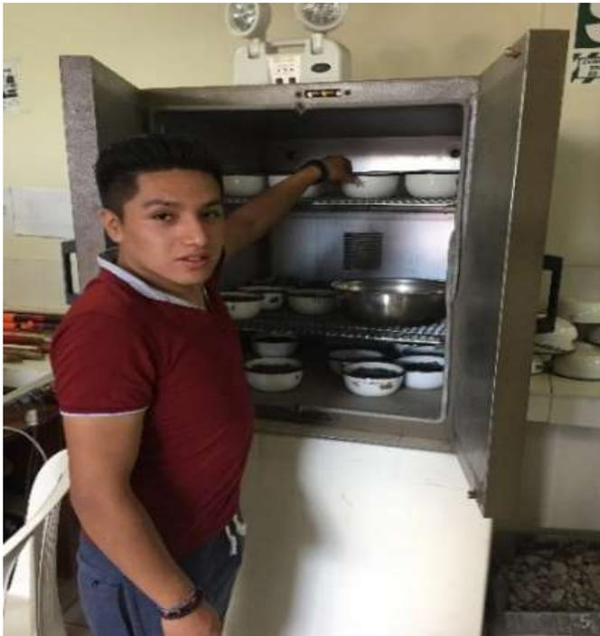
Figura 19. Muestra de agregado fino tazón N°.26, N°.49 y Agregado grueso tazón N°.16, N°.18 retiro del horno después de 24 horas para su posterior peso.
