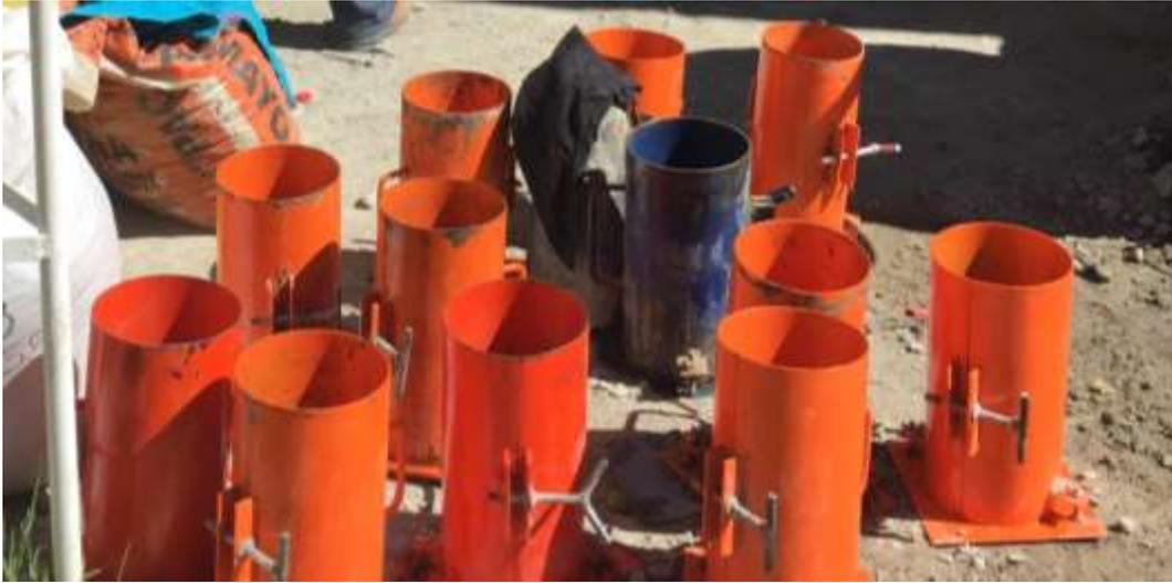
Figura 26. Pasando las probetas con gasolina para que no se pegue la mezcla.
