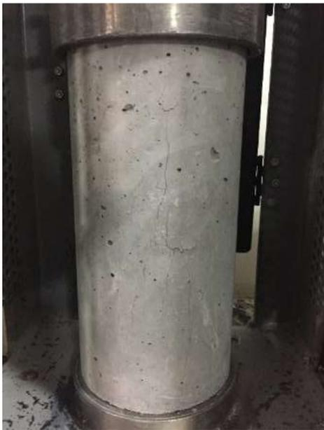
Figura 47. Posterior a la ruptura del probeta patrón 14 días visualización de la presión de maquina ejercida.
