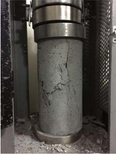
Figura 40. Posterior a la ruptura del probeta 7 días visualización de la presión de maquina ejercida.
