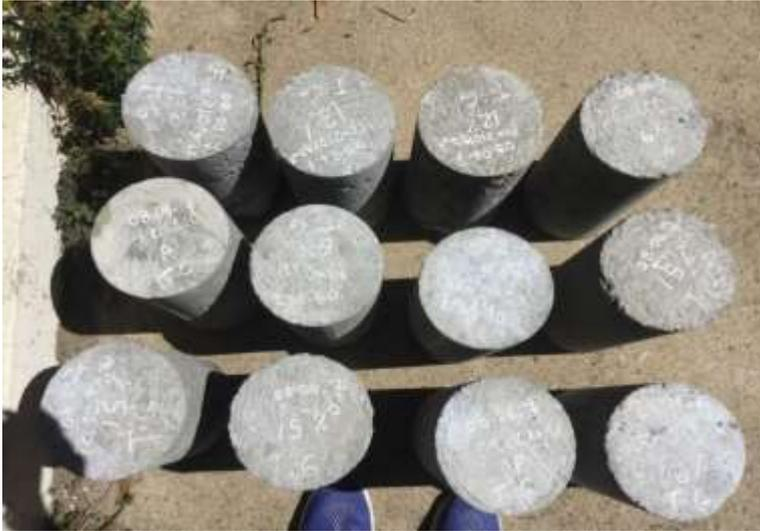
Figura 34. Posterior al curado secado al aire libre, 12 testigos 3 de cada uno para rotura a los 14 días.
