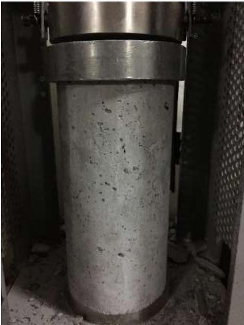
Figura 43. Posterior a la ruptura del probeta 7 días visualización de la presión de maquina ejercida.
