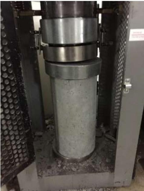
Figura 41. Posterior a la ruptura del probeta 7 días visualización de la presión de maquina ejercida.
