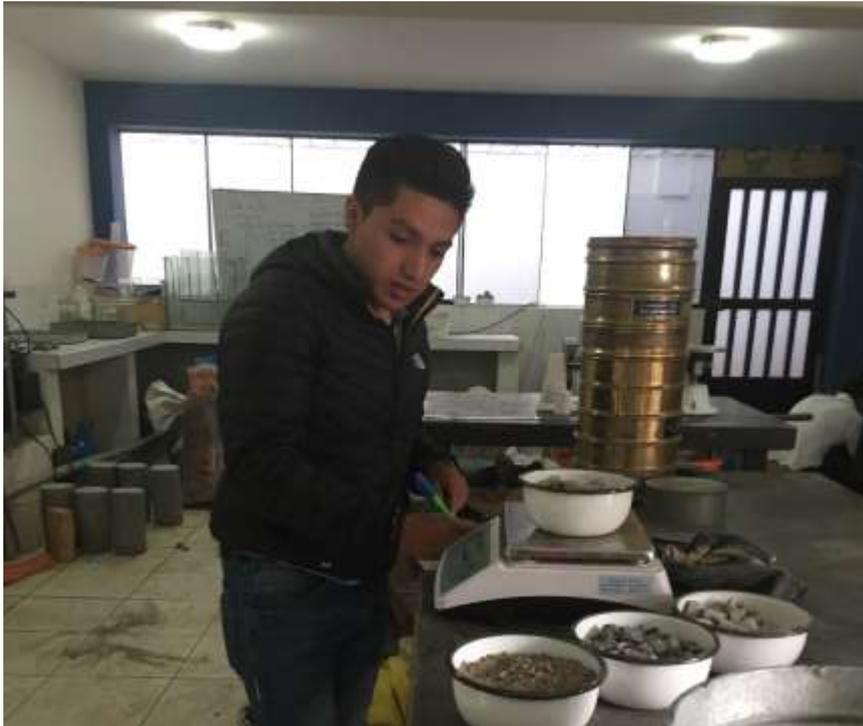
Figura 20. Toma de datos en hoja contenido de humedad agregado fino seco tazón N°.26, N°.49 y Agregado grueso seco tazón N°.16, N°.18.
