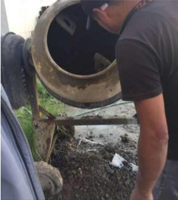
Figura 28. Realizando la mezcla tanto patrón y con PEAD en los diferentes porcentajes.
