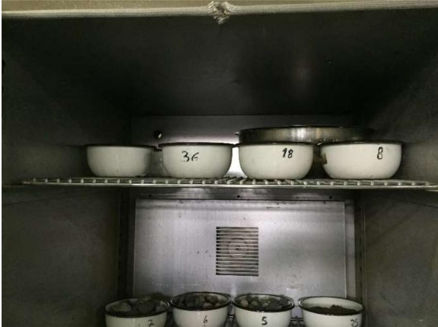
Figura 18. Muestra de agregado fino tazón N°.26, N°.49 y Agregado grueso tazón N°.16, N°.18 puesta en horno para su secado durante 24 horas.
