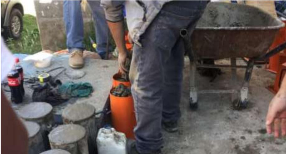
Figura 30. Posteriormente se llena la mezcla a las probetas que correspondan a los porcentajes de PEAD.
