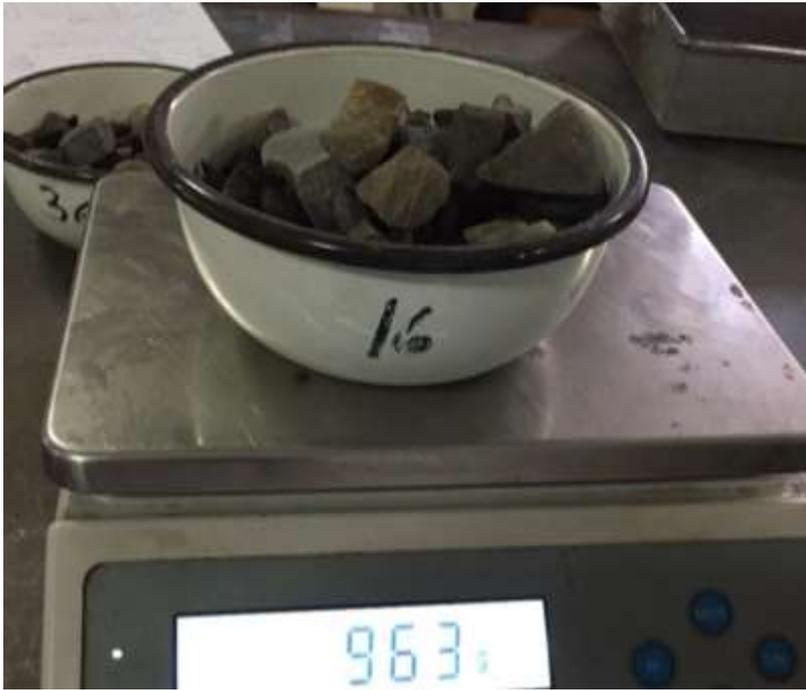
Figura 14. Peso agregado grueso, tazón N°.16 = 963g. para el contenido de humedad.
