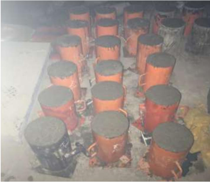
Figura 32. Probetas culminadas tanto patrón y los porcentajes de PEAD 6%, 12% y 15%.
