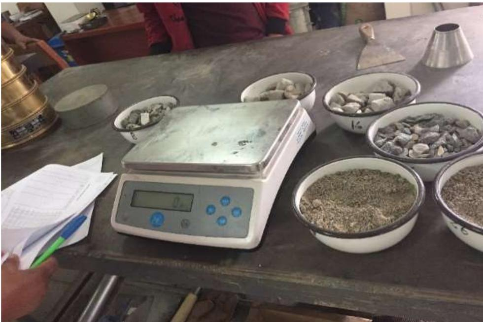
Figura 13. Muestra de Agregado Fino y Agregado Grueso para el contenido de humedad.
