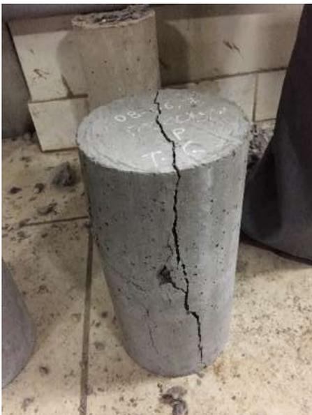
Figura 37. Posterior a la ruptura del probeta patrón visualización de la presión de maquina ejercida.
