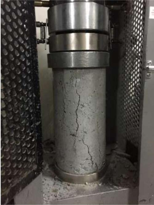
Figura 38. Posterior a la ruptura del probeta patrón visualización de la presión de maquina ejercida.
