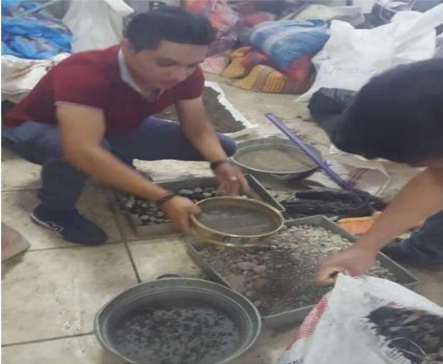
Figura 12. Muestra de los agregados en el laboratorio posteriormente se iniciara a sus estudios correspondientes.
