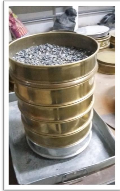
Figura 10: Proceso de tamizado de agregado fino FUENTE: Elaboración propia
