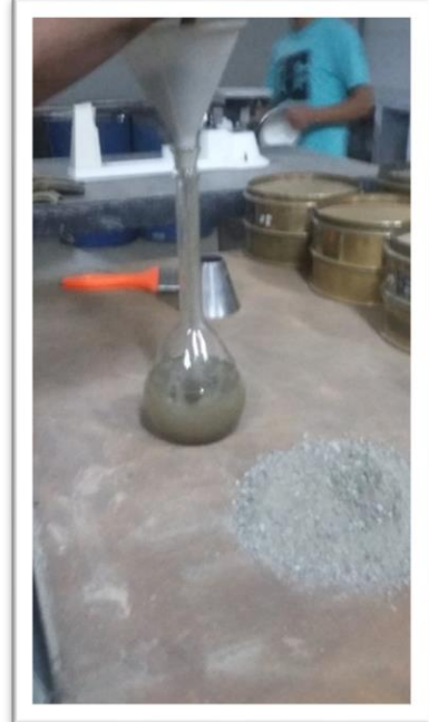
Figura 14: Ensayo de Gravedad específica y absorción de Agregado fino FUENTE: Elaboración propia
