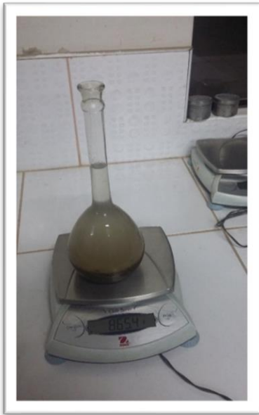
Figura 7: Peso de la muestra para el ensayo de Gravedad específica y absorción de Agregado fino
