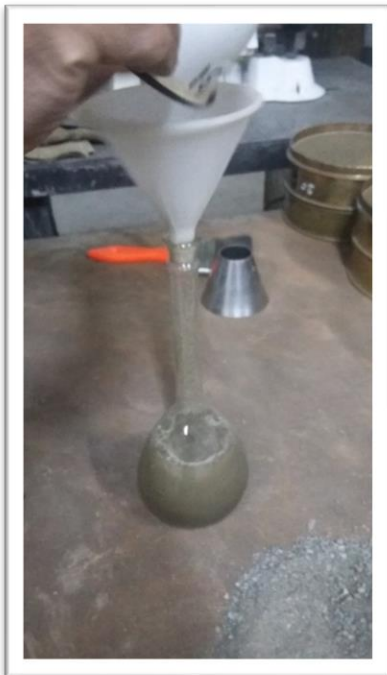
Figura 15: Ensayo de Gravedad específica y absorción de Agregado Fino FUENTE: Elaboración propia
