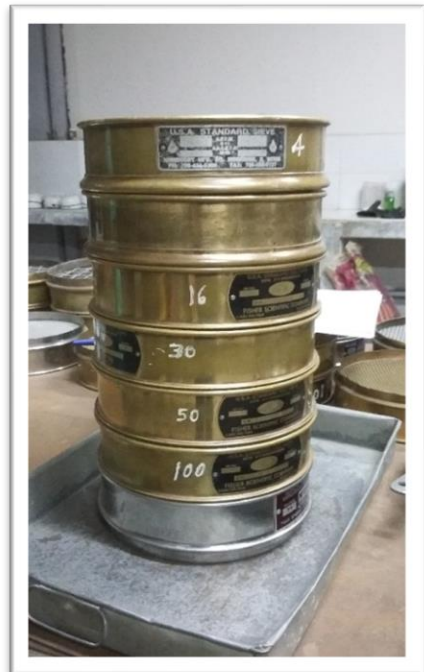
Figura 12: Proceso de tamizado de agregado fino FUENTE: Elaboración propia
