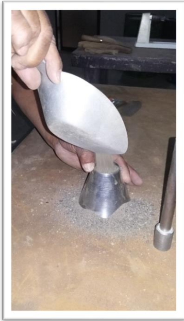
Figura 17: ensayo para verificar que el Agregado fino Se encuentre 100% seco FUENTE: Elaboración propia
