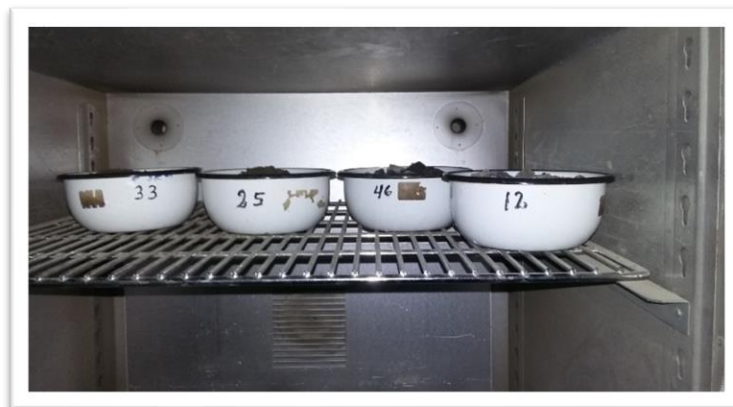
Figura 38: Secado en el horno de materiales para el peso específico FUENTE: Elaboración propia
