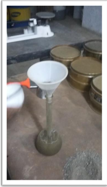
Figura 13: Ensayo de Gravedad específica y absorción de Agregado Fino FUENTE: Elaboración propia
