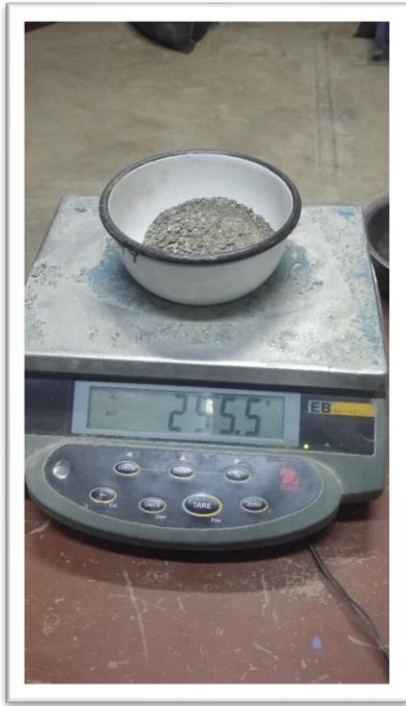
Figura 33: Peso del contenido que pasa para el Ensayo de análisis granulométrico FUENTE: Elaboración propia
