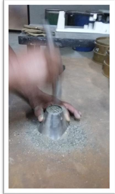
Figura 22: Ensayo para verificar que el agregado Fino se encuentre 100% seco FUENTE: Elaboración propia
