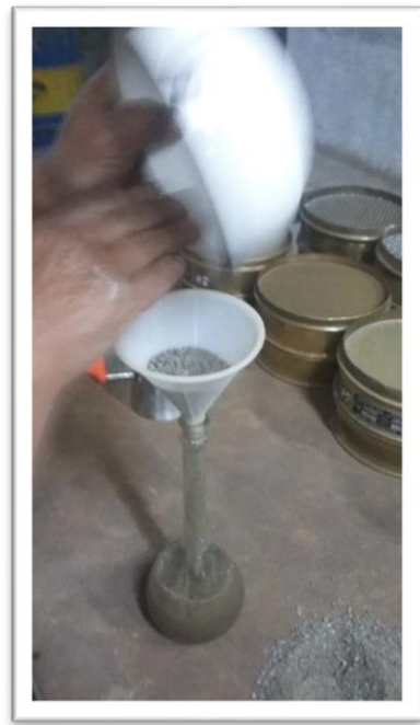
Figura 16: Ensayo de Gravedad específica y absorción de Agregado fino FUENTE: Elaboración propia
