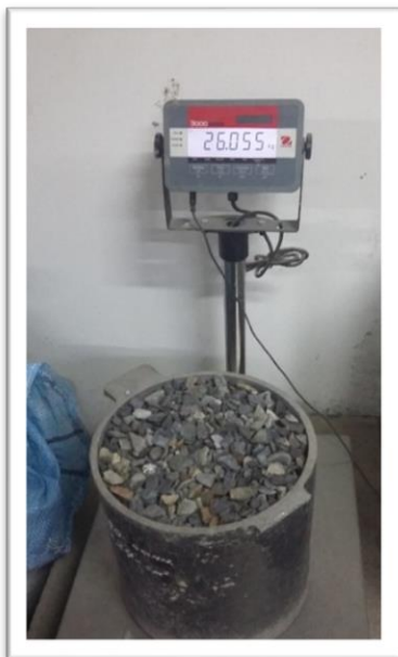
Figura 19: Peso del material compactado Peso Unitario FUENTE: Elaboración propia
