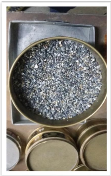
Figura 11: Proceso de tamizado de agregado fino FUENTE: Elaboración propia
