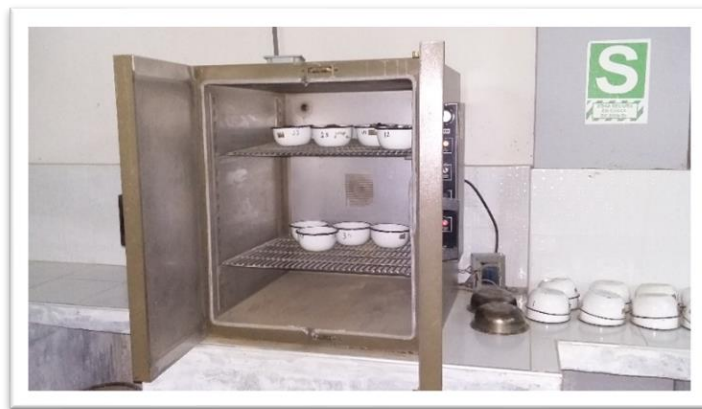
Figura 35: Horno en el cual se secara las muestras de materiales Húmedos para el análisis de contenido de humedad FUENTE: Elaboración propia
