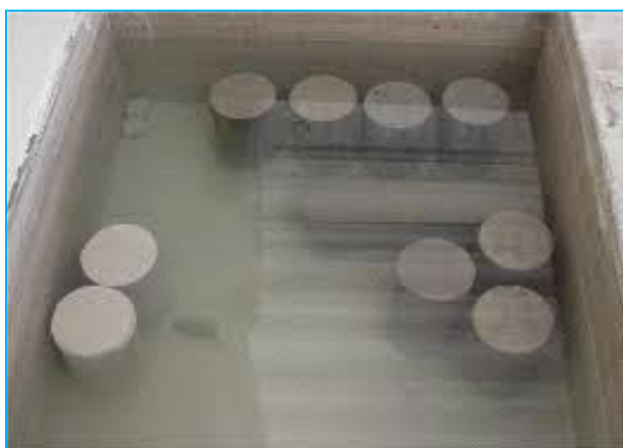
Figura N° 1 Curado del concreto
