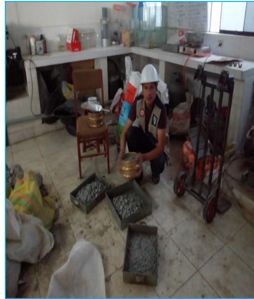
Figura 27 tamizando agregado fino y grueso.
