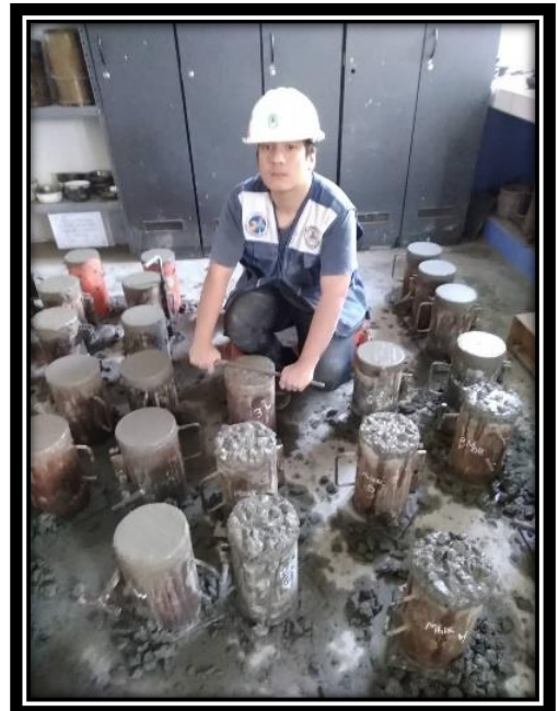
Figura 25. Vaciado del concreto en las probetas
