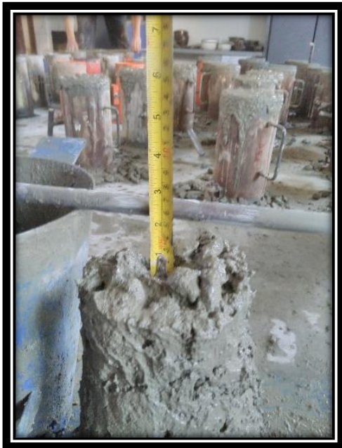
Figura 24. Asentamiento de 2.8" del concreto con agregado reciclado
