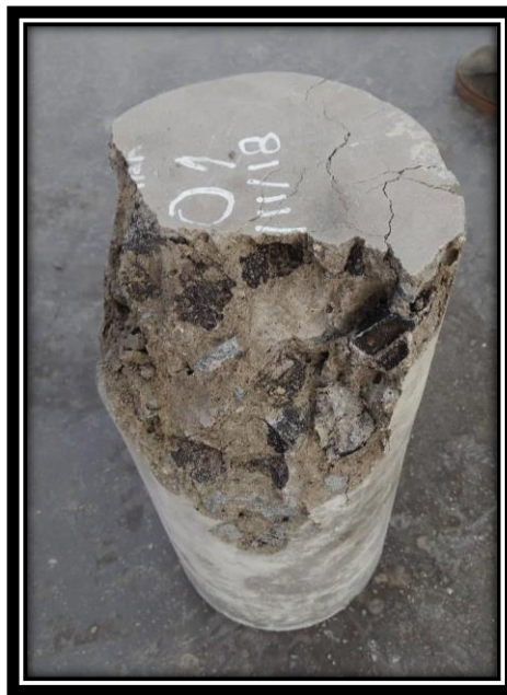
Figura 28. Rotura de una de las probetas de concreto experimental
