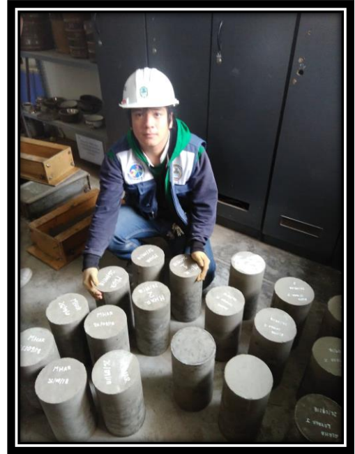
Figura 27. Desencofrado de probetas
