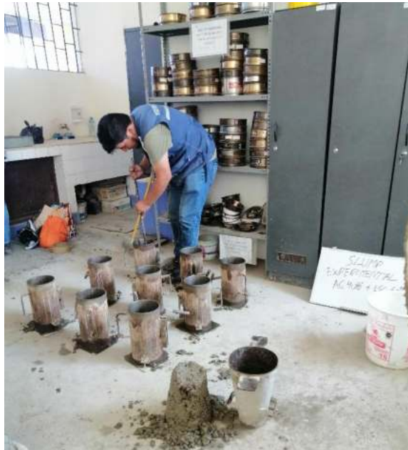
Figura N° 20: Llenado de probetas de concreto fresco.
