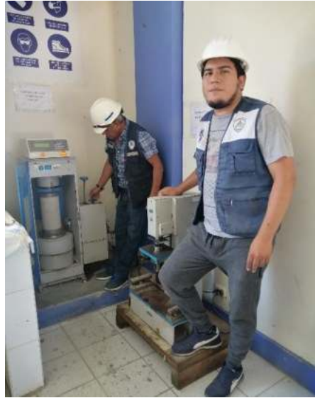
Figura N° 29: Ensayo de Resistencia a la Compresión del concreto.
