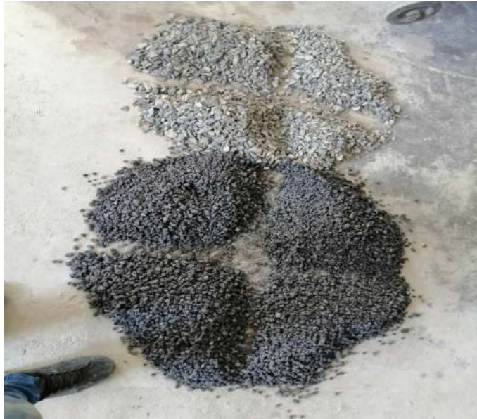
Figura N° 25: Cuarteo y mezcla del agregado grueso y escoria.
