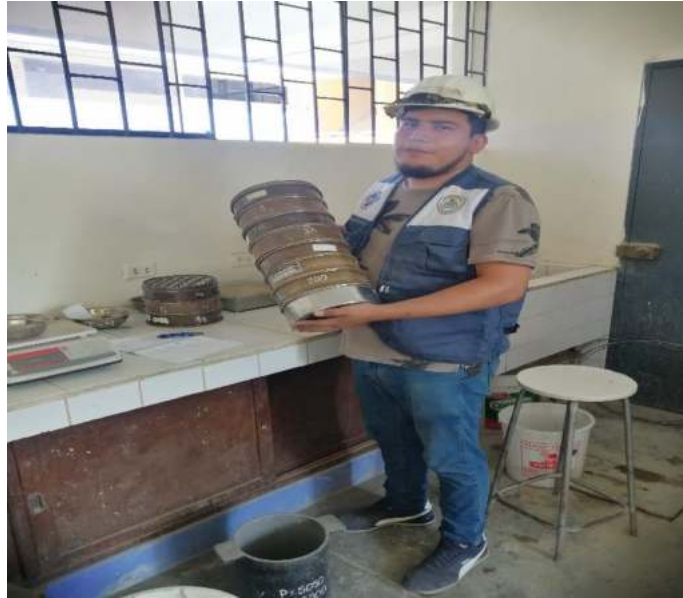
Figura N° 15: Tamizado para granulometría de los agregados.
