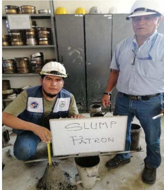
Figura N° 19: Realización ensayo de slump patrón.
