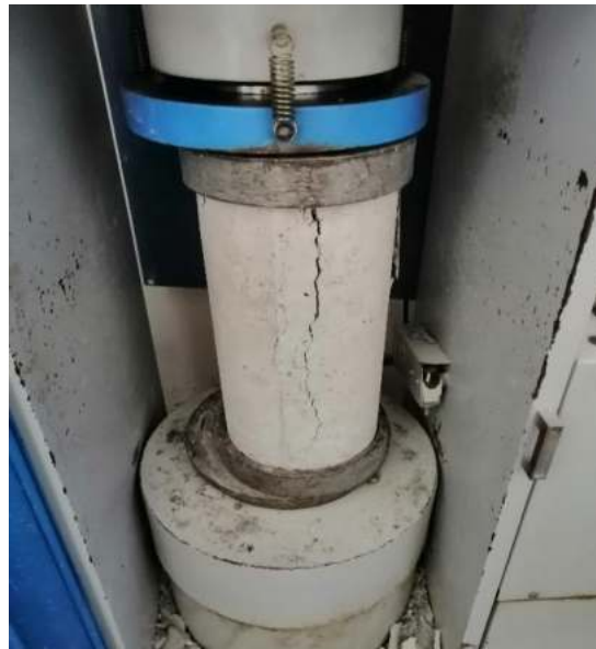
Figura N° 30: Falla de una probeta de concreto.
