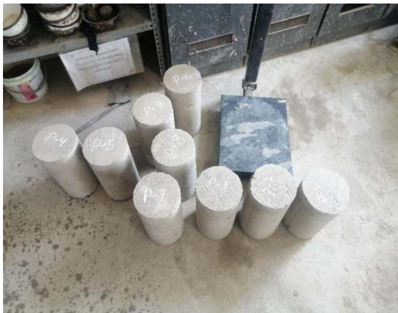
Figura N° 22: Probetas patrón desencofradas listas para el curado.
