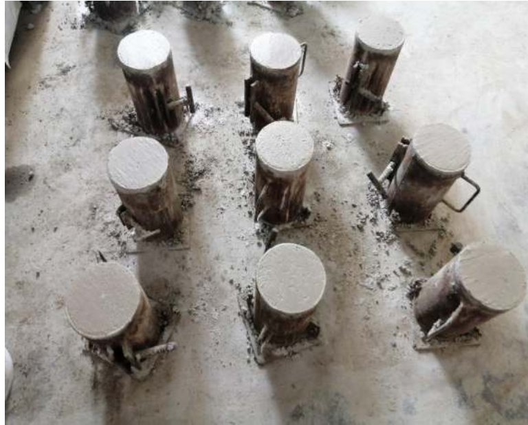
Figura N° 21: Probetas de concreto listas para el desencofrado
