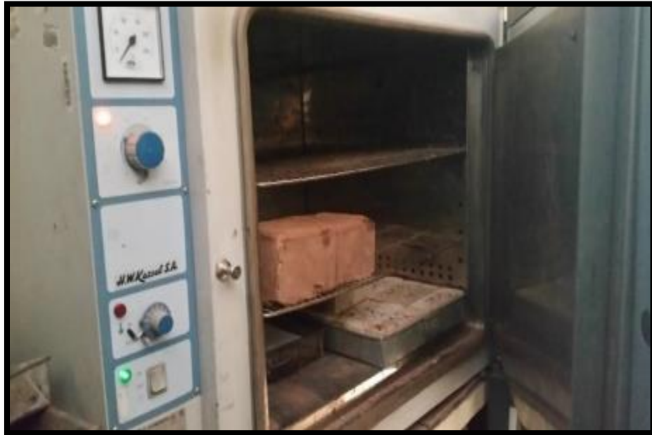
Figura 63. Secado del adobe en horno a 110°C.
