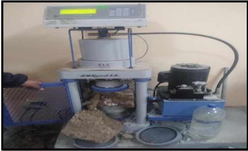
Figura 75. Rotura de adobe.
