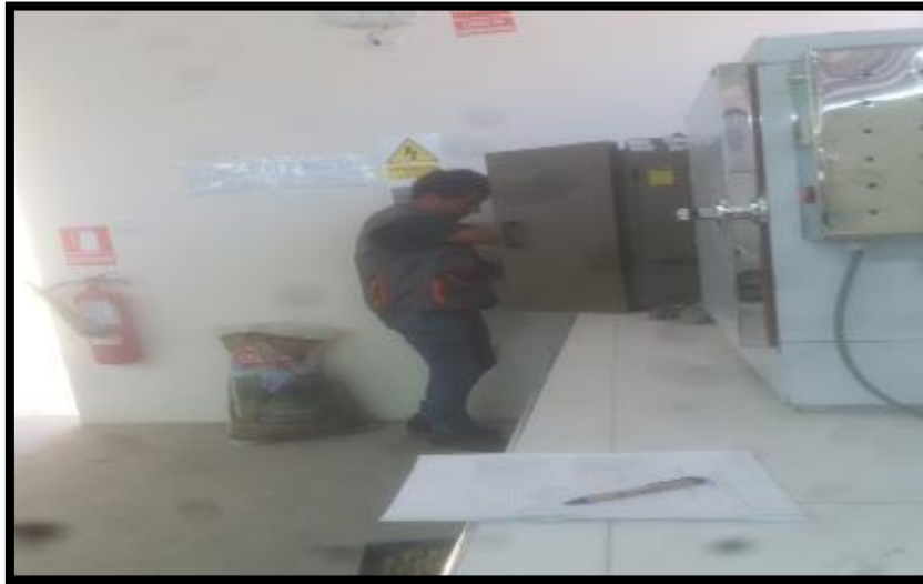
Figura 57. Tesista ingresando material para el secado en horno a 110°C del suelo lavado.
