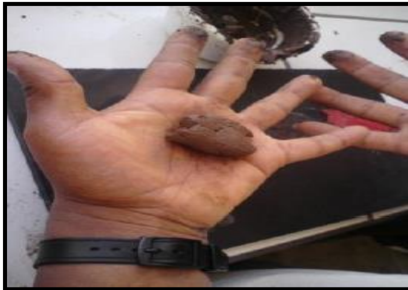
Figura 52. Amasado del suelo para límite plástico.
