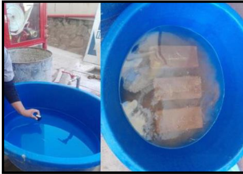
Figura 65. Adobe sumergido en agua.
