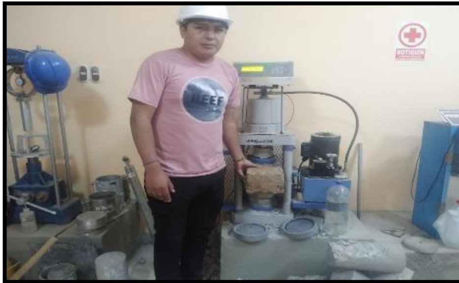
Figura 74. Tesista desarrollando el ensayo a compresión del adobe.
