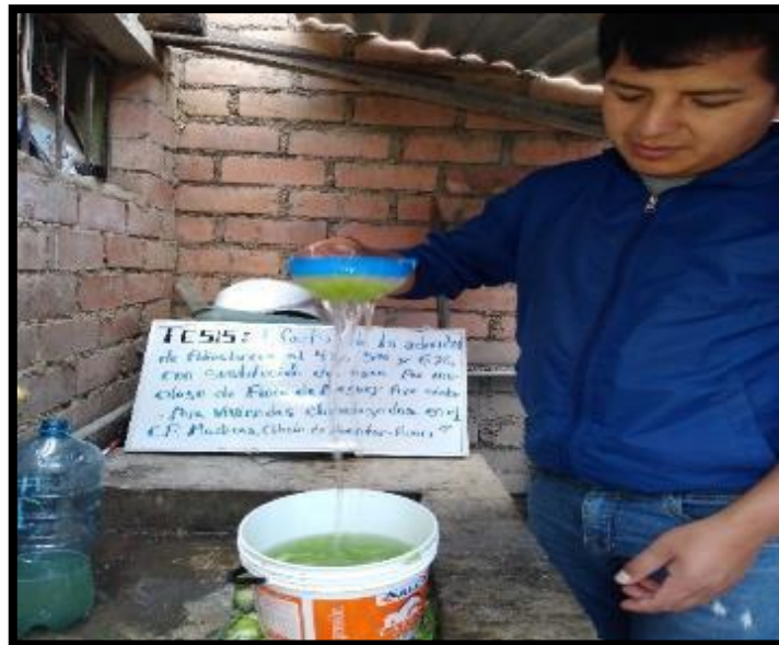
Figura 26. Tesista colando el mucílago para la obtención del mucílago de penca.
