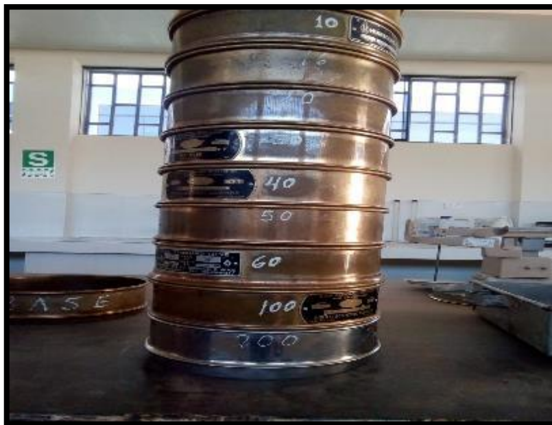
Figura 58. Tamizado del suelo seco.
