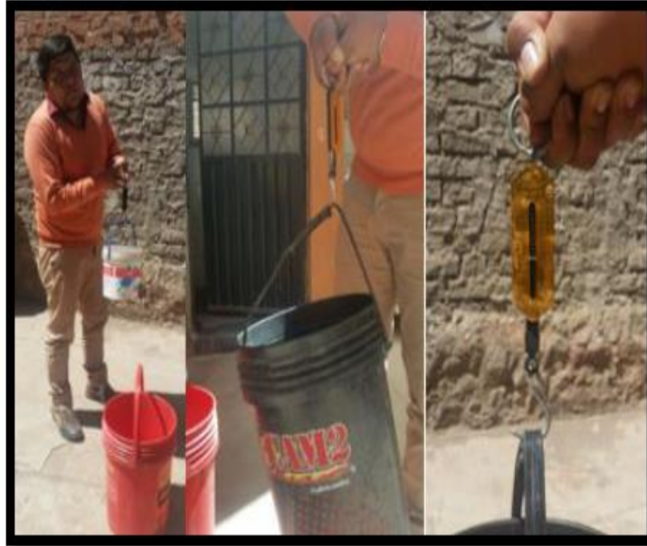
Figura 23. Pesado del agua y de las pencas cortadas para la proporción de 1/1.
