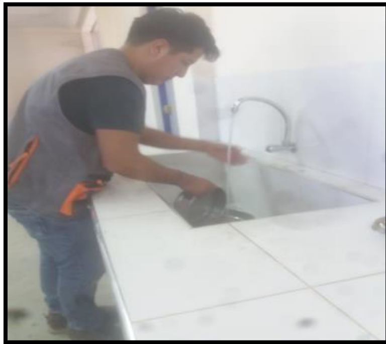
Figura 56. Tesista en el lavado del material para el análisis granulométrico.
