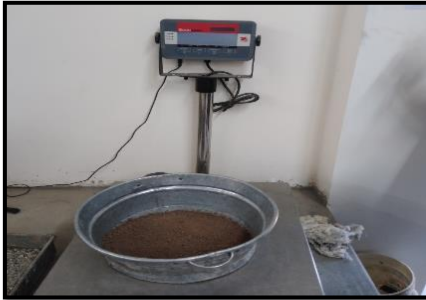
Figura 55. Peso del suelo seco seleccionado.
