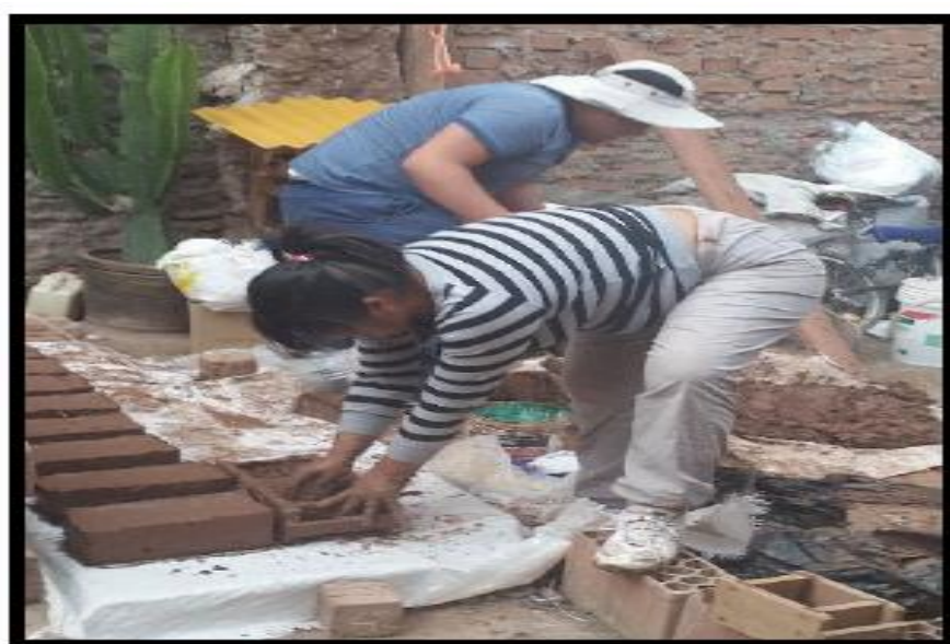
Figura 40. Elaboración previa de los adobes para la prueba de rajadura.
