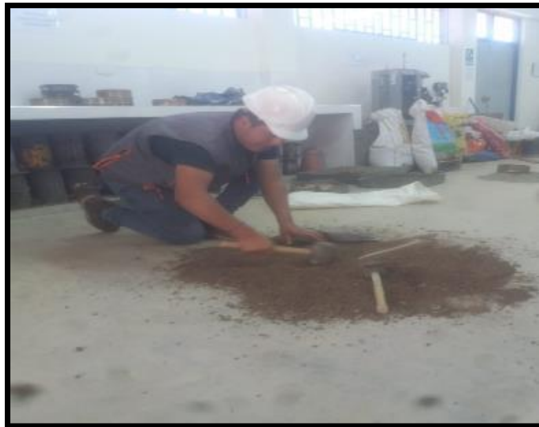
Figura 46. Tesista Destruyendo de la estructura original del suelo.
