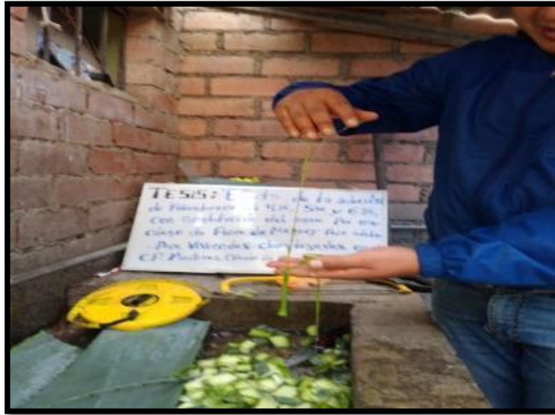
Figura 27. Tesista haciendo la verificación de la viscosidad del mucílago.
