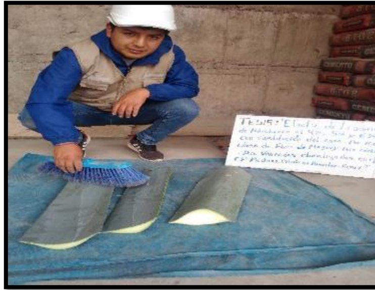
Figura 19. Eliminación de espinas y lavado de penca. Fuente: Elaboración propia.
