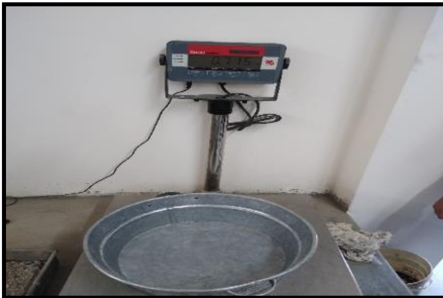
Figura 42. Peso de la capsula de aluminio vacío.
