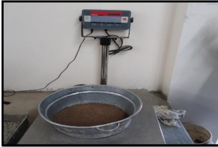
Figura 45. Peso del suelo seco más el peso del recipiente.
