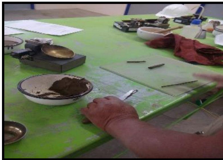
Figura 54. Desarrollando el límite plástico del suelo.
