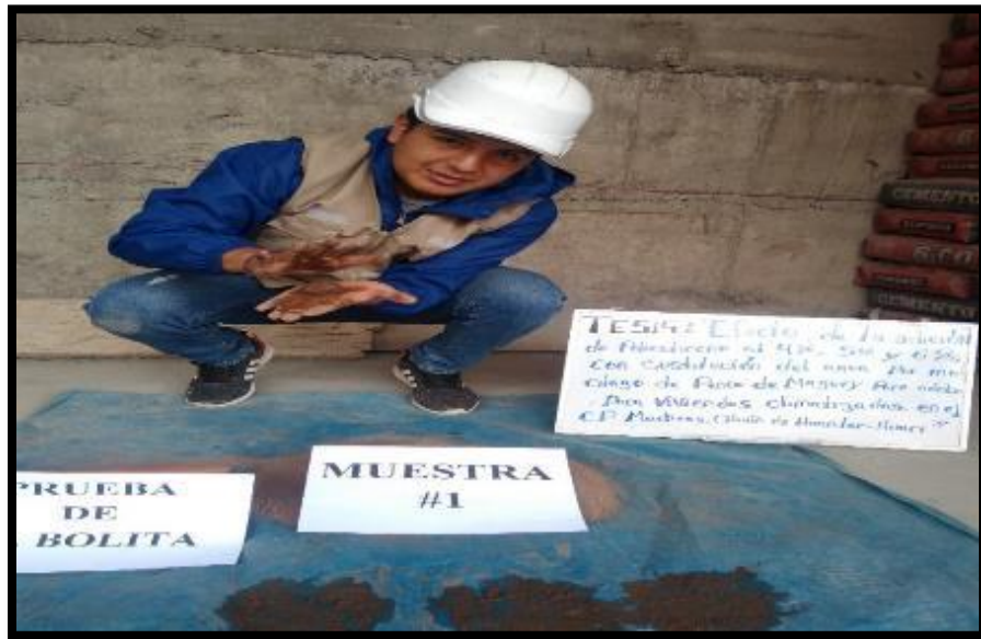
Figura 38. Tesista desarrollando la prueba de la resistencia de la bolita del suelo.
