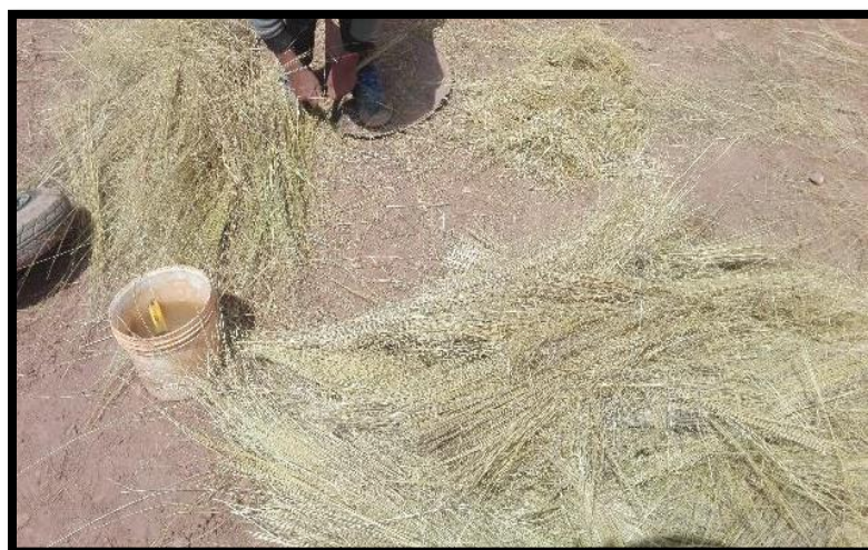
Figura 68. Tesista cortando la paja para la elaboración del adobe.
