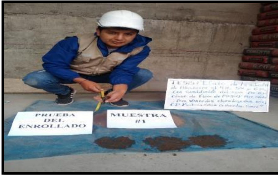
Figura 37. Tesista desarrollando la prueba del enrollado en campo del suelo.
