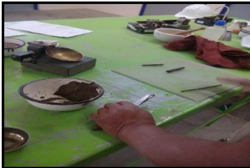
Figura 50. Mezclado del suelo con agua.
