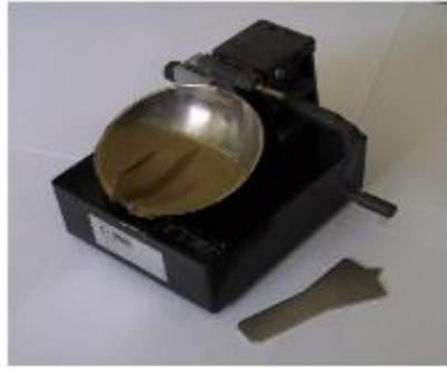
Figura 1.6. Cuchara de Casagrande para determinación del límite líquido.
