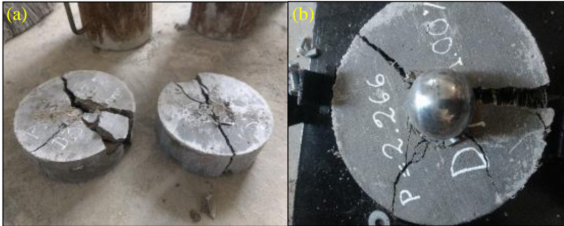
Figura 81: (a) Falla frágil de un espécimen sin fibras, (b) Falla dúctil debido a las fibras de refuerzo, a impacto.
