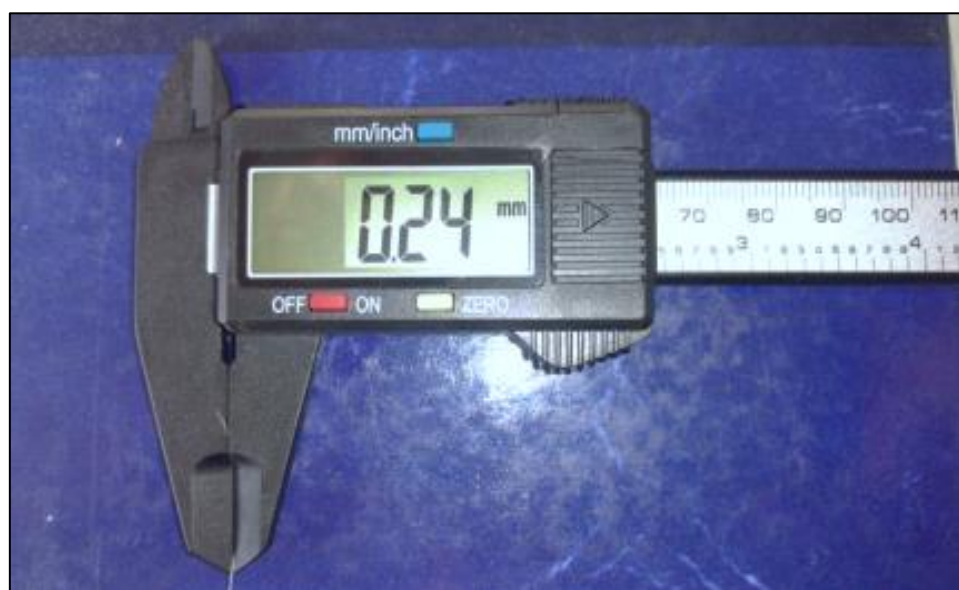
Figura 46: Tomando datos del diámetro de la fibra de furcraea andina .
