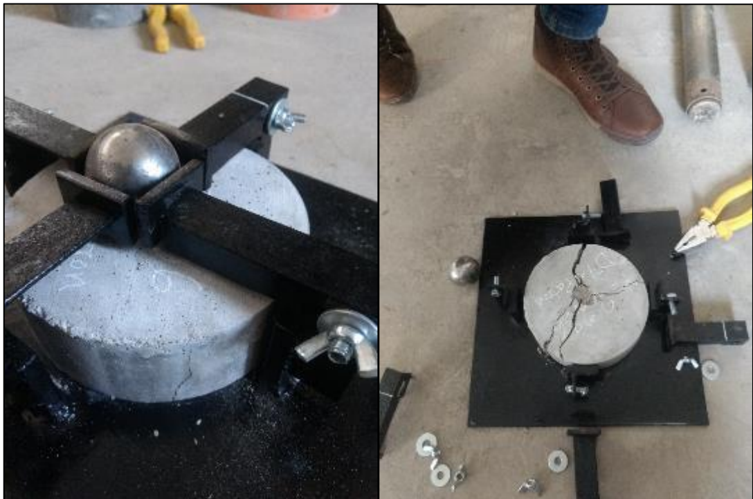
Figura 80: Ensayo de resistencia al impacto a la primera fisura y a la rotura. Fuente: El autor, 2020.
