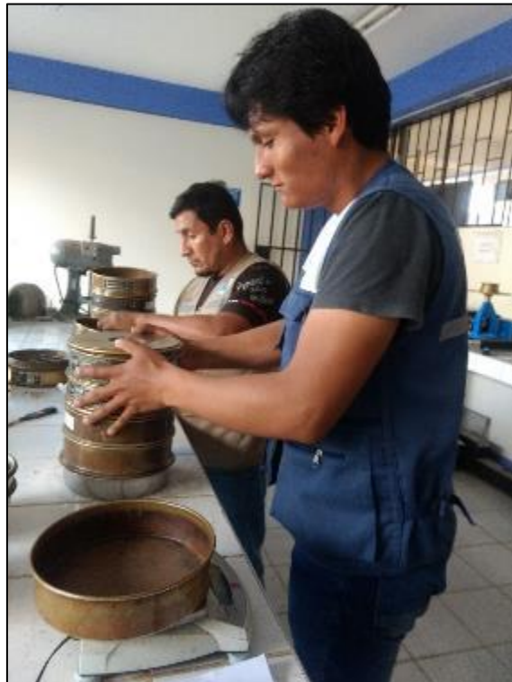
Figura 48: Análisis granulométrico (tamizado). Fuente: El autor, 2020.
