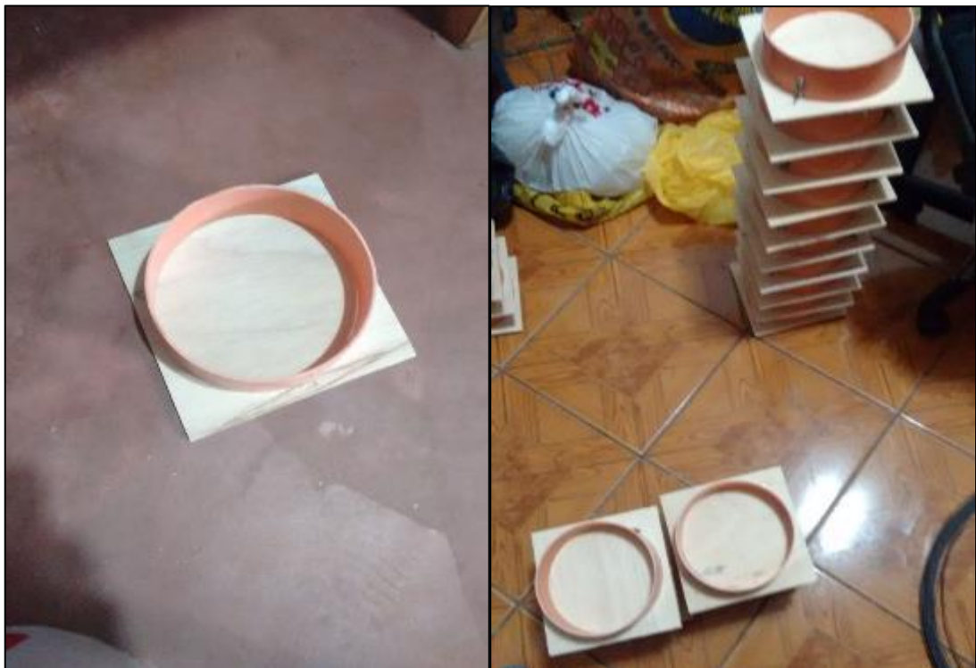
Figura 58: Moldes fabricados de tubos de PVC de 6 pulg. de diámetro, fijado y asegurados con tornillos y alambres de acero negro N°16 sobre una superficie de triplay, para la elaboración de discos. Fuente: El autor, 2020.
