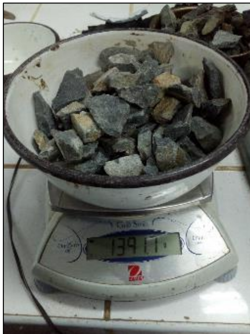
Figura 54: Peso del agregado grueso para el cálculo del peso específico.
