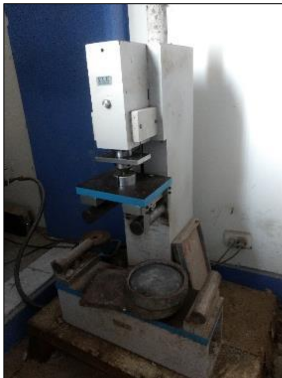
Figura 72: Máquina de ensayo a flexión de vigas de concreto. Fuente: El autor, 2020.
