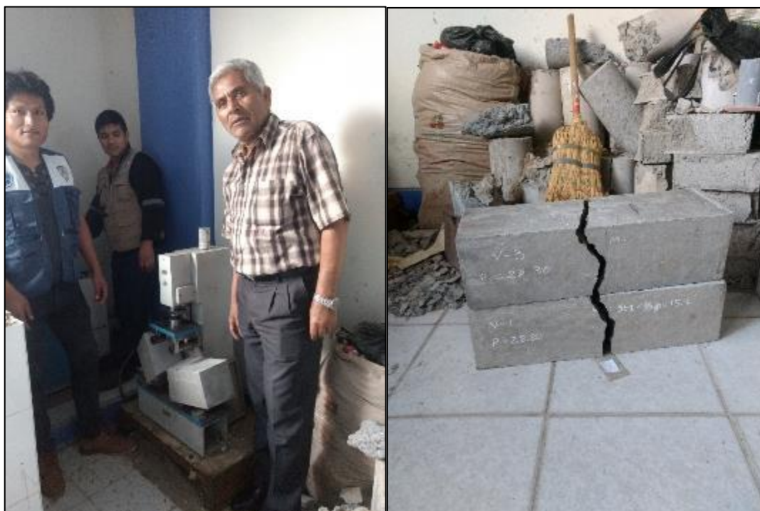
Figura 74: Ensayo de resistencia a la flexión de especímenes prismáticos de concreto. Fuente: El autor, 2020.
