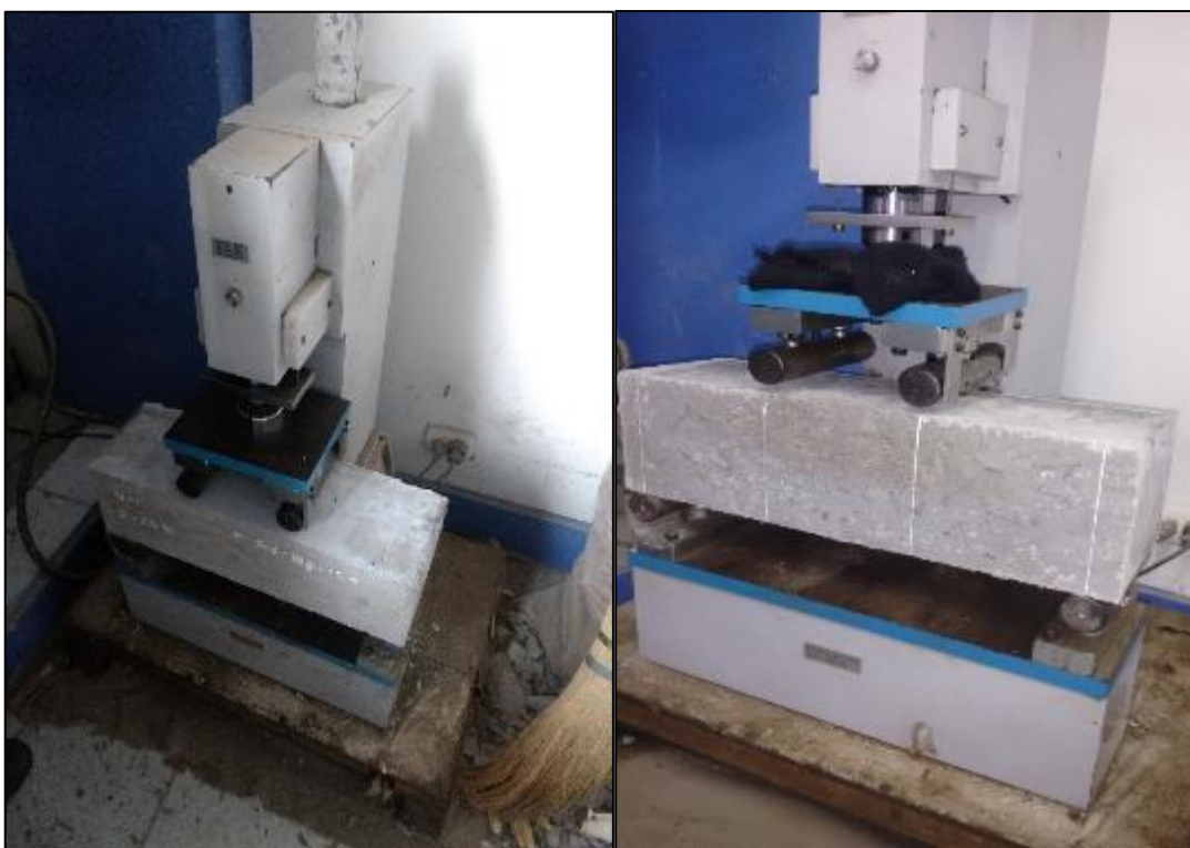
Figura 73: Colocación de los especímenes en la máquina de ensayo a flexión. Fuente: El autor, 2020.
