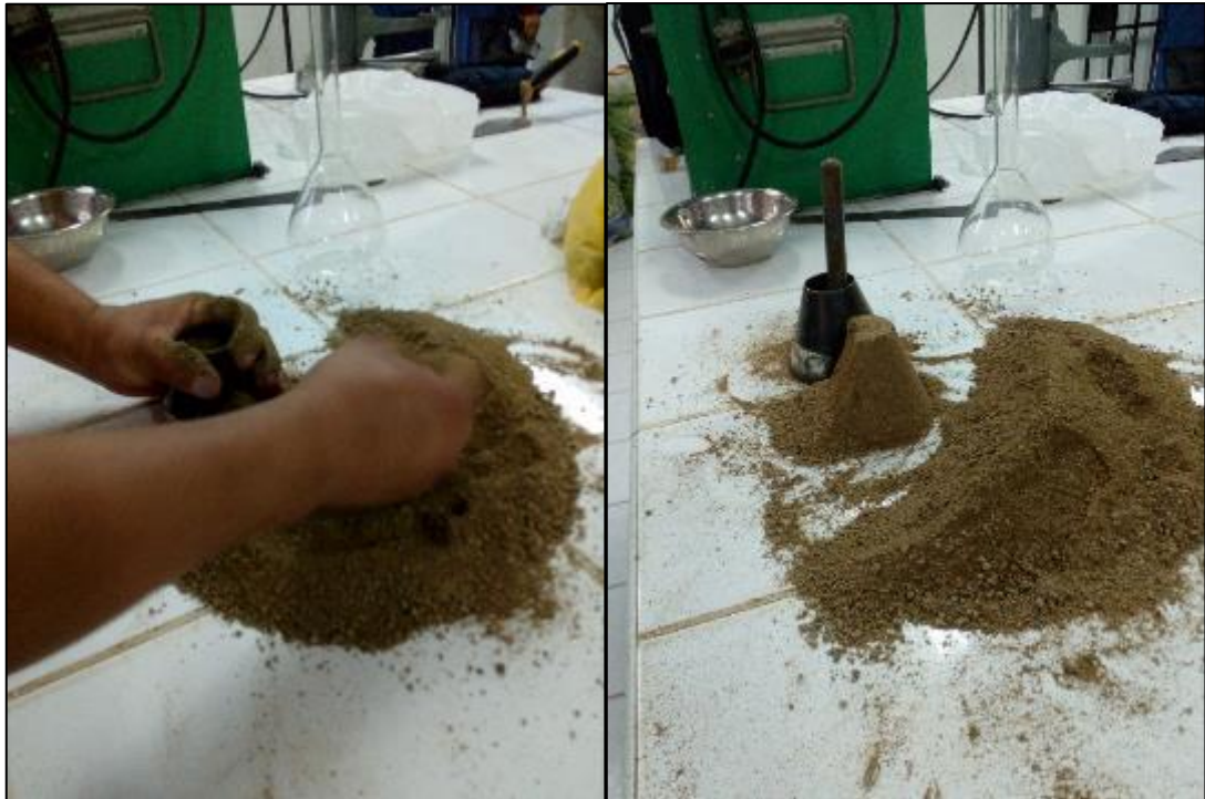
Figura 55: Colocación del agregado fino en el molde cónico de Absorción y retiro del molde en forma vertical.
