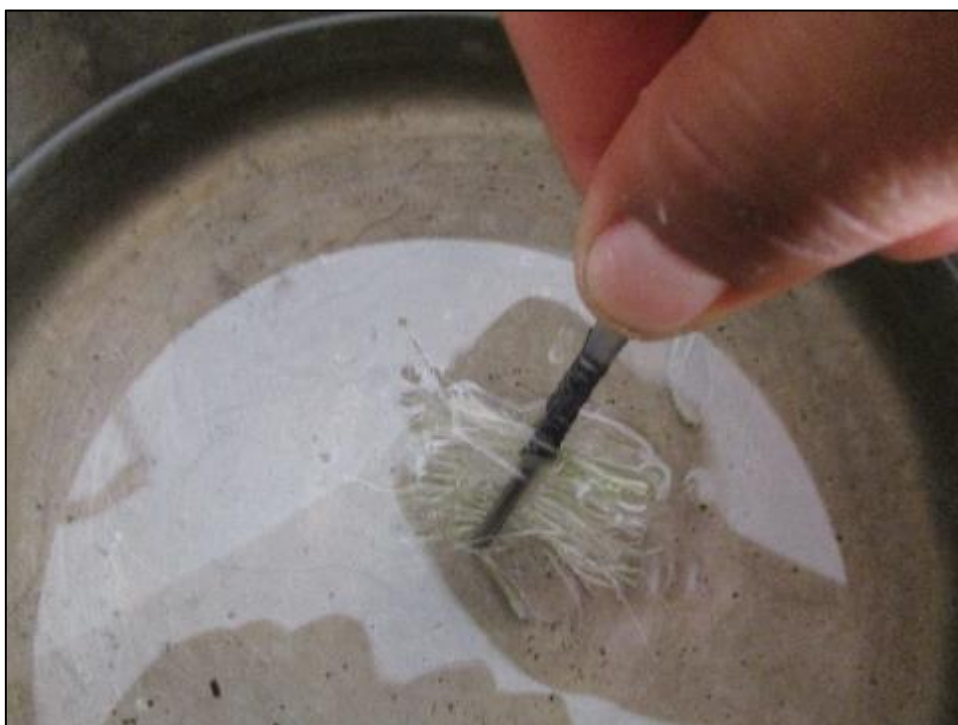
Figura 40: Tratamiento de la fibra de furcraea andina con parafina. Fuente: El autor, 2020.
