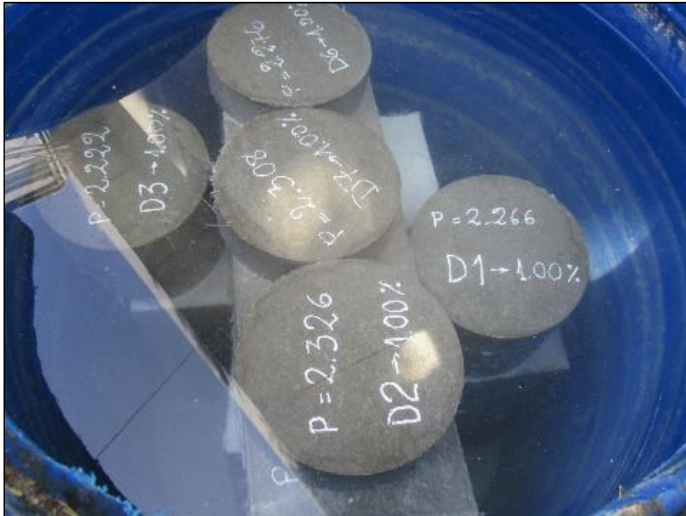
Figura 69: Curado de los especímenes de concreto en cilindros cubiertos con agua. Fuente: El autor, 2020.
