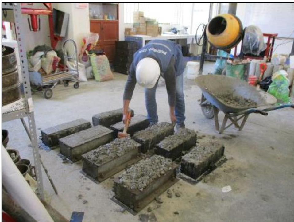
Figura 64: Golpeó de los lados del molde ligeramente por 12 veces con el mazo de goma. Fuente: El autor, 2020.
