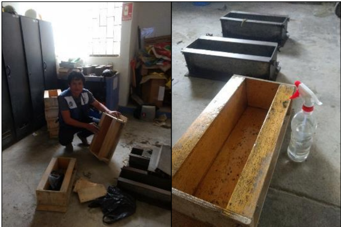
Figura 56: Limpieza y aplicación de desmoldante en los moldes de madera.
