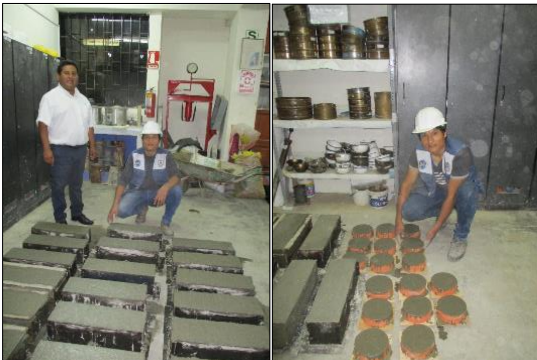
Figura 66: Identificación de los especímenes con el número, fecha y tipo de dosificación. Fuente: El autor, 2020.
