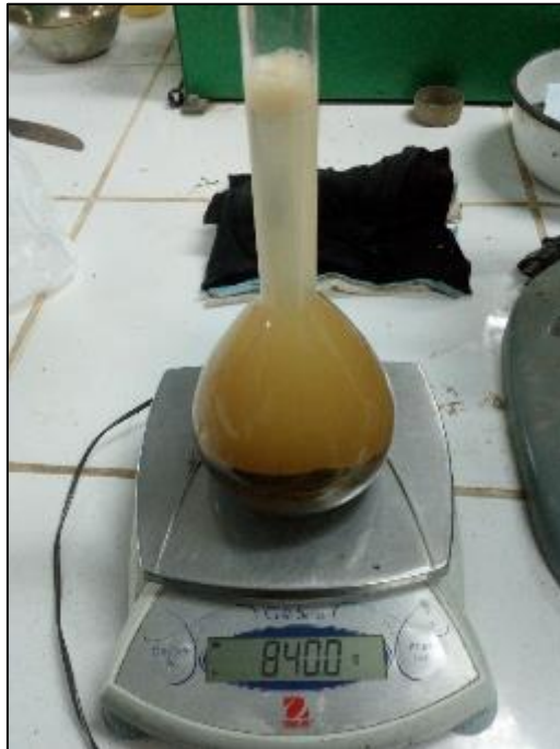
Figura 53: Peso de la fiola más el agregado fino para el cálculo del peso específico.
