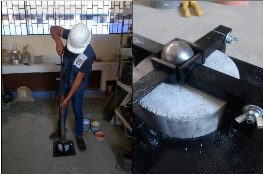
Figura 79: Se dejó caer libremente el martillo sobre la esfera de acero. Fuente: El autor, 2020.
