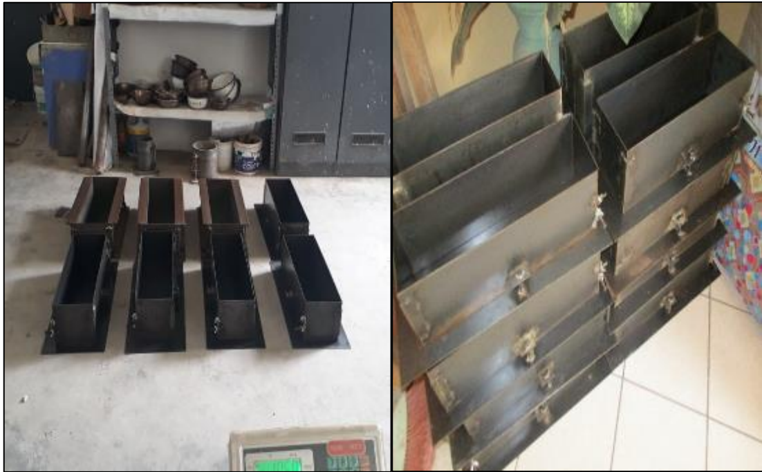
Figura 57: Limpieza y aplicación de petróleo en los moldes de acero. Fuente: El autor, 2020.
