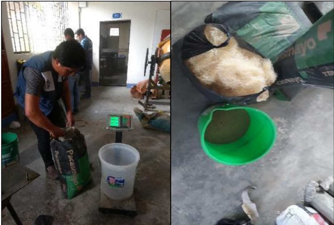
Figura 59: Peso de material necesario para elaborar 9 vigas y 9 discos para cada muestra. Fuente: El autor, 2020.
