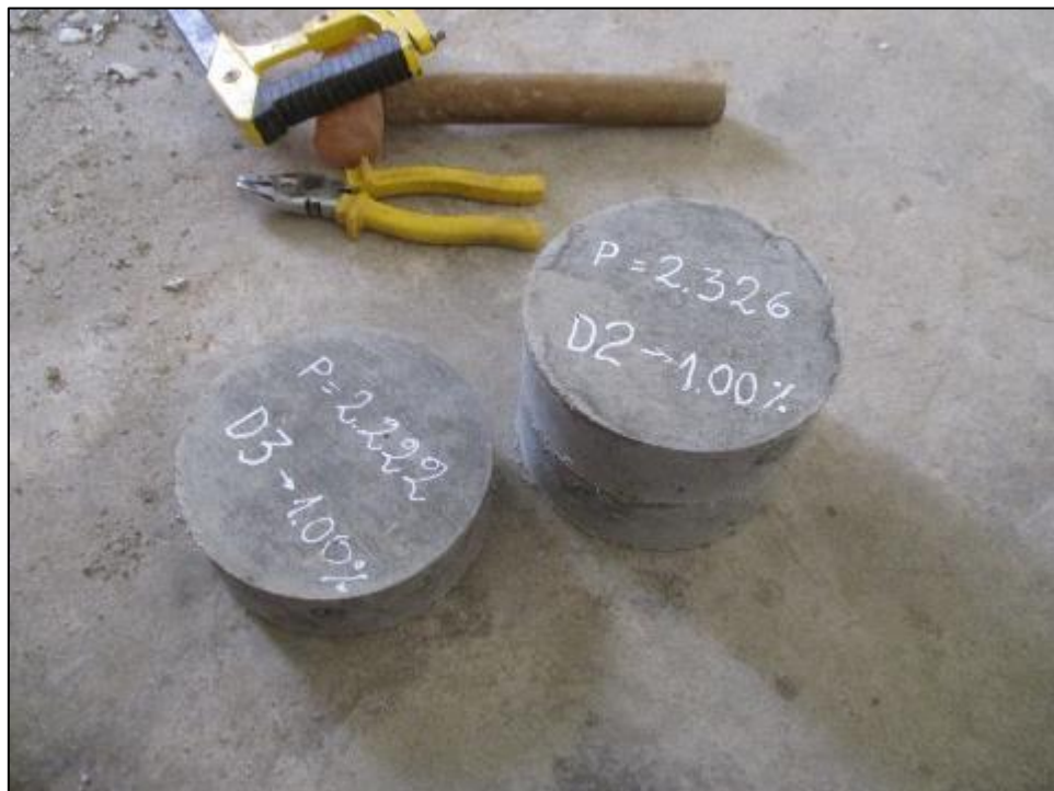
Figura 68: Desenfofrado de los discos de concreto. Fuente: El autor, 2020.
