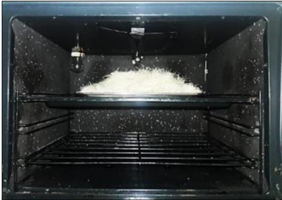
Figura 47: Secado de la fibra de furcraea andina en horno a 100°C durante 24 horas. Fuente: El autor, 2020.
