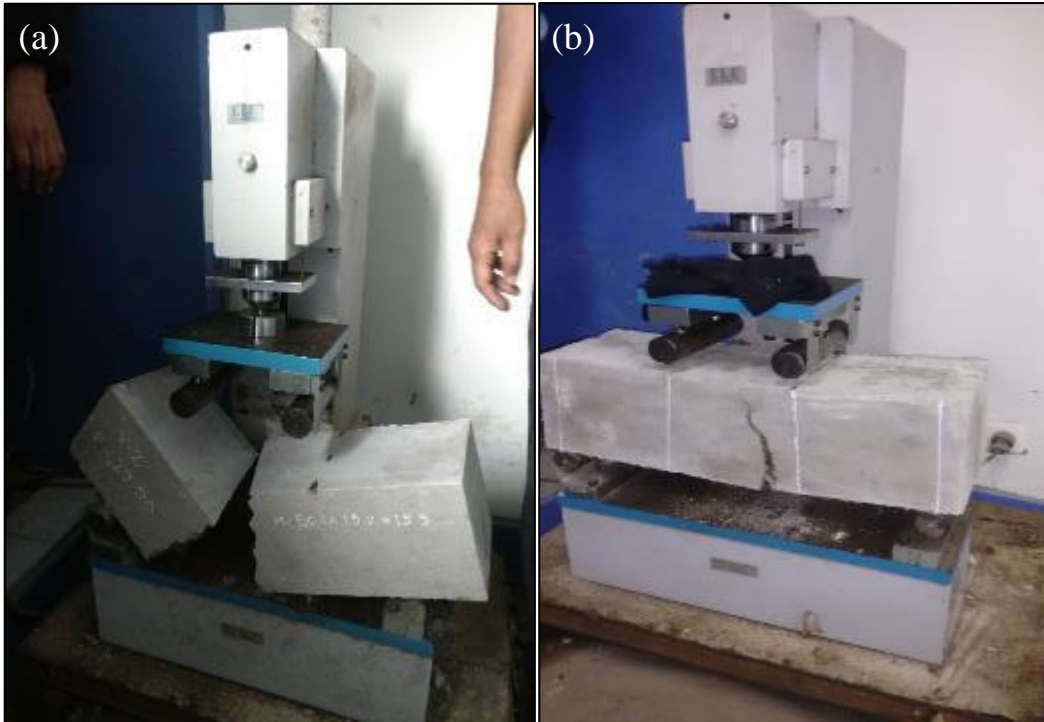
Figura 75: (a) Falla frágil de un espécimen sin fibras, (b) Falla dúctil debido a las fibras de refuerzo, a flexión.
