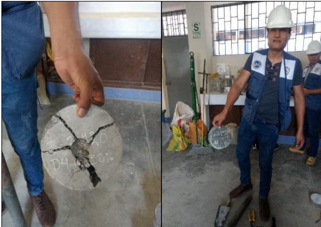
Figura 82: Los especímenes con fibra no generaron desprendimientos abruptos.
