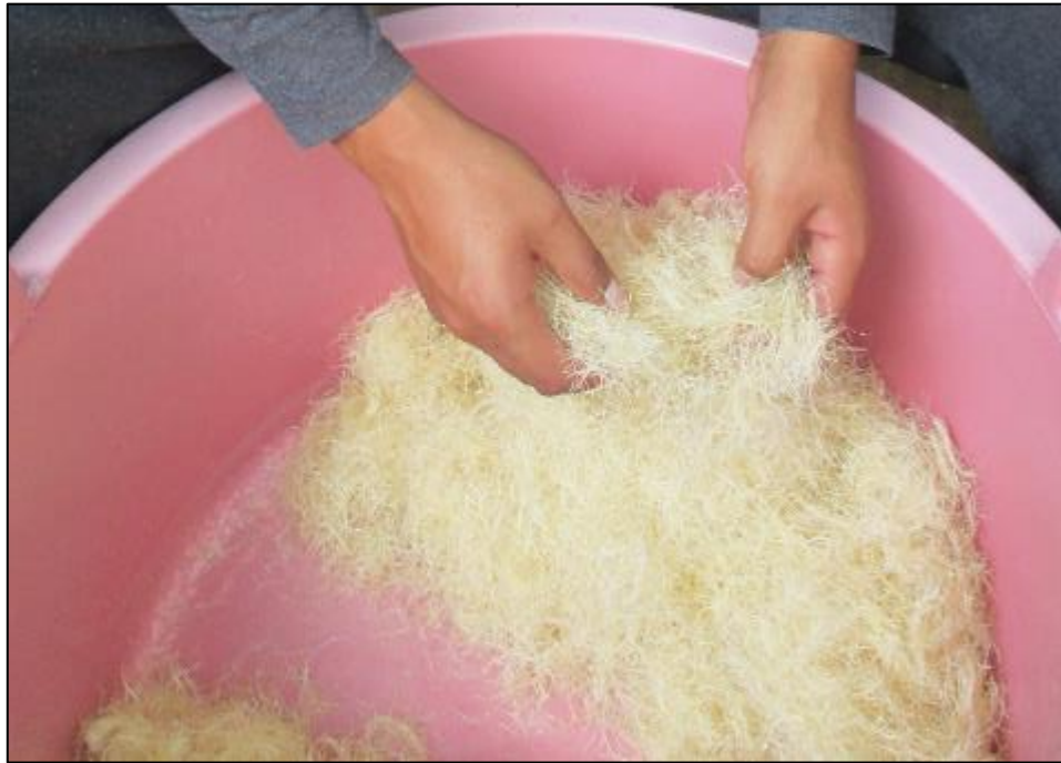
Figura 41: Separación manual de las fibras de furcraea andina con parafina. Fuente: El autor, 2020.
