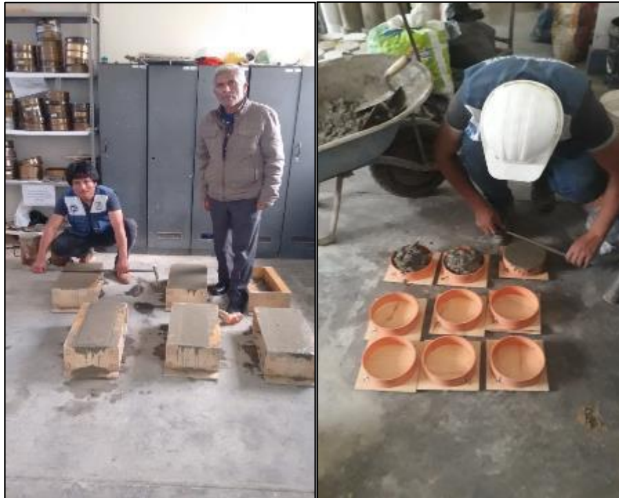
Figura 65: Enrasado del exceso de mezcla con la varilla de compactación. Fuente: El autor, 2020.
