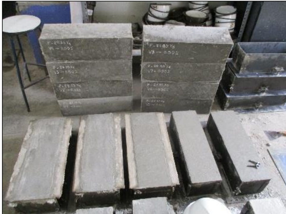
Figura 67: Desenfofrado de las vigas de concreto. Fuente: El autor, 2020.
