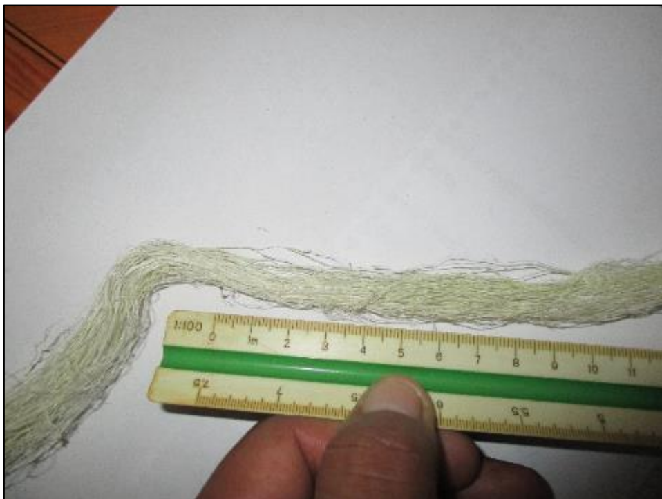
Figura 36: Medición de la fibra de furcraea andina cada 2.5 cm Fuente: El autor, 2020.
