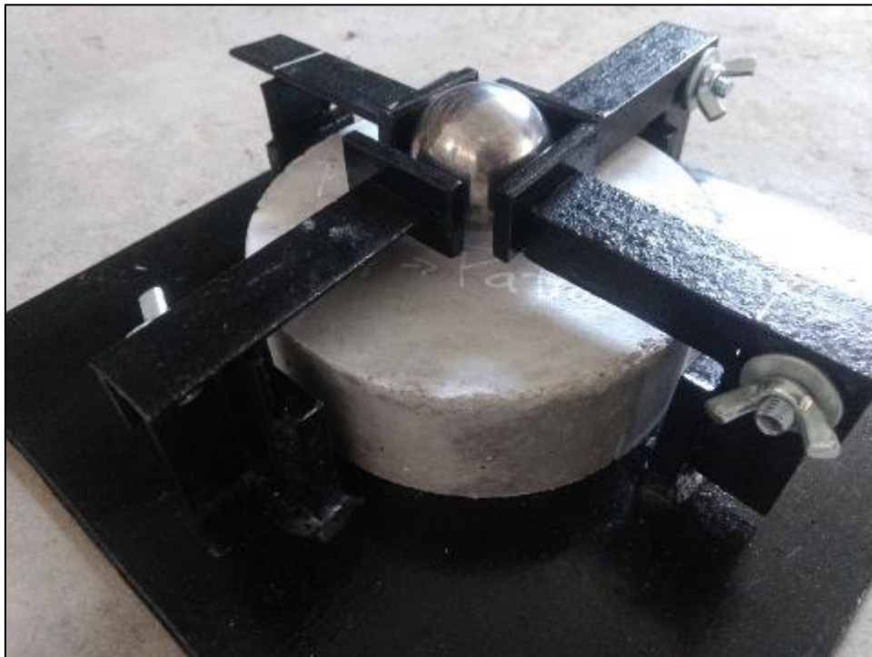
Figura 78: Colocación de los especímenes en el dispositivo de ensayo a impacto.
