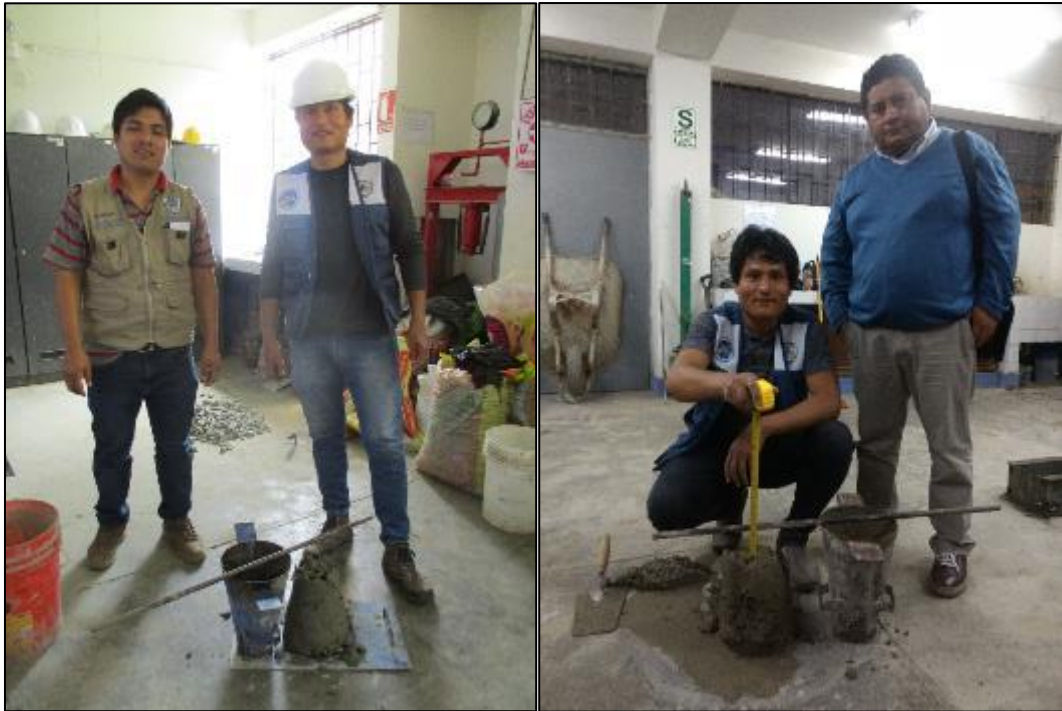
Figura 71: Medición del asentamiento del concreto patrón y experimental. Fuente: El autor, 2020.
