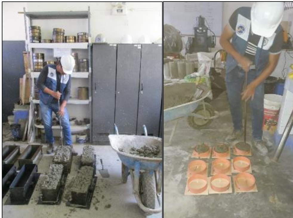
Figura 63: Compactación de la mezcla en cada capa con 25 penetraciones de la varilla. Fuente: El autor, 2020.
