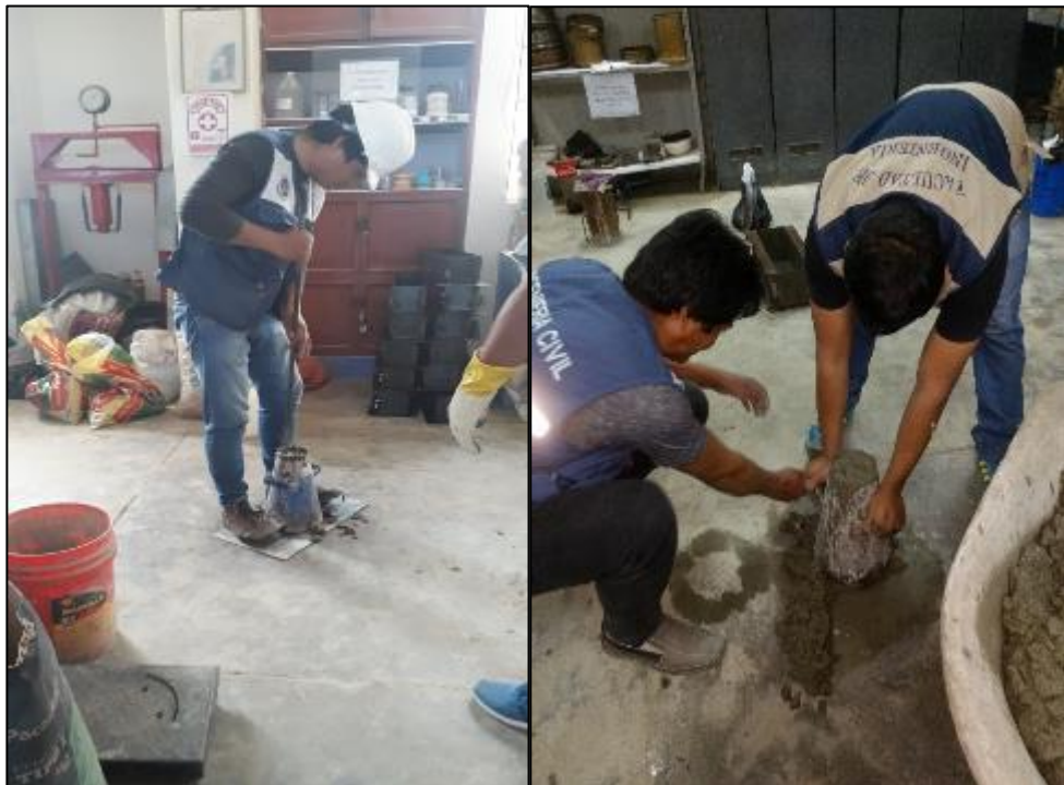
Figura 70: Compactación y alzado del molde de cono de abrams. Fuente: El autor, 2020.
