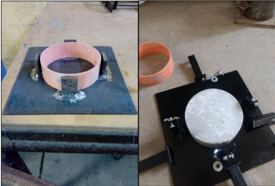
Figura 77: Mostrando el disco de concreto en el dispositivo fabricado para el ensayo a impacto.
