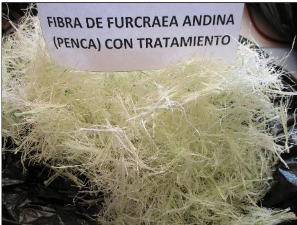
Figura 42: Fibra de furcraea andina (penca) con tratamiento. Fuente: El autor, 2020.
