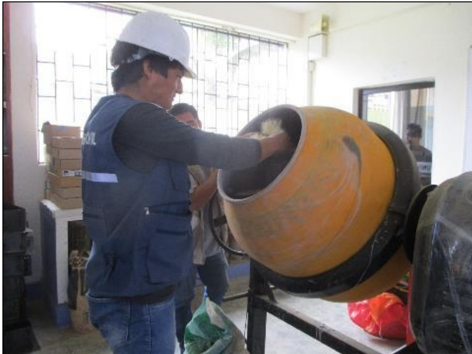
Figura 61: Adición de la fibra de furcraea andina en la mezcla. Fuente: El autor, 2020.
