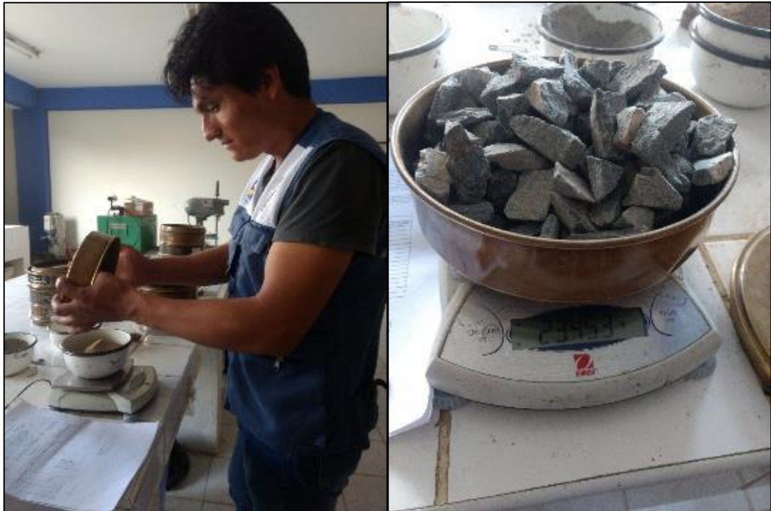
Figura 49: Análisis granulométrico (peso del agregado fino y grueso). Fuente: El autor, 2020.
