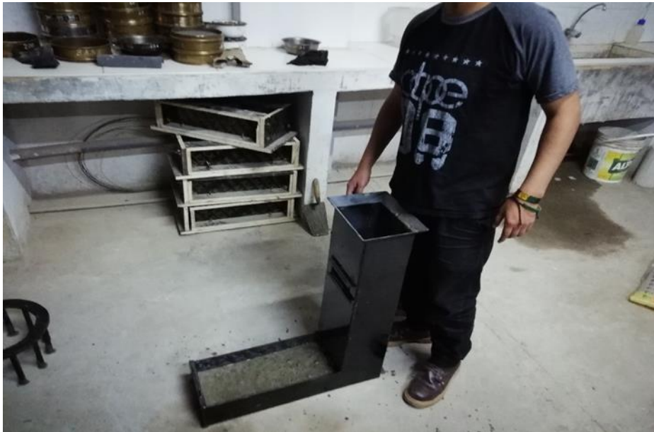
Figura 4 Ensayo de capacidad de paso usando la caja en L Fuente: elaboración propia
