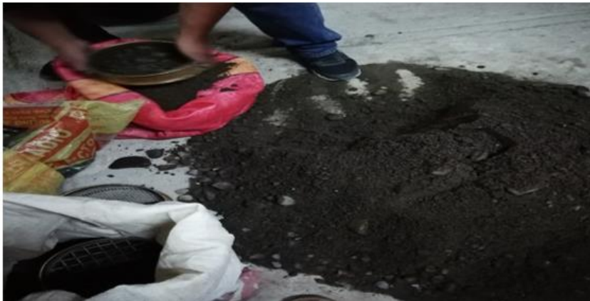
Figura 23 Tamizado del Agregado Grueso Fuente: Elaboracion Propia
