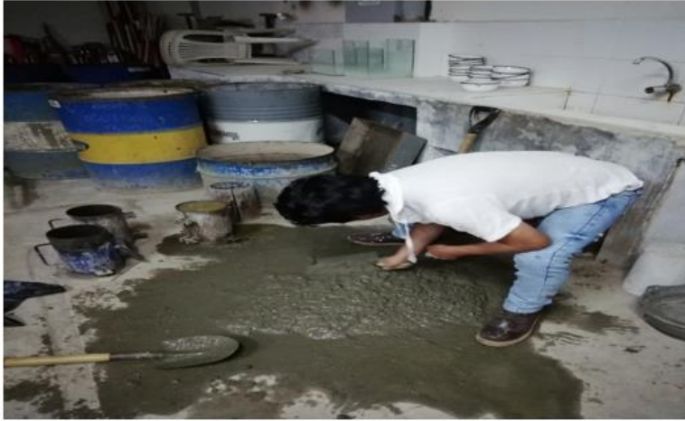
Figura 28 Preparación del Diseño de Mezcla para las pruebas de fluidez y briquetas Fuente: elaboración propia
