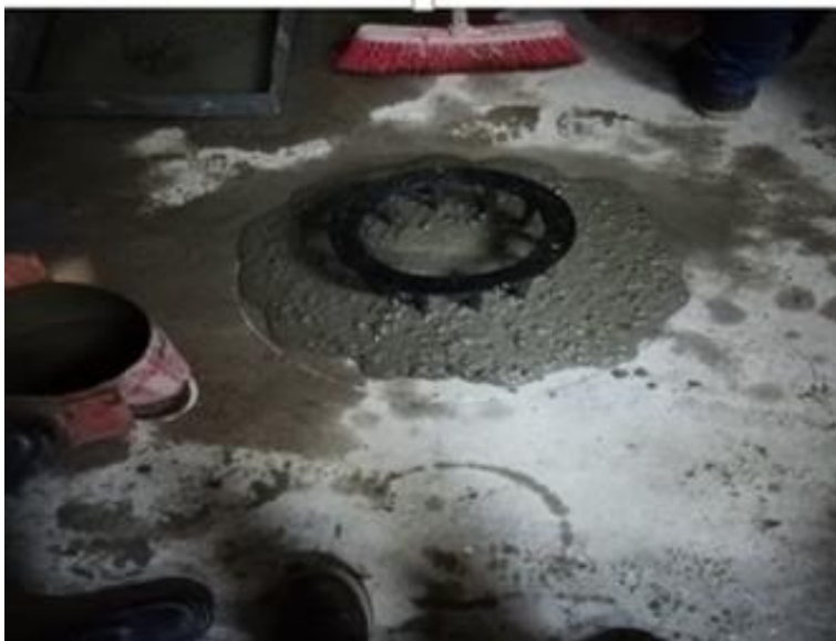
Figura 31 Prueba de Fluidez del CAC Fuente: elaboración propia
