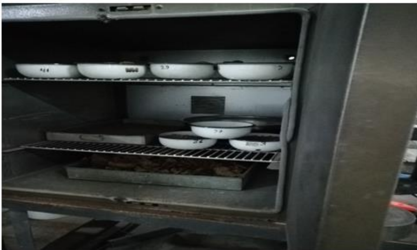
Figura 27 Muestras para realizar el Ensayo de Contenido de Humedad Fuente: Elaboración propia
