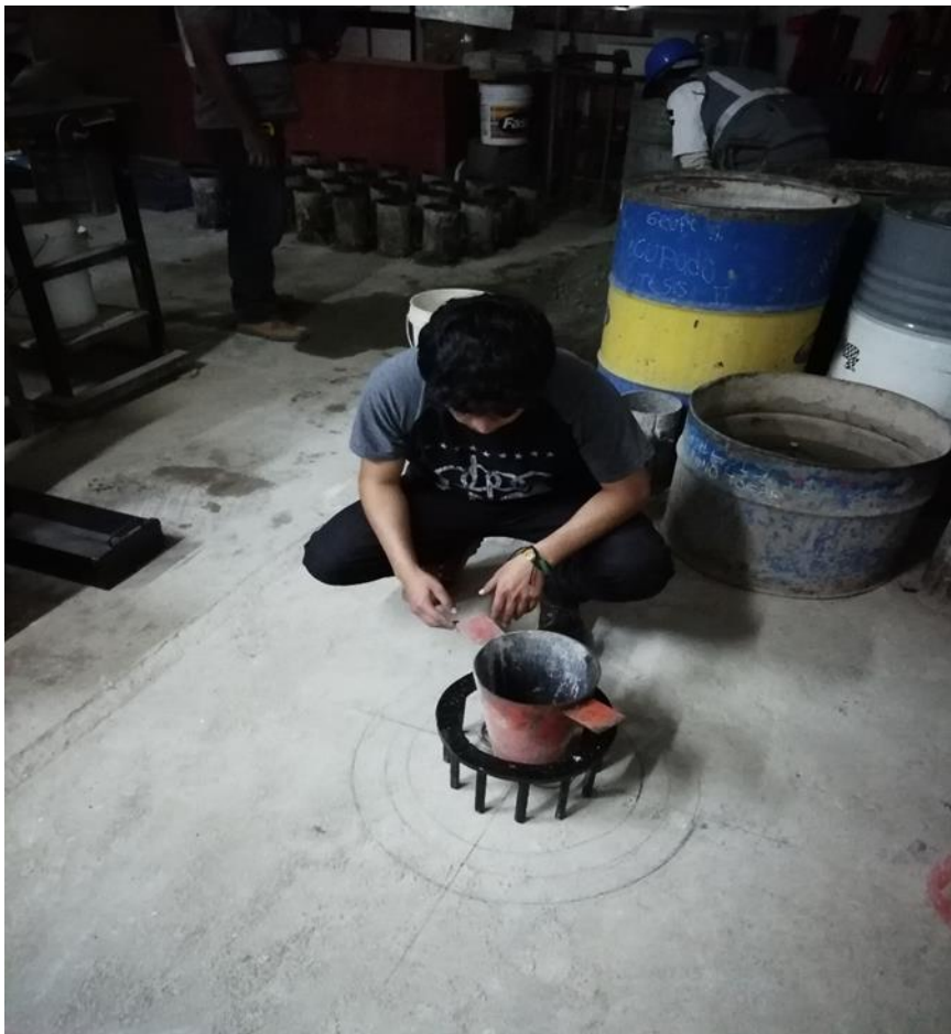
Figura 6 Ensayo con el Anillo Japonés en laboratorio de concreto Fuente: Laboratorio de la USP
