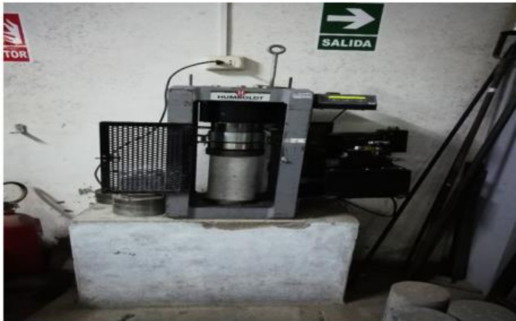
Figura 34 Ensayo de Resistencia a la Compresion de los especimenes Fuente: elaboración propia
