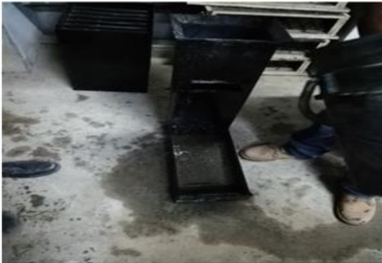
Figura 33 Ensayo de fluidez del CAC con la caja en L Fuente: elaboración propia
