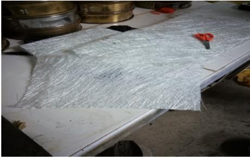
Figura 30 Fibra de vidrio Tipo E para adicionar al diseño de mezcla Fuente: elaboración propia
