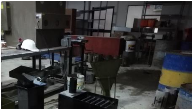
Figura 2 Ensayo en el embudo en V para medir la capacidad de relleno
