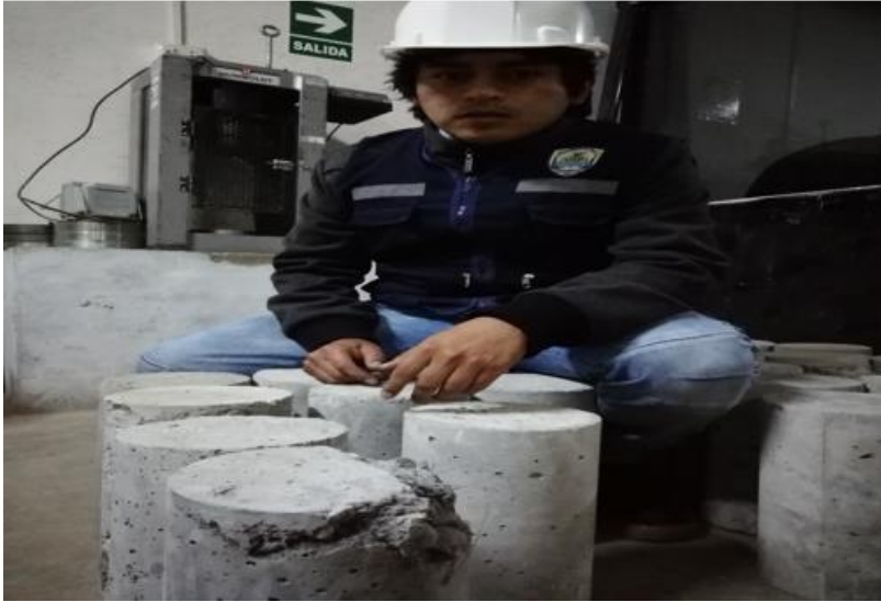
Figura 36 Especímenes fracturados después del ensayo a Compresión Fuente: elaboración propia
