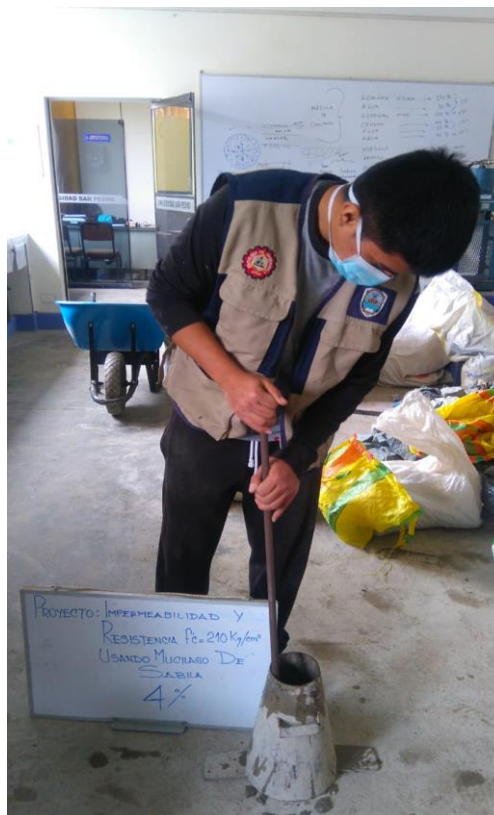
Figura 19. Realizando el slump de concreto para poder realizar el vaciado de las probetas.
