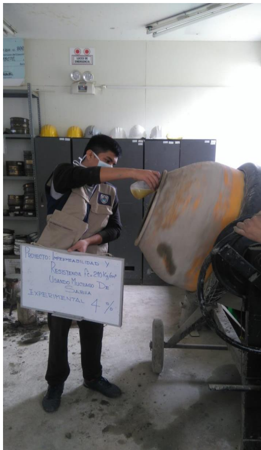
Figura 21. Agregando el aditivo (mucilago de sábila) al concreto experimental.
