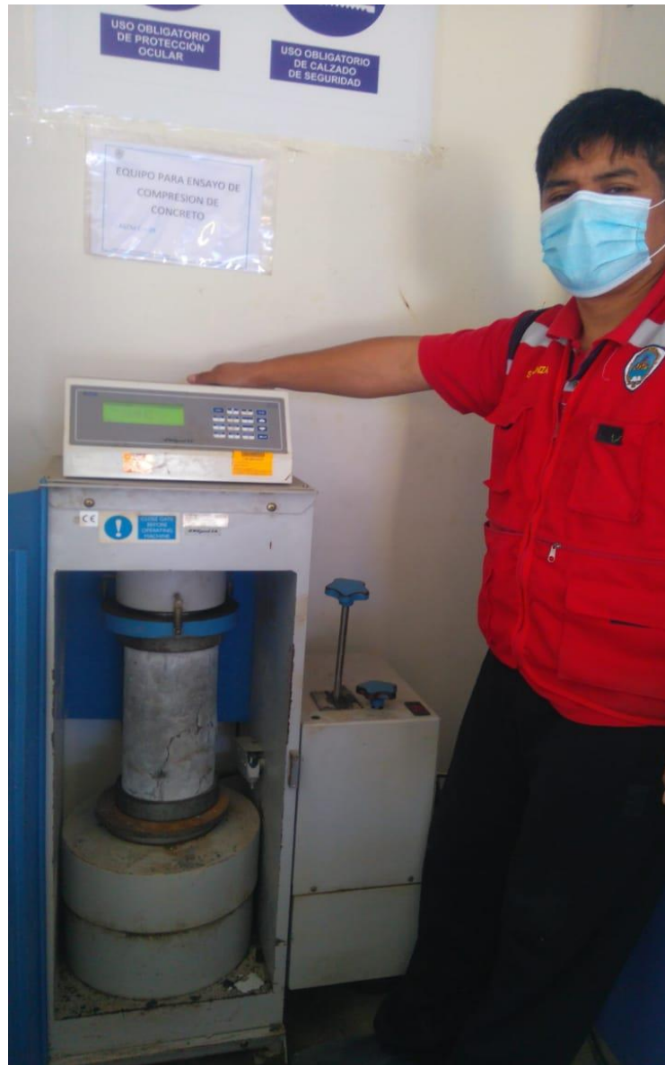
Figura 26. Ensayo a la compresión de probetas.
