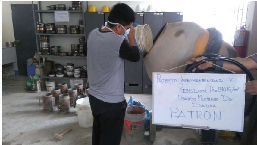
Figura 18. Realizando la mezcla de concreto.
