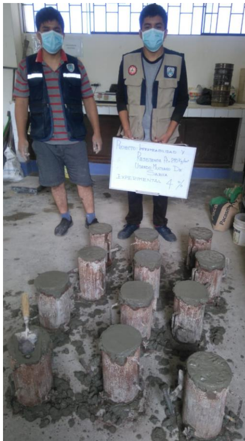
Figura 23. Terminando la elaboración de las probetas.
