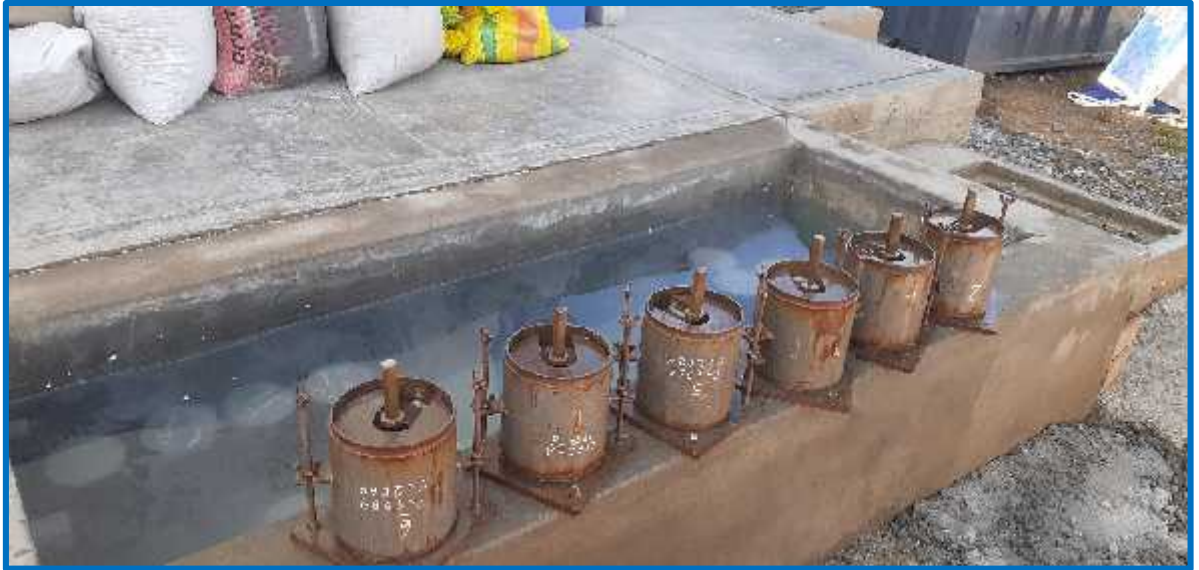
Figura 11. Muestras retiradas de la cámara de curado de concreto después de tres días de sumergido
