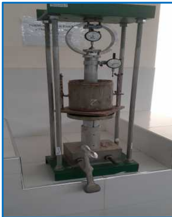
Figura 12. Fotos de ensayo CBR y peso de la muestra para obtención del grado de humedad
