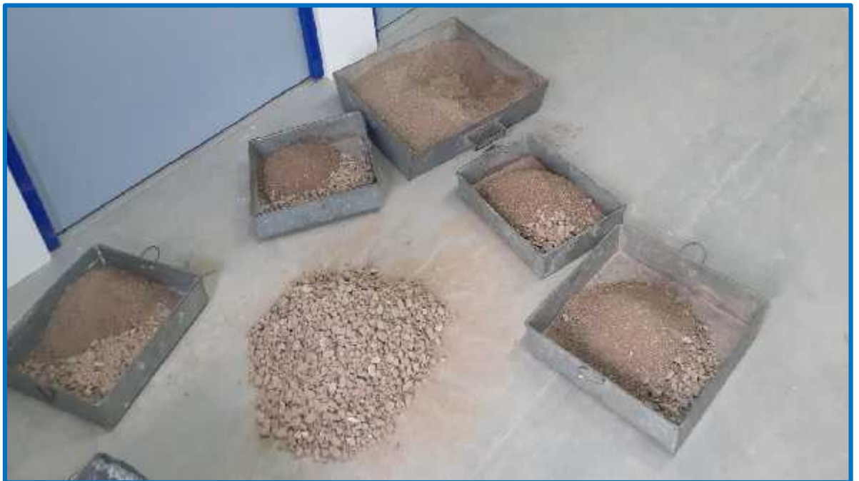
Figura 6. Preparación de la muestra de Proctor modificado
