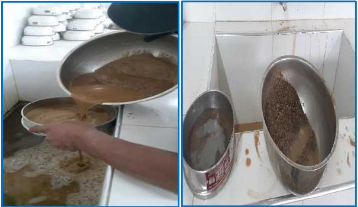
Figura 4. Fotos de lavado de muestra para determinar el módulo de fineza
