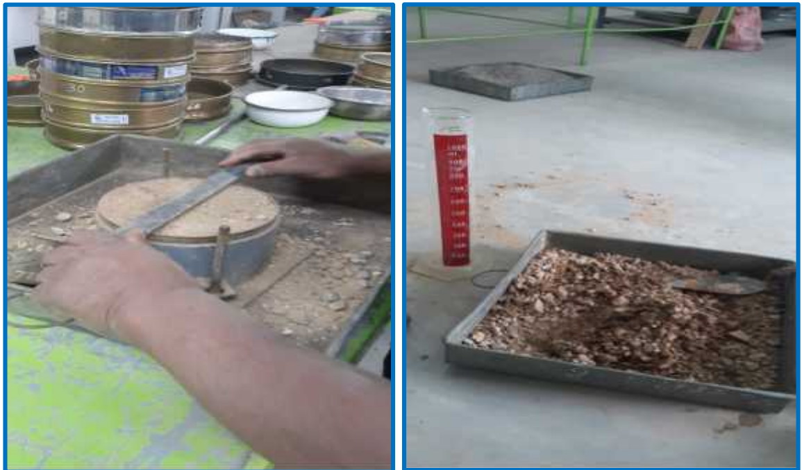
Figura 8. Fotos de enrase de la muestra ensayada del Proctor modificado y adición de porcentaje de agua por cada ensayo de la muestra
