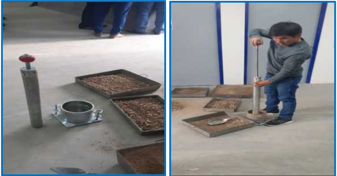
Figura 7. Fotos de instrumento, muestra para ensayo y ejecución del Proctor modificado
