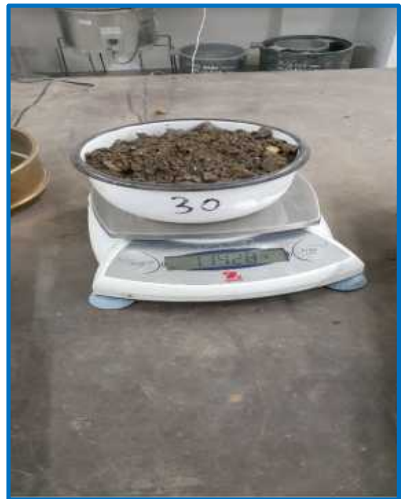
Figura 12. Fotos de ensayo CBR y peso de la muestra para obtención del grado de humedad
