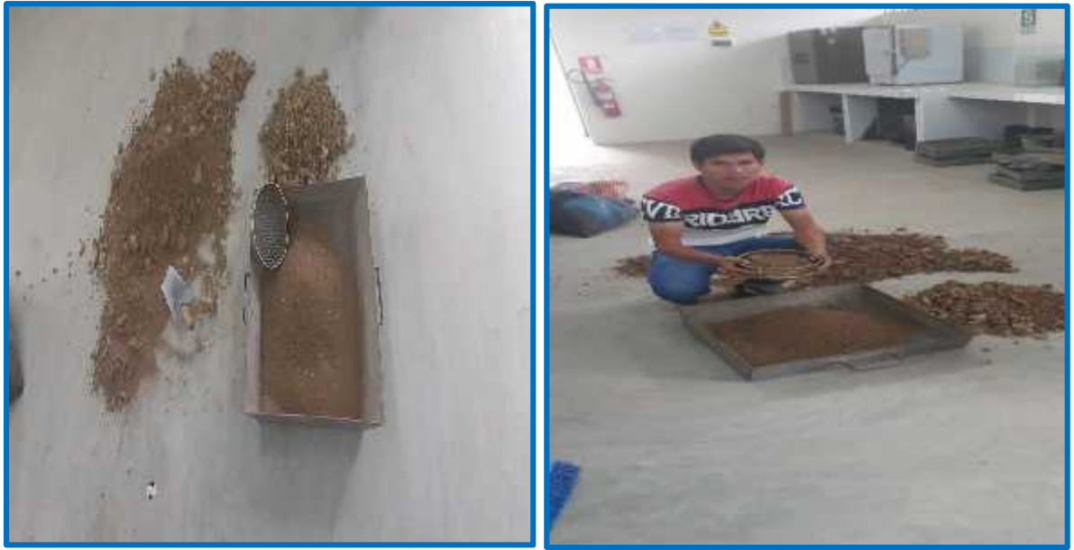
Figura 3. Fotos de tamizado de la muestra de suelo de las calicatas 1 y 2
