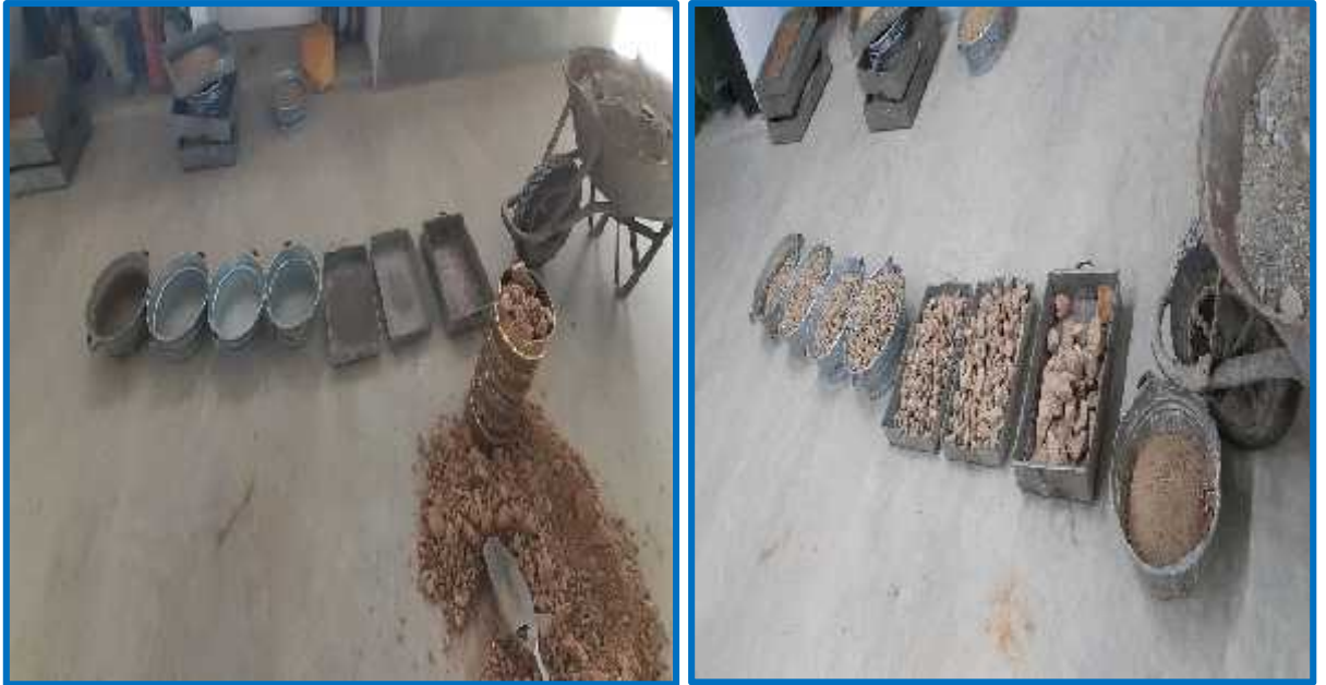
Figura 5. Fotos de determinación de la granulometría mediante tamizado
