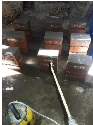
Foto N° 07. Preparación de Pilas Patrón, con 10% de Relave y 15% de Relave y curado
