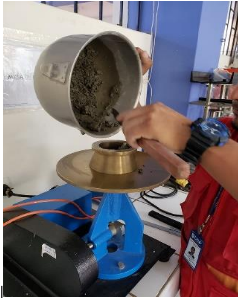
Foto N°05. Obtención de la Fluidéz del mortero
