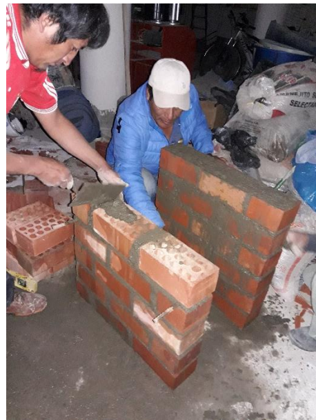
Foto N°06. Preparación de Muretes Patrón, con 10% de Relave y 15% de Relave
