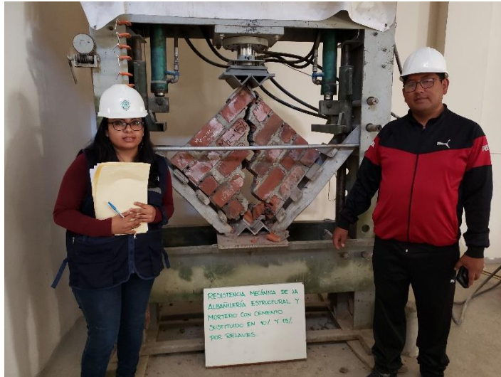
Foto N° 11. Ensayo de Compresión Diagonal
