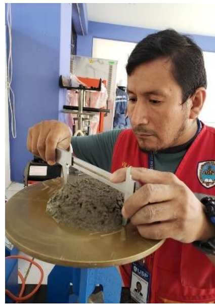
Foto N°05. Obtención de la Fluidéz del mortero
