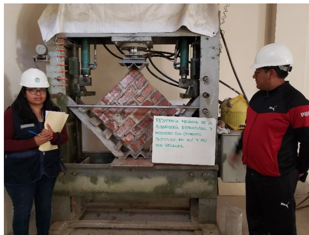
Foto N° 10. Ensayo de Compresión Diagonal
