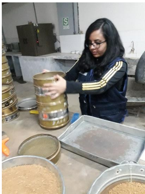
Foto N°03. Obtención de propiedades físicas del agregado fino.
