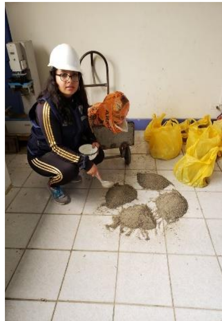
Foto N°03. Obtención de propiedades físicas del agregado fino.
