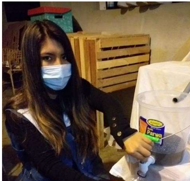
Figura 29. Captando la muestra de agua tratada que se encuentra en el tercer balde, para llevar las muestras al laboratorio Colecibi S.A.C.
