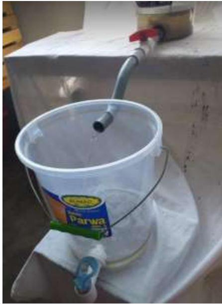
Figura 28. Balde 2 con muestra en reposo de 30 minutos luego de la remoción y apertura de segunda llave de paso.
