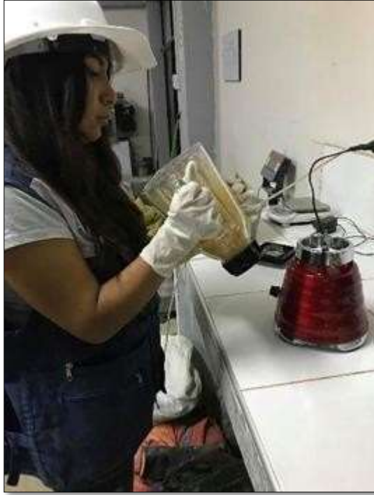
Figura 16. Triturado de muestra de cáscara de mandarina con ayuda de una licuadora, la cual fue desinfectada para evitar contaminación del material.
