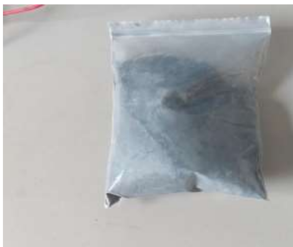
Figura 20. Muestra de polvo de cáscara de mandarina, resultado de activación a temperatura de 480°C durante 90 minutos con pérdida de 89% de material ( peso final: 76gr).
