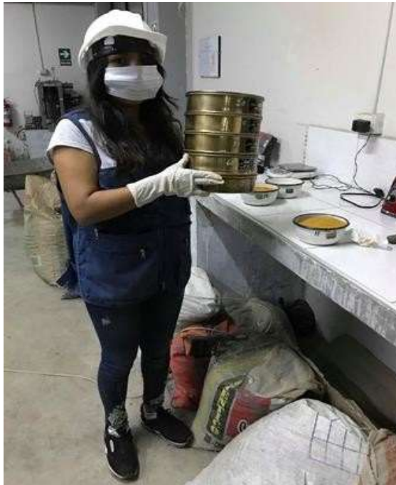
Figura 17. Tamizado de muestra de cáscara de mandarina seca y triturada Mallas N°200.
