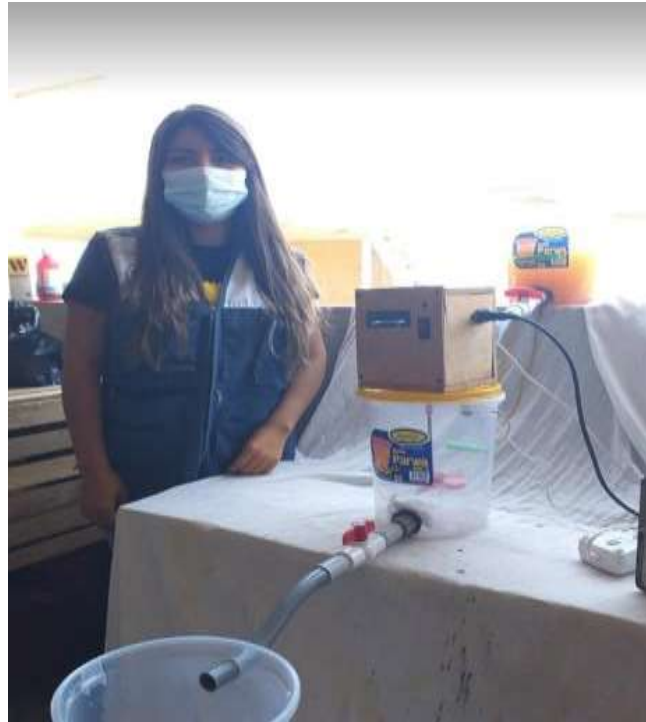
Figura 24. Biofiltro culminado, en pleno proceso de remoción, con muestra de agua contaminada en primer balde.
