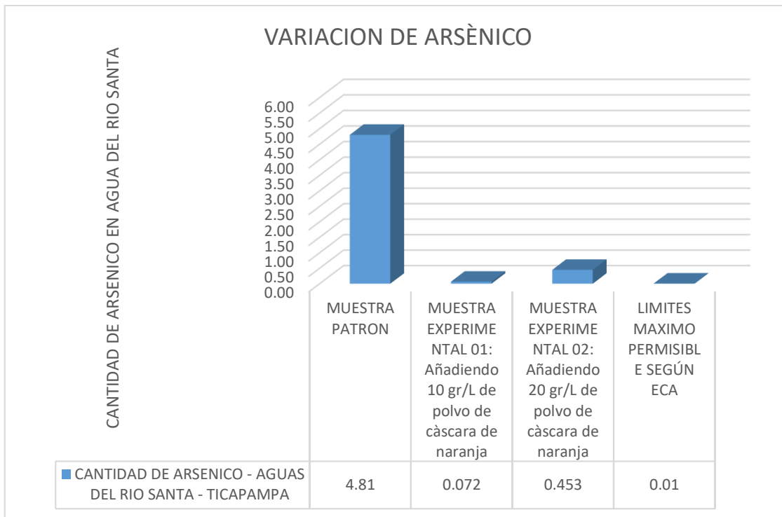
Figura 16. Gráfico de barras representando la cantidad de arsénico obtenidas por las muestras y el L.M.P. según ECA.
