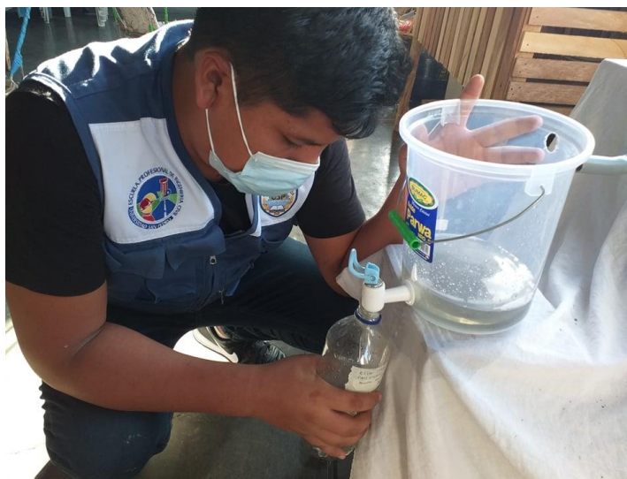
Figura 37. Captando la muestra de agua tratada que se encuentra en el tercer balde, para llevar las muestras al laboratorio Colecbi S.A.C.
