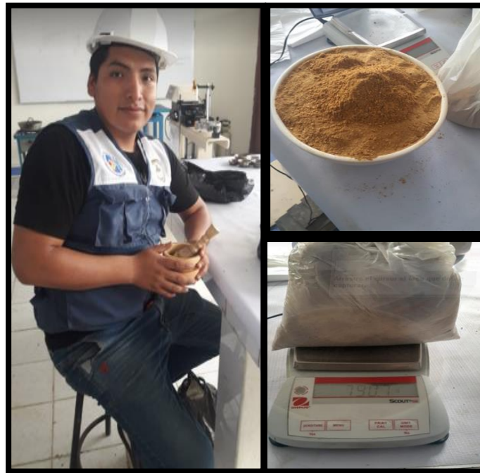
Figura 25. Triturado de muestra de càscara de naranja con ayuda de un batan de madera, la cual fue desinfectada para evitar contaminación del material.
