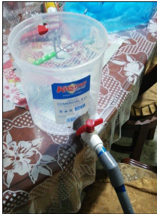
Figura 31. Ensamblaje de partes del biofiltro a escala y accesorios requeridos.
