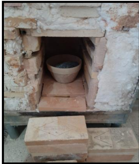
Figura 27. Muestra de càscara de naranja en mufla para activarse a 480°C
