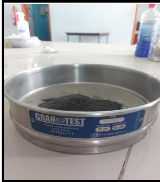
Figura 26. Tamizado de muestra cascara de naranja seca y triturada (Malla N°200).
