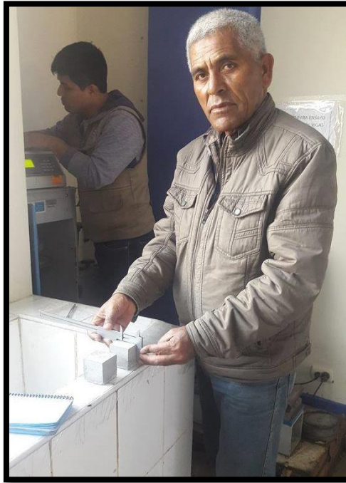
Fotografía 23. Se procedió a la medición de los cubos de morteros patrón.
