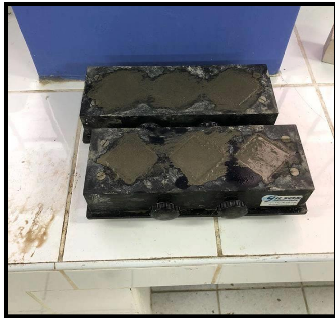
Fotografía 15-16. Se realizó el vaciado de mezcla de mortero y se compactó con 32 veces cada cubo, en 2 capas.
