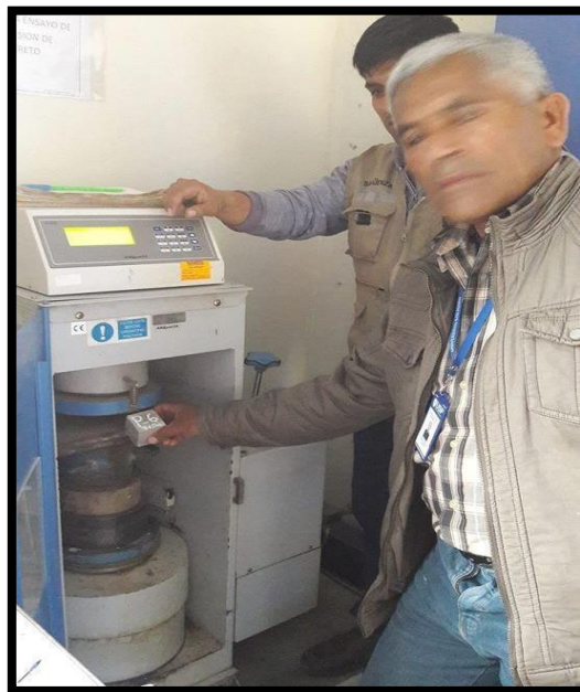
Fotografía 24. Se realizó el ensayo de resistencias a los morteros patrón.
