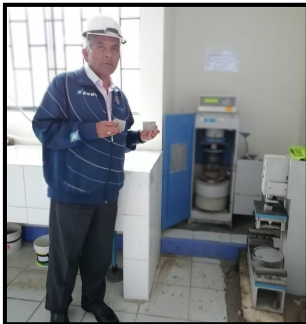
Fotografía 26. Se realizó el ensayo de resistencias a los morteros experimentales a 7 días de edad.
