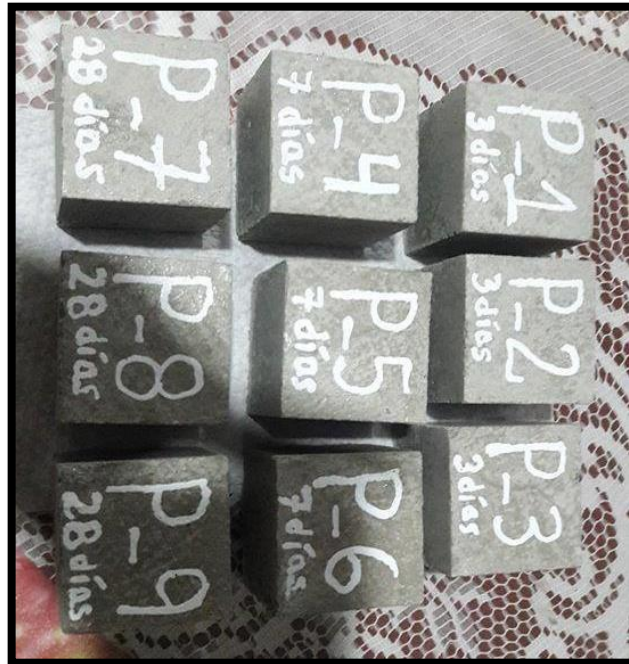
Fotografía 17. Se desmoldaron los morteros patrones de distintas edades.
