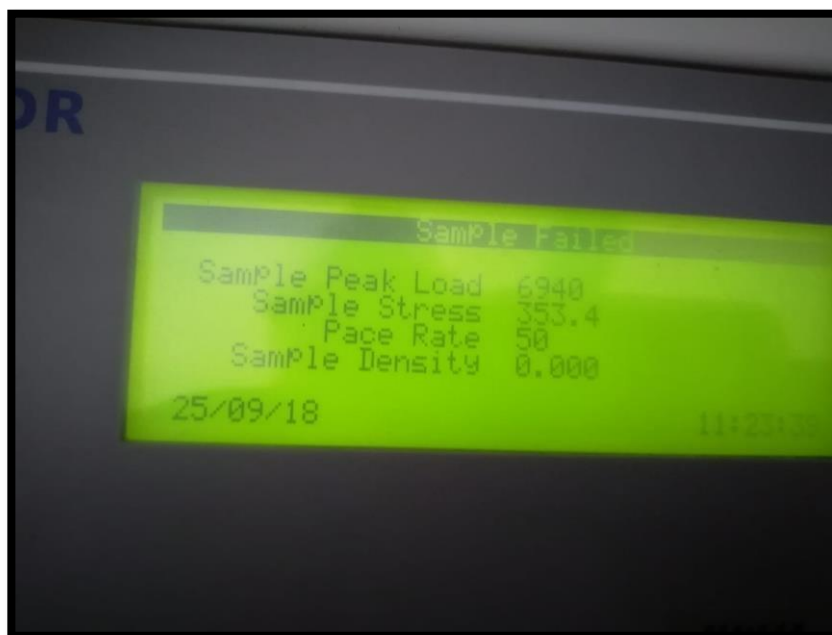
Fotografía 28-29. Se tomaron nota de las resistencias para luego ser analizadas y graficadas.
