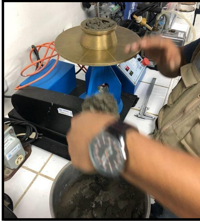
Fotografía 11. Se hace el ensayo de fluidez para los morteros patrón y experimentales.
