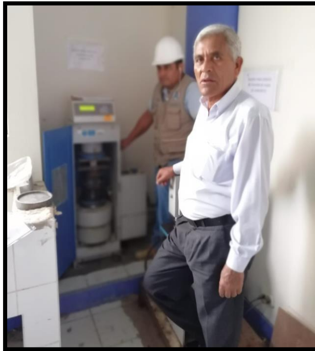
Fotografía 27. Se realizó el ensayo de resistencias a los morteros experimentales a 28 días de edad.
