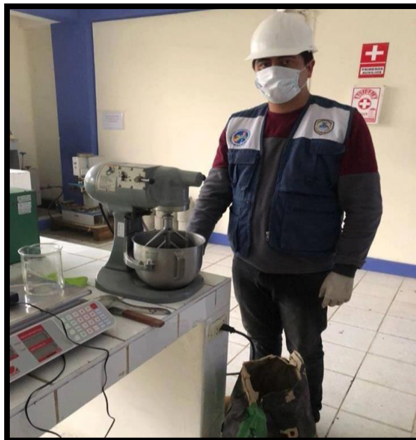
Fotografía 13-14. Se comenzó con el mezclado de los morteros patrón y experimentales.
