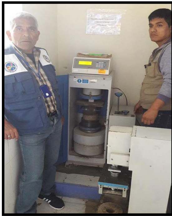
Fotografía 25. Se realizó el ensayo de resistencias a los morteros a 3 días de edad.
