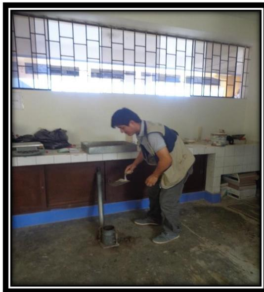
**Figura 25.** Realizando el proctor modificado
