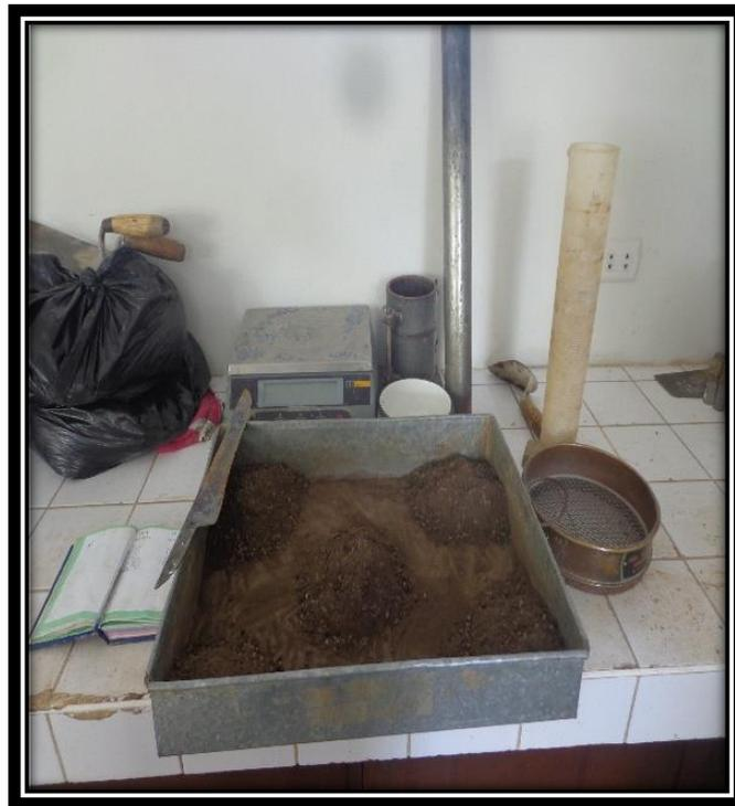
*Figura 23.* Seleccionando la muestra para proctor y CBR
