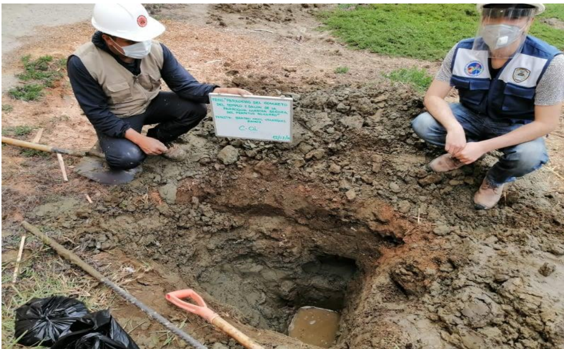
Figura N°21. Tomando muestra para ensayo químico
