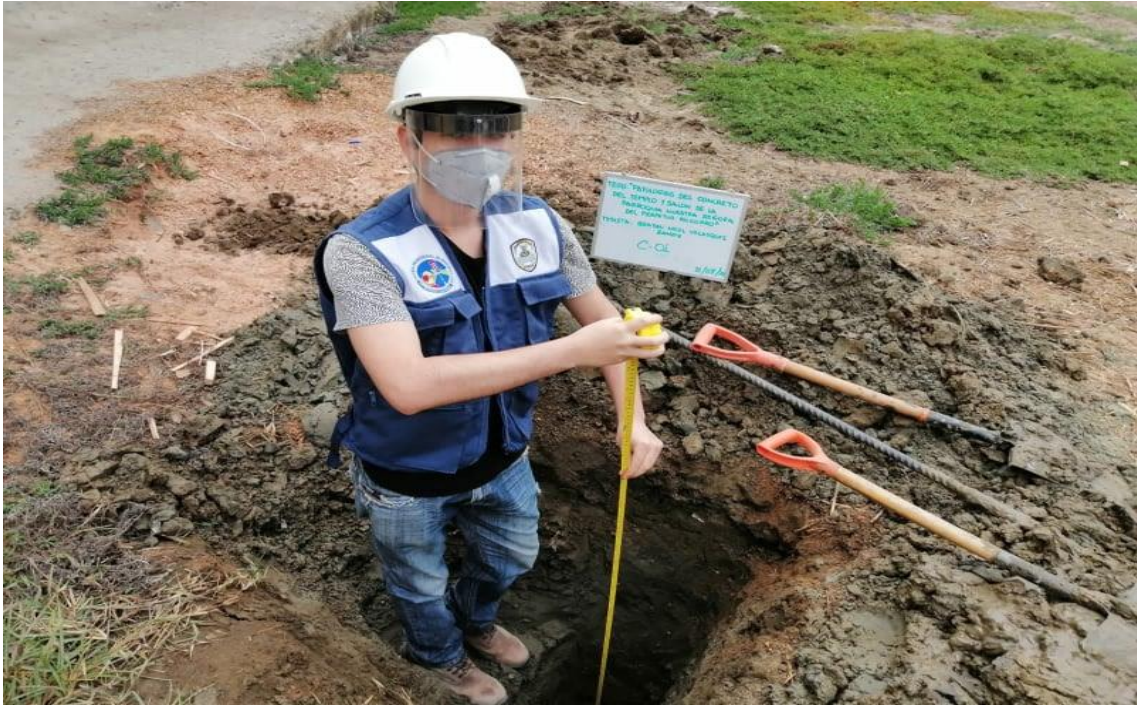
Figura N°20. Realizando calicata para el estudio de suelo
