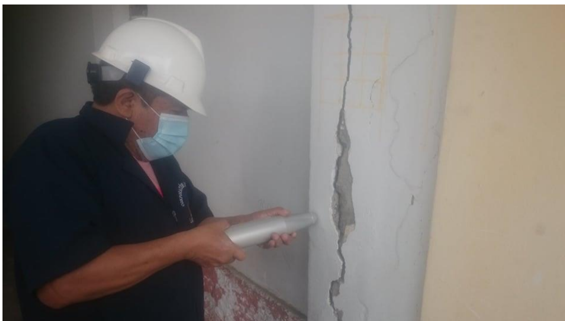
Figura N°17. Ingeniero sosteniendo el esclerómetro
