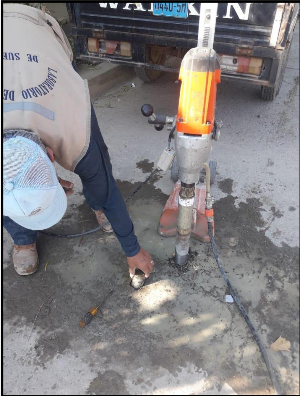
*Figura 51.* Ensayo de prueba de diamantina
