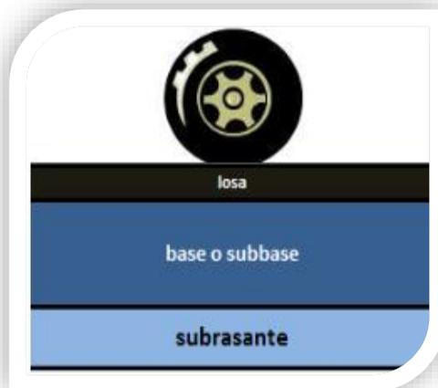
*Figura 1.* Esquema típico del paquete estructural de un pavimento
