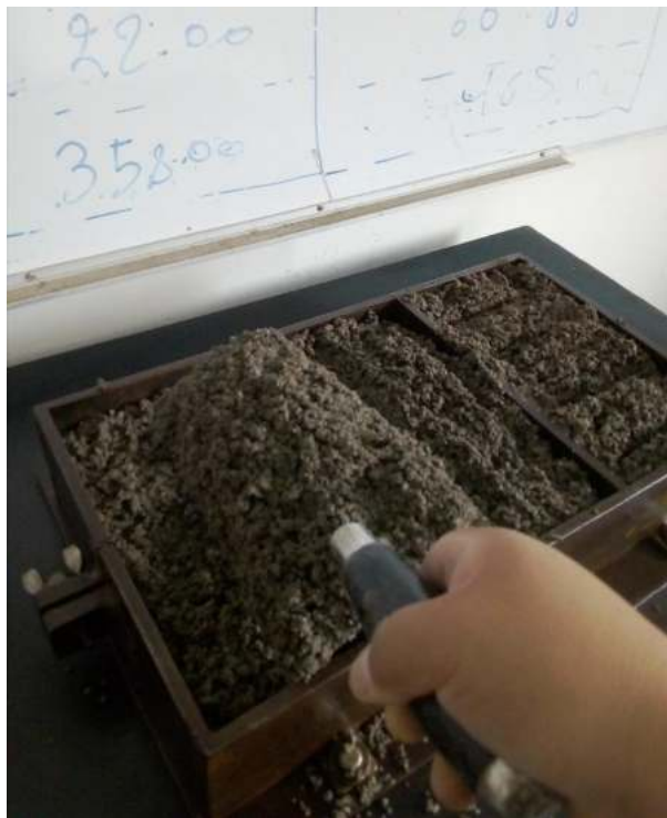
Figura N° 33: Vaciado de la mezcla dentro del molde ladrillero.
