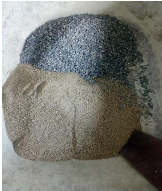
Figura N° 31: Mezclado de los agregados gruesos y finos.
