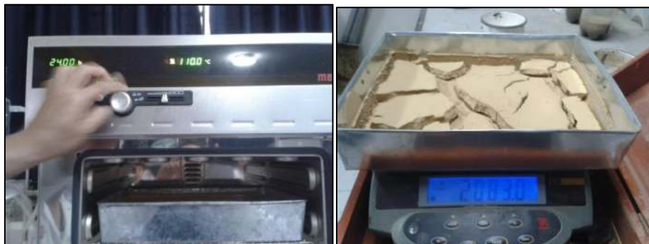
Figura N° 07: Pre secado en el horno en una temperatura de 110°C.
