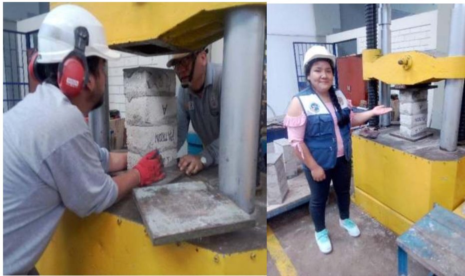
Figura N° 49: Colocación de la pila patrón dentro de las planchas y centrándolo en la prensa.
