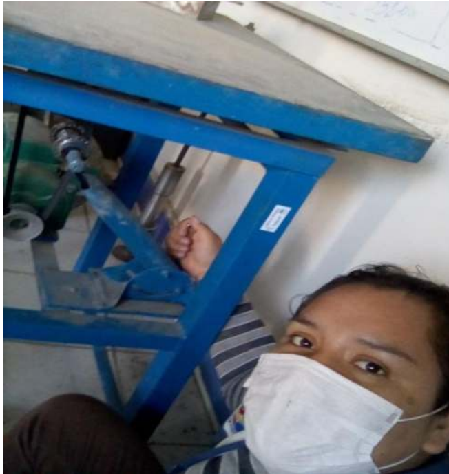
Figura N° 40: Ajustando el templador de la faja, para la realización de los ladrillos para la pila.
