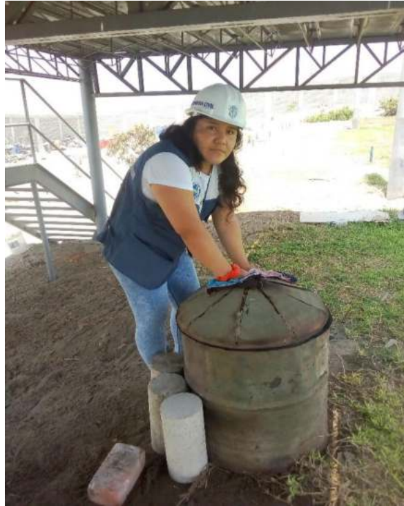
Figura N° 26: 24 horas después de la combustión se retira la tapa del horno casero.
