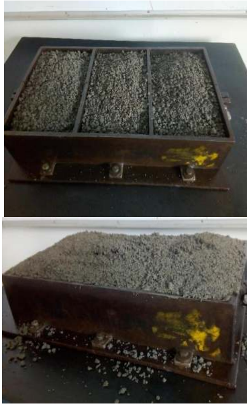
Figura N° 34: Vibrado del molde en la mesa vibradora por 15 min.
