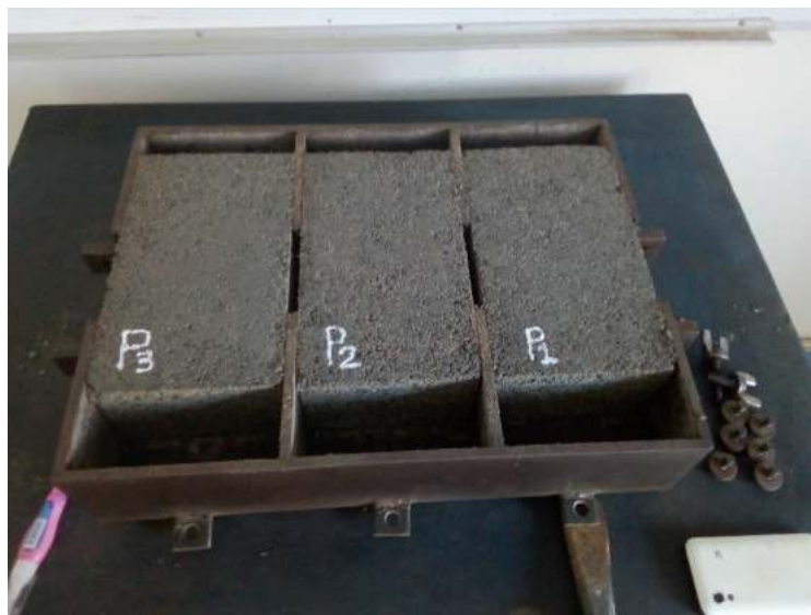
Figura N° 37: Desencofrado de los ladrillos de concreto, pasado las 24 horas de su preparación.
