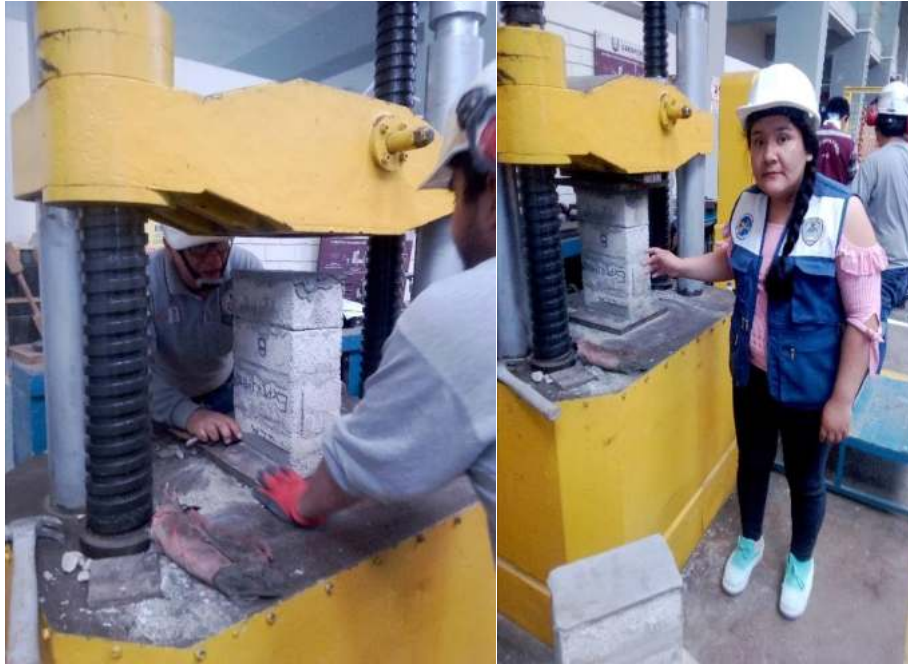
Figura N° 52: Colocación de la pila experimental dentro de las planchas y centrándolo en la prensa.
