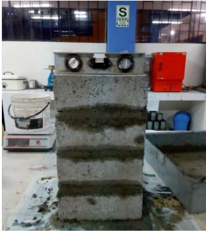
Figura N° 42: Nivelación del ladrillo con el mortero, al realizar la pila de 4 ladrillos de concreto vibrado.
