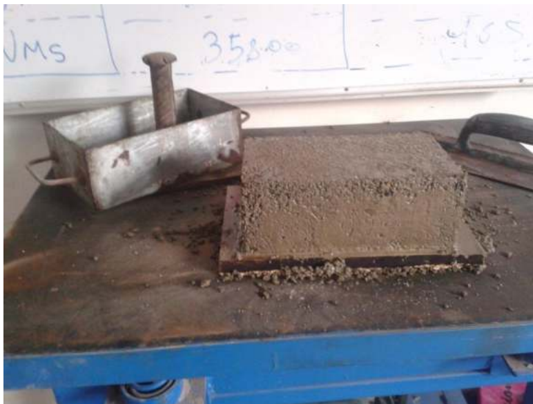
Figura N° 41: Ladrillo realizado para las pilas, realizado con un molde por unidad.
