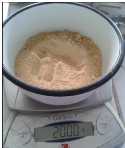
Figura N° 09: Pasado por la malla N°200, listo para el límite de Atterberg.
