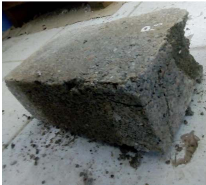
Figura N° 39: Correcta fisuras dentro del espécimen ensayado.
