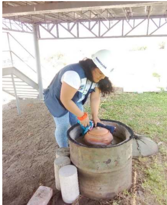
Figura N° 27: Retiro de la olla de barro con las placas de arcilla dentro.
