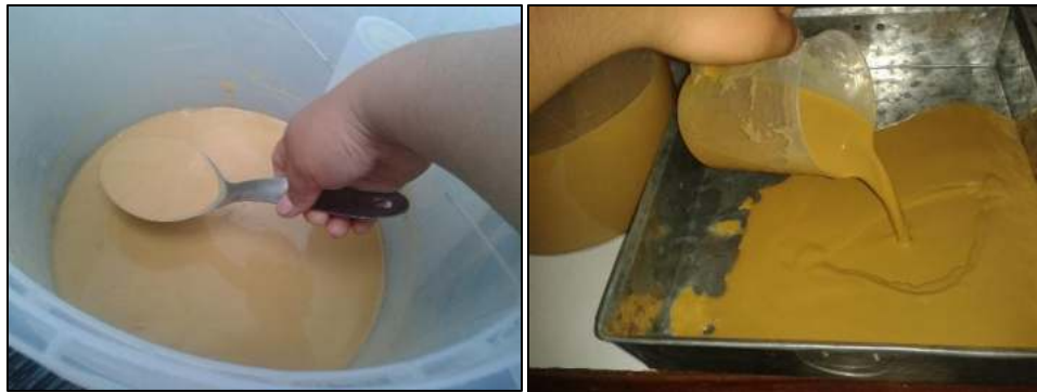
Figura N° 06: Colocación de la arcilla lavada limpia en la fuente.
