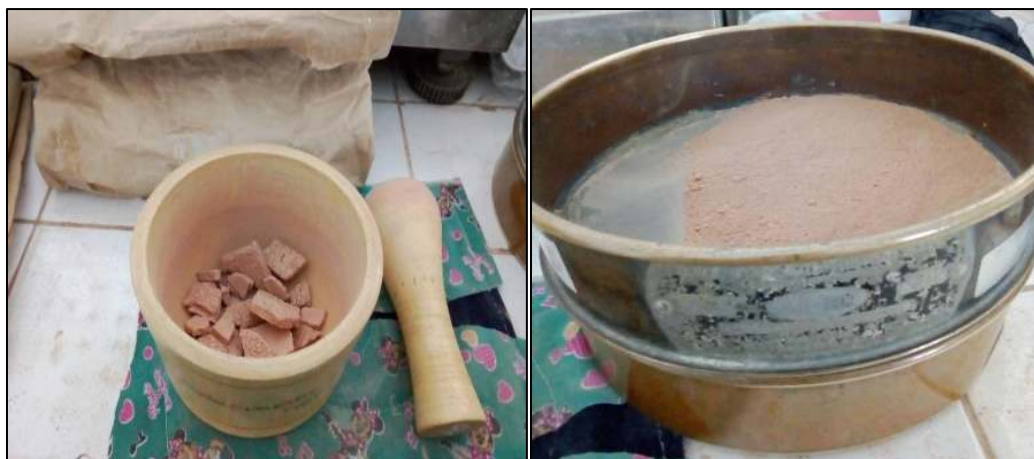
Figura N° 12: Molienda y tamizado en la malla N°200 de la arcilla calcinada a cielo abierto.
