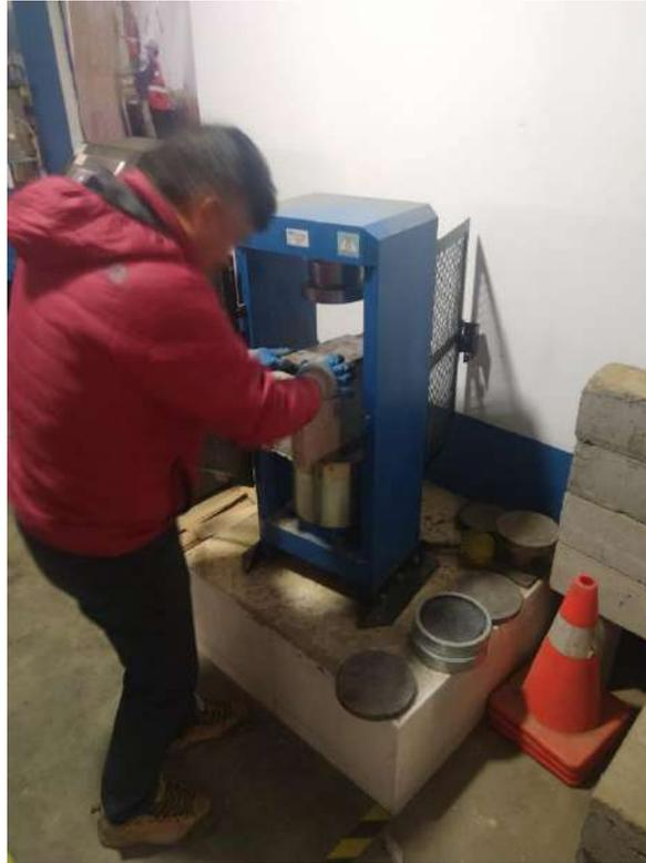
**Figura N° 14:** Colocación del bloque de concreto en la prensa.
