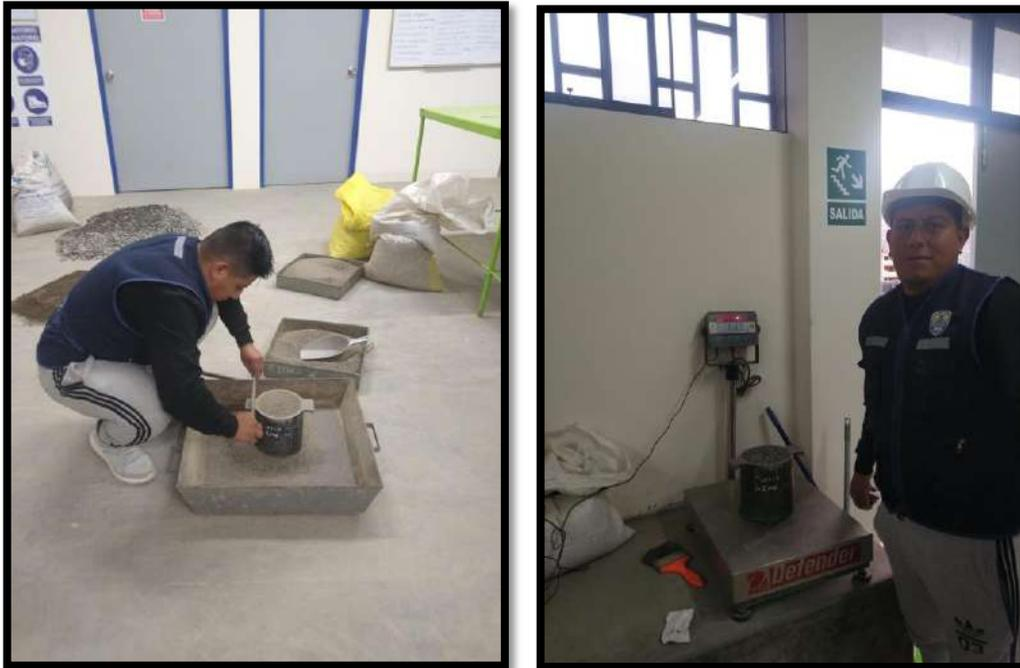
**Figura N° 08:** Proceso de para calcular el peso unitario del agregado fino mediante el método volumétrico.
