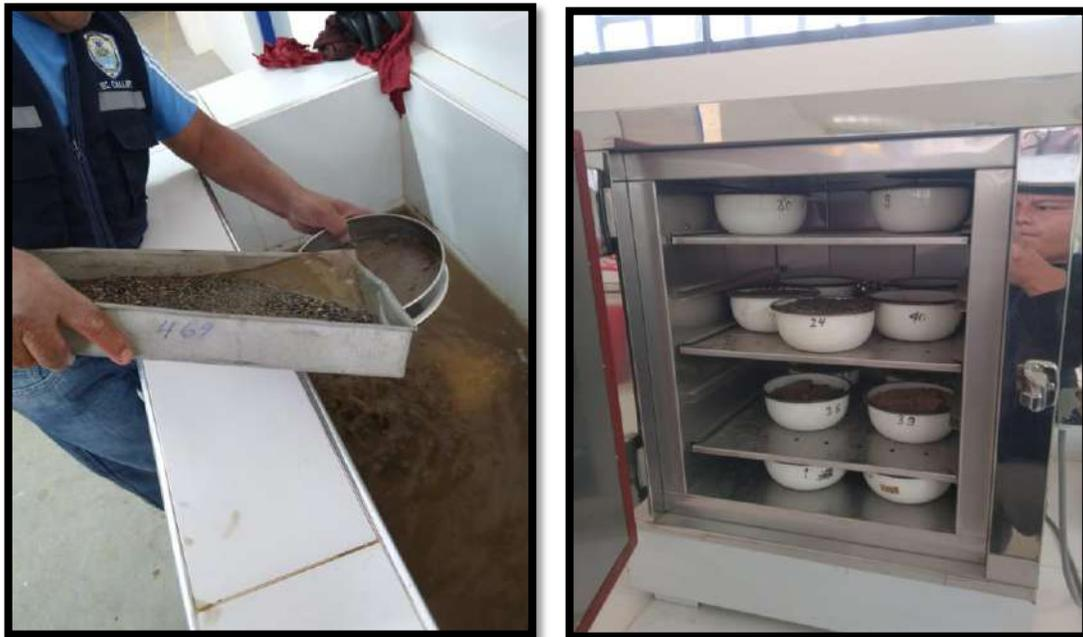
**Figura N°07:** Lavado del agregado para remover las materias orgánicas y secado en el horno para calcular su peso húmedo y seco
