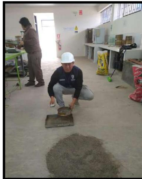
**Figura N° 06:** Secado del agregado y selección del material.
