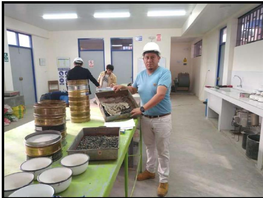
**Figura N° 10:** Proceso de saturación del agregado para posteriormente calculara la absorción del agregado
