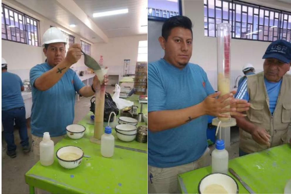
**Figura N° 13:** Proceso para calcular el peso específico del relave minero.
