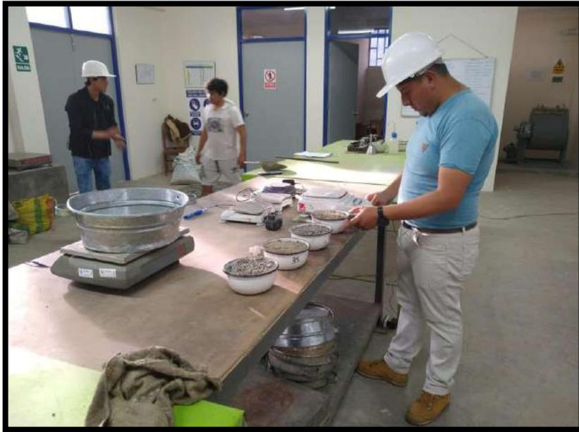
**Figura N° 11:** Proceso de toma de muestra y el pesado para proceder al cálculo peso específico
