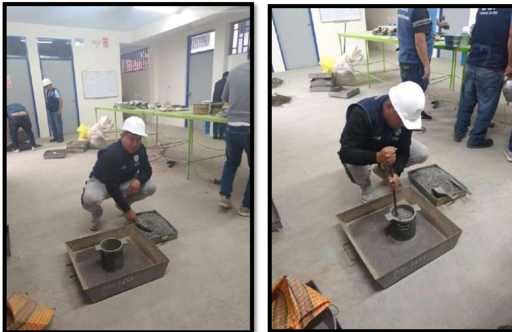
**Figura N° 08:** Proceso de para calcular el peso unitario del agregado fino mediante el método volumétrico.
