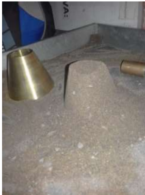
Figura 16. Arena superficialmente seca después del apisonado.
