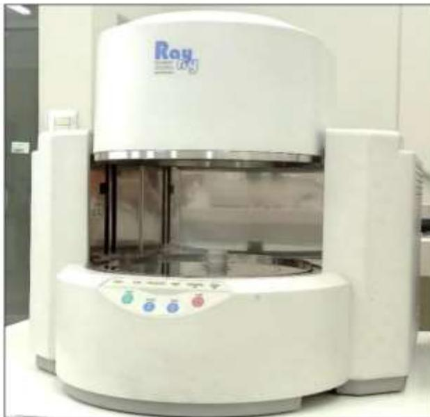
**Figura 2.** Equipo de Espectrofotometría de Fluorescencia de Rayos X.
