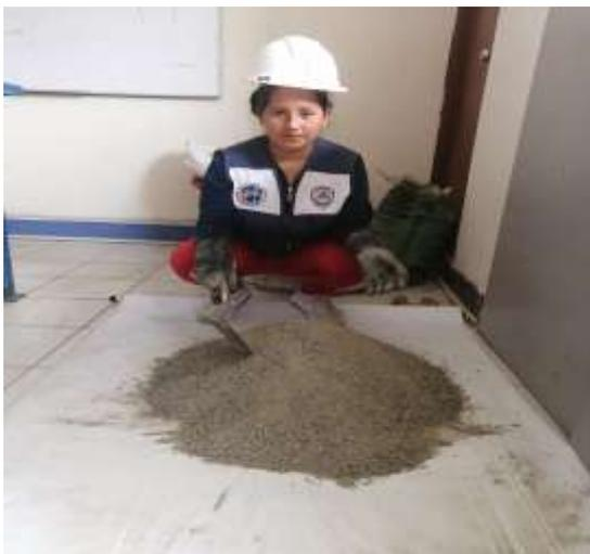
**Figura 31.** Apreciamos la mezcla de los agregados para la elaboración de ladrillos
