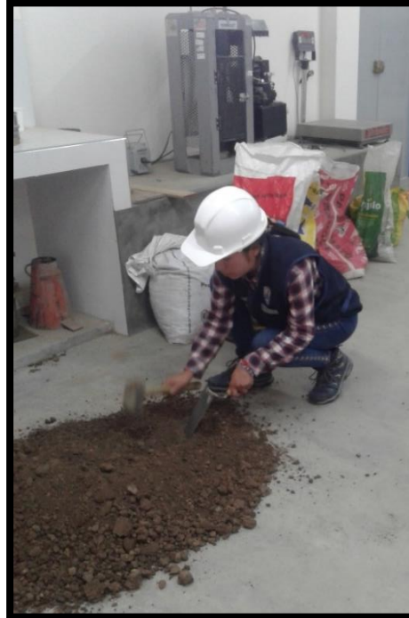
Figura 15. Proceso de cuarteo del suelo para obtención de la muestra a ensayar
