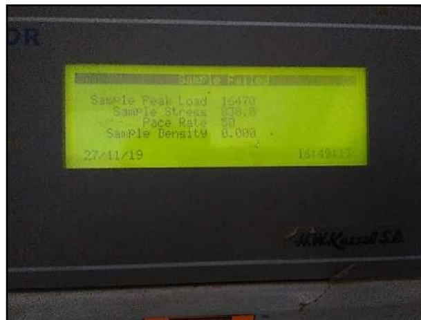
Fig. 103: LECTURA DE ENSAYO DE COMPRESION DE MUESTRAS (LADRILLOS)
