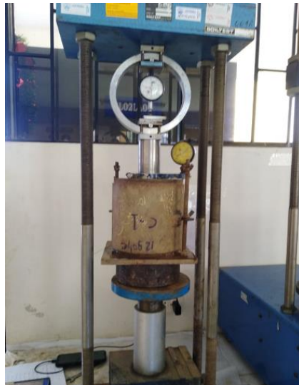
Figura 23. Ensayo de penetración de CBR
