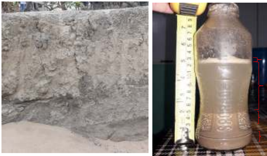
Figura 76: Prueba de la botella para saber los porcentajes de los componentes de la tierra.
