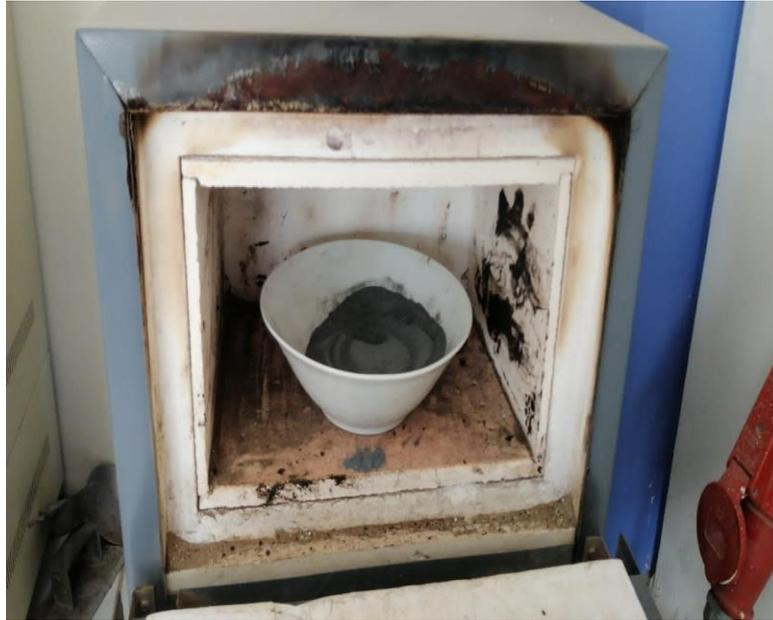
*Figura 15. Activación térmica de la cáscara de arroz en el horno*
