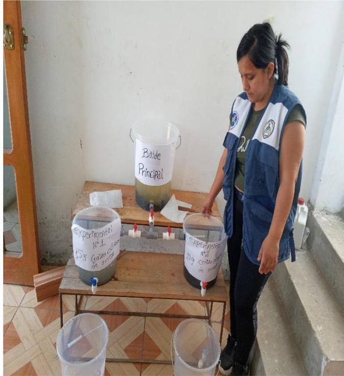
**Figura 19.** Mezcla con las cenizas de la cáscara de arroz en el agua.
