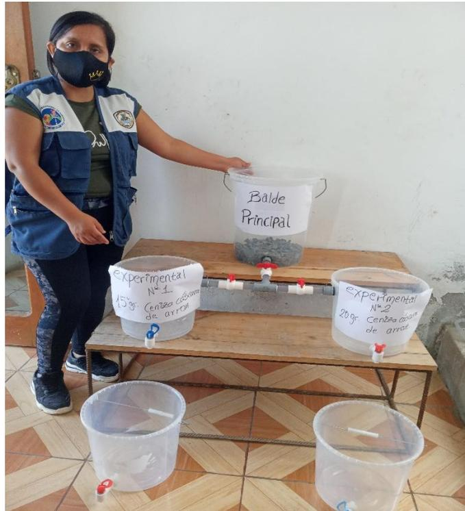
**Figura 17.** Elaboración del biofiltro (prototipo)
