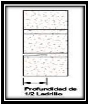
**Ilustración 10: Profundidad de perforación de 1/2 ladrillo.**
