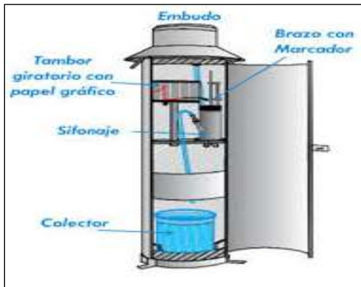
**Figura 2:** Pluviógrafo
