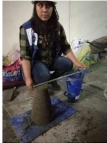
*Figura 29: Ensayo de Cono de abrams, asentamiento 0".*
