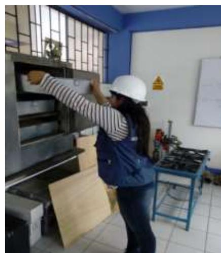
*Figura 19: Secado de CCA en el horno de la USP.*
