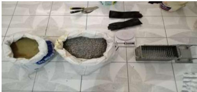
*Figura30: Materiales y agregados a utilizar para elaboración de ladrillo.*
