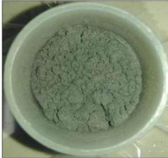
**Figura 1.** Muestra de cenizas de cascara de arroz.
