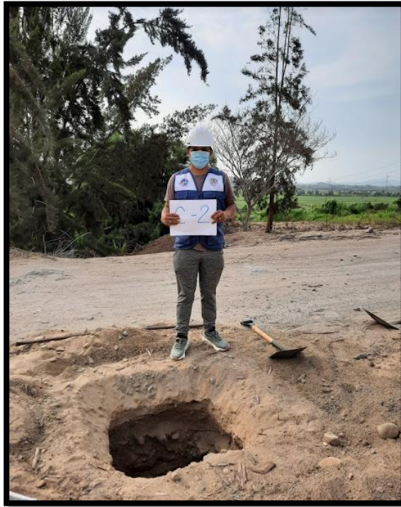
Figura 20. Extracción de suelo de la calicata N° 2.
