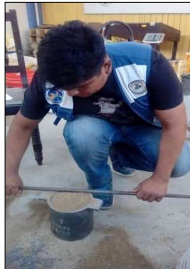
Fotografía 8. Peso unitario del agregado fino.
