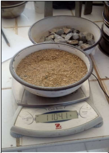
Fotografía 5. Preparación del agregado fino para los ensayos de caracterización.
