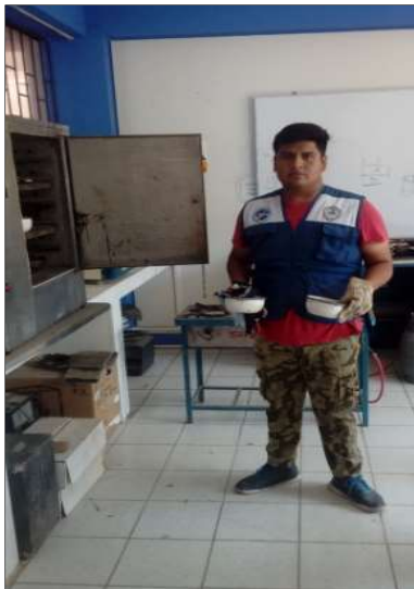
Fotografía 15. Pesaje de los agregados para el contenido de humedad, luego de estar 24 horas en el horno.
