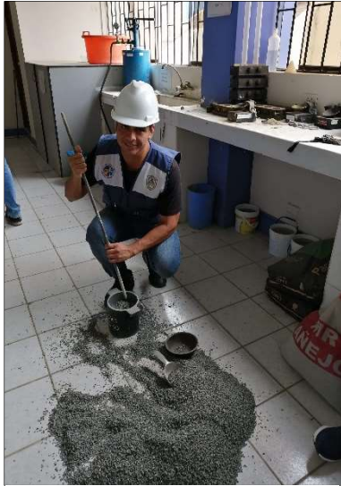
Fotografía 9. Peso unitario del agregado grueso.
