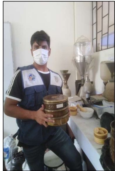
Fotografía 20. Se procedió a tamizar la arcilla hasta el pasante de la malla #200.
