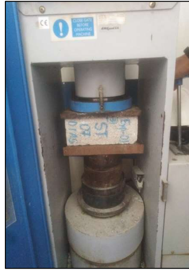
Fotografía 38. Ladrillos patrón y experimentales sometidos a carga axial.
