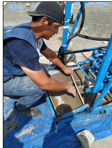
Fotografía 32. Proceso de vaciado y enrasado de la mezcla de concreto en las celdas de la máquina de ladrillos artesanal.
