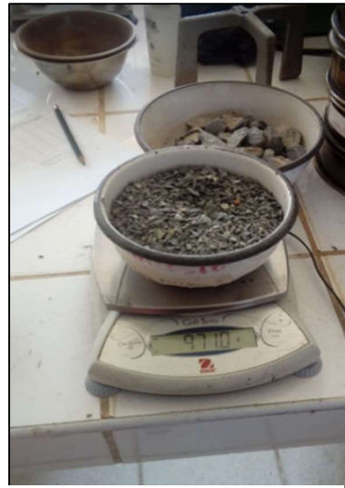
Fotografía 6. Preparación del agregado grueso para los ensayos de caracterización.
