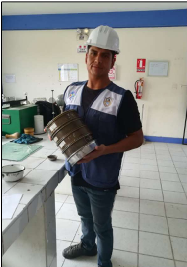
Fotografía 7. Análisis granulométrico mediante el uso de tamices.
