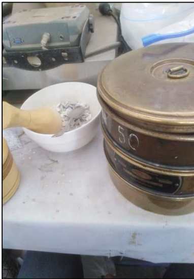
Fotografía 23. Se procedió a realizar el molido de la concha de choro y tamizado hasta el pasante de la malla #200.
