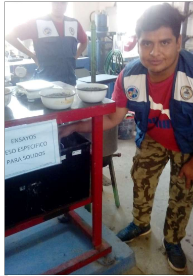
Fotografía 14. Ensayo del peso específico para el agregado grueso.
