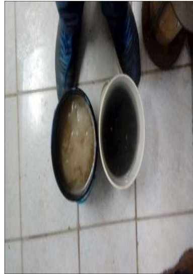
Fotografía 10. Agregados sumergidos en agua para su posterior ensayo.
