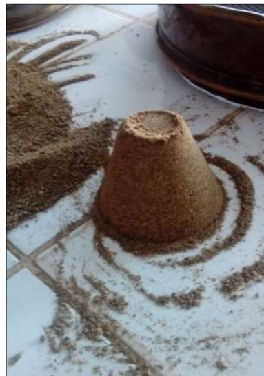
Fotografía 12. Prueba del cono para ver la trabajabilidad.
