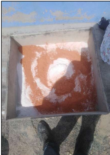
Fotografía 25. Mezcla de los materiales a sustituir y el cemento.
