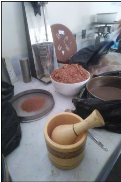
Fotografía 19. Se procedió a realizar el molido de la arcilla previamente activada en la mufla.
