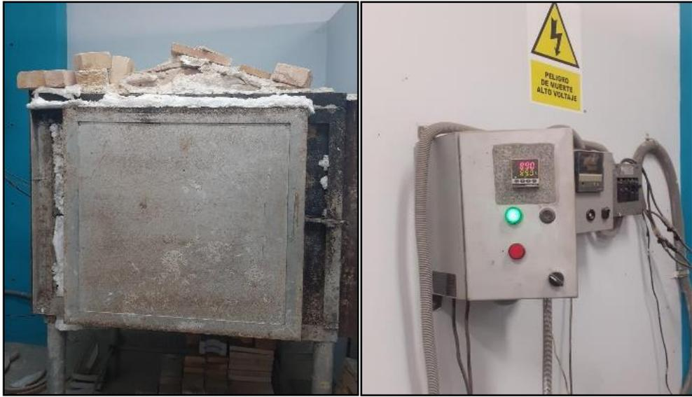
**Foto 3.** Quemado de ramas de bambú a 700° y conchas de abanico a 890° en horno mufla
