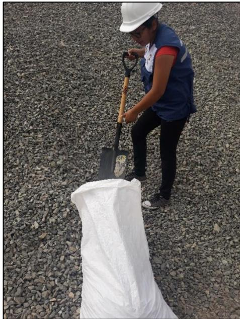
**Foto 4.** Obtención de agregado grueso
