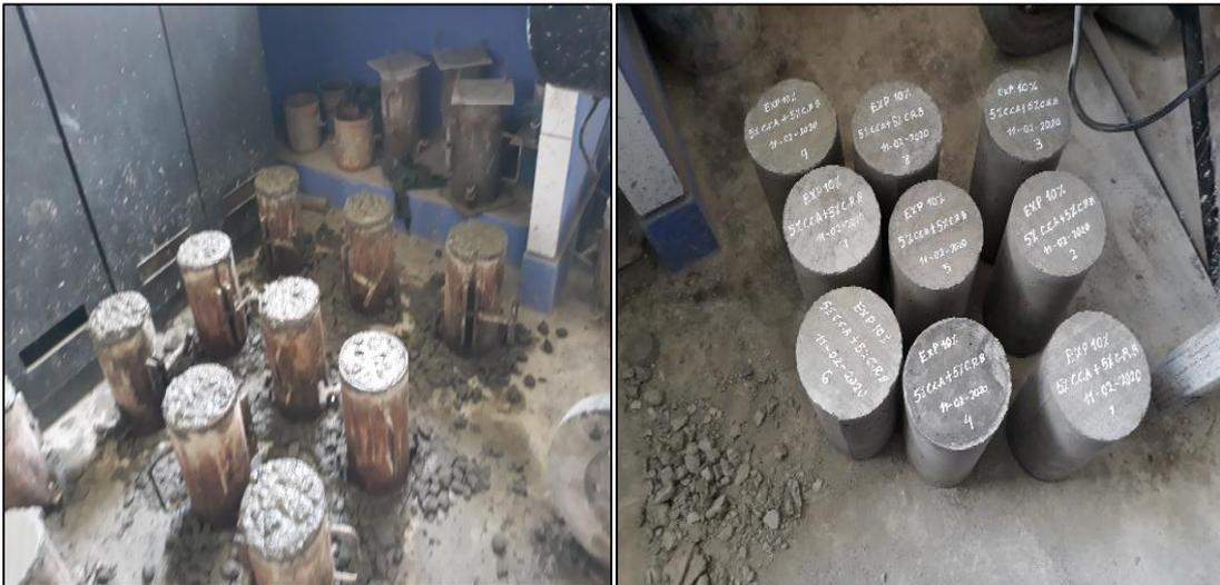
**Foto 12.** Desencofrado de probetas
