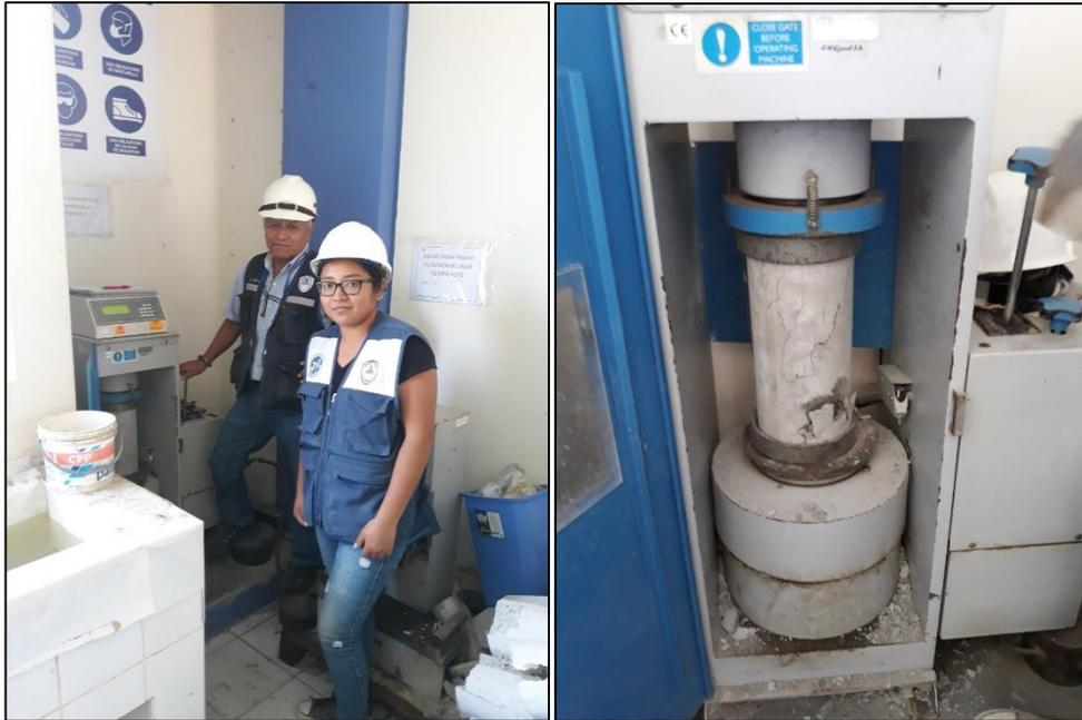
**Foto 13.** Ensayo de resistencia a la compresión
