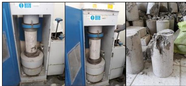
Figura 29 Tipos de fallas encontradas en las probetas patrón y experimentales (Ensayos lab. USP)
