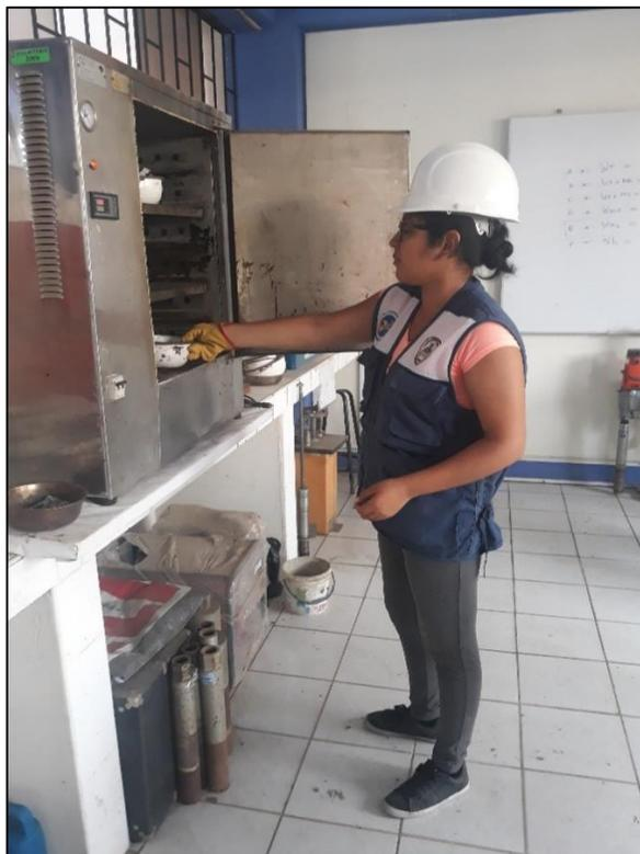
**Foto 6.** Contenido de humedad de agregados
