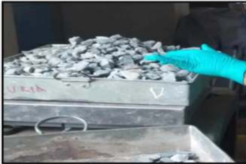
FOTO N° 14: Pesado de la piedra de 1" para elaboración del concreto.
