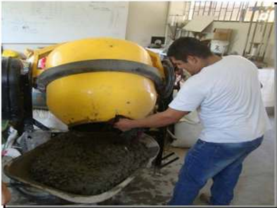
FOTO N° 20: vaciado de la mezcla en el bugí
