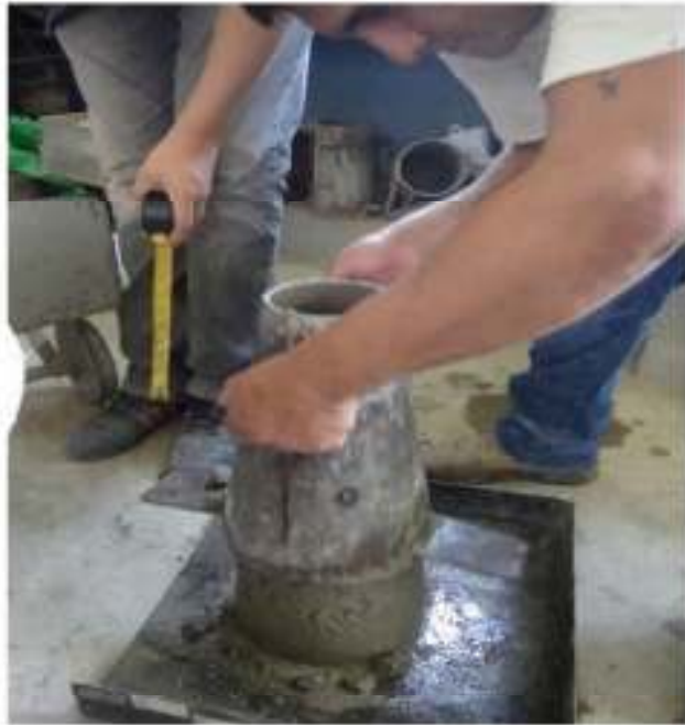
FOTO N° 21: chuceado para determinar el asentamiento del concreto
