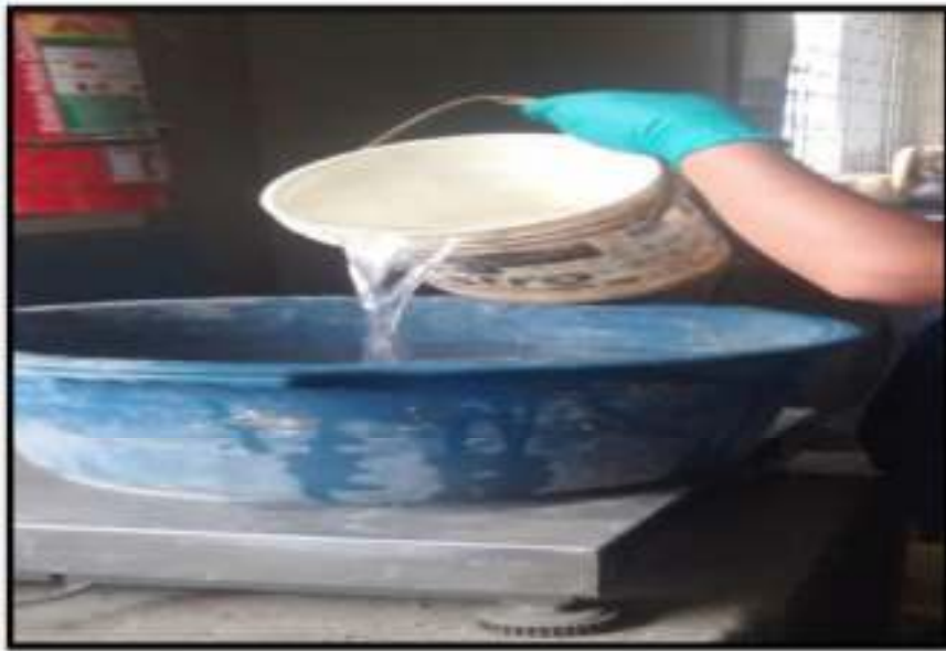
FOTO N° 16: Pesado del agua para elaboración del concreto
