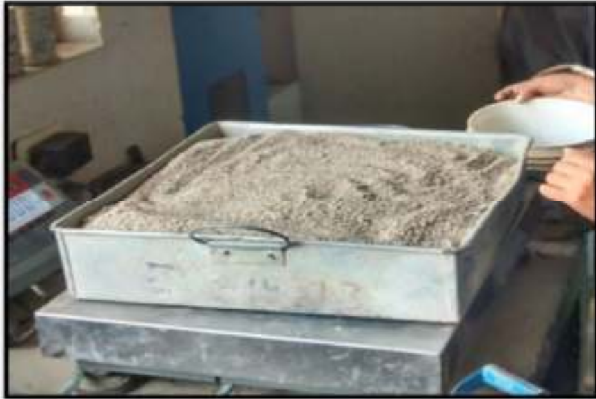
FOTO N° 15: Pesado de la arena fina para elaboración del concreto
