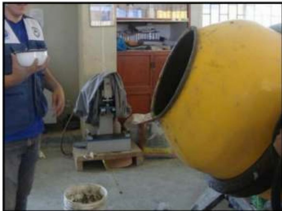
FOTO N° 18: Adicionando polvo de roca gabro a la mezcla
