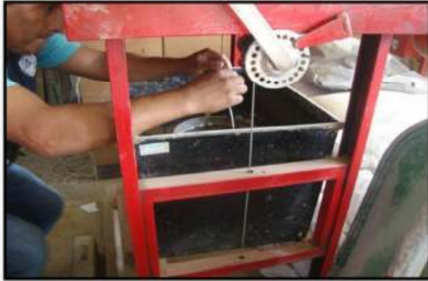
FOTO N° 09: Luego es llevado y colocado a un recipiente para luego pesarlo y calcular el peso sumergido del material.
