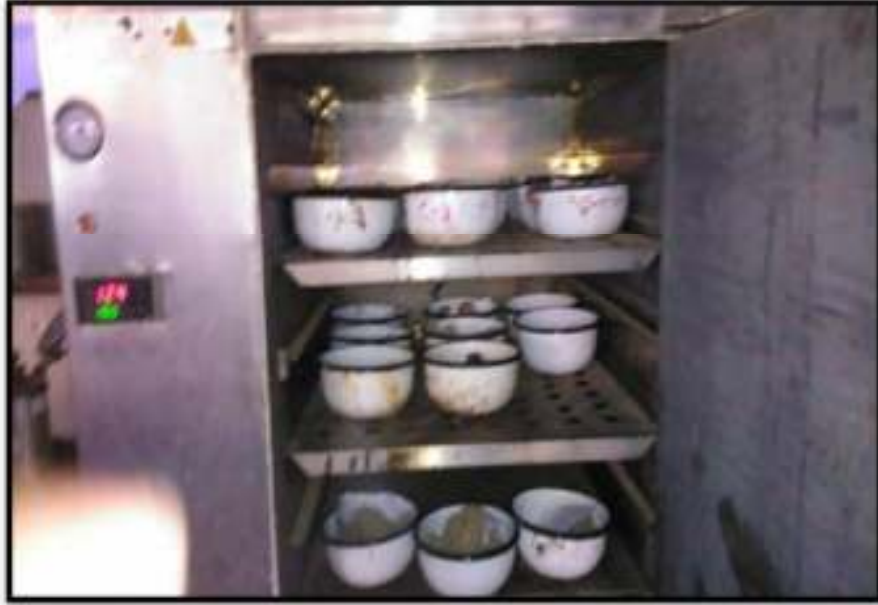
FOTO N°05: Se dejó 3 muestras en el horno y dos se dejó para la granulometría.
