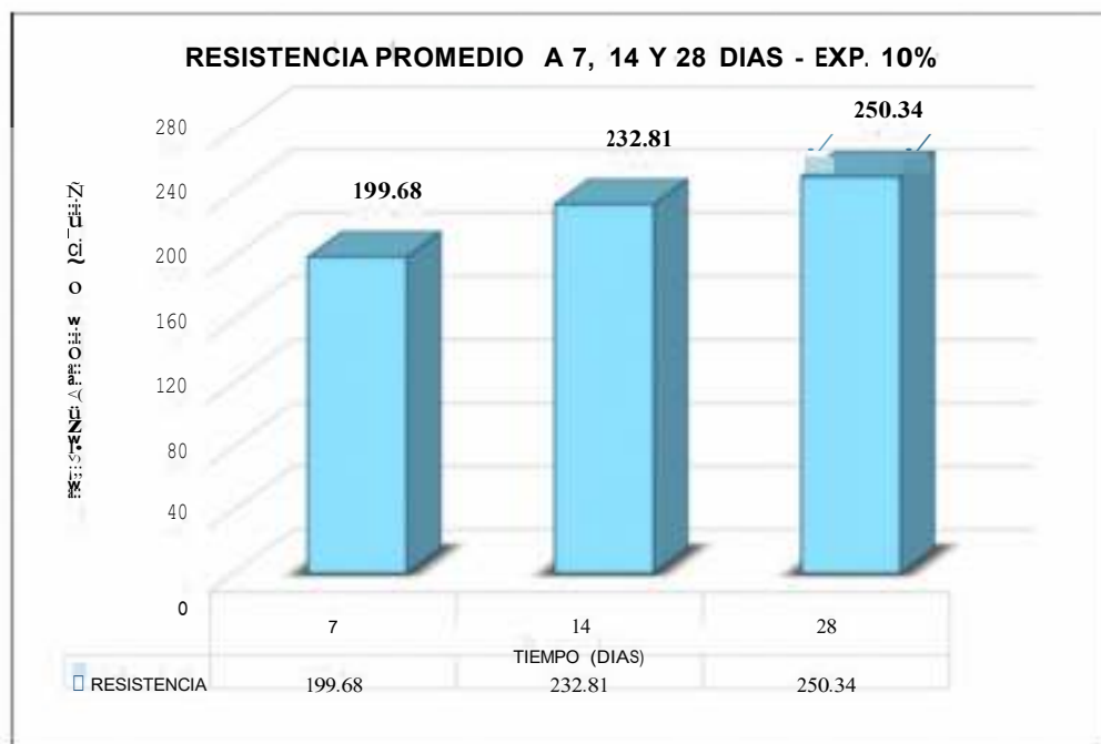
Figura 05: Resistencia a la compresión del concreto con adición 10% de roca de gabro
