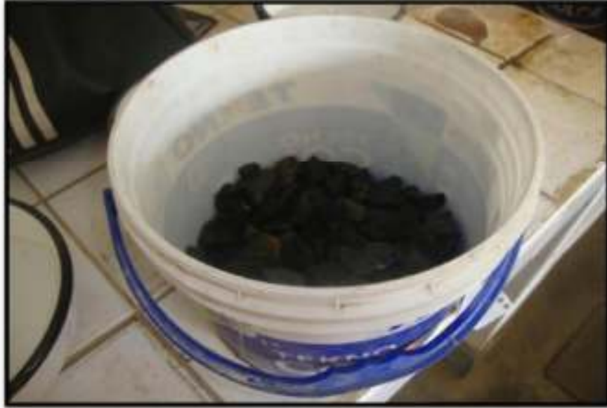
FOTO N° 07: Se dejan dos muestras de arena y piedra en agua por 24 horas
