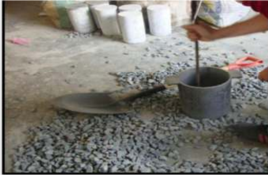
FOTO N° 03: Ahora llenamos el material, pero ahora compactando en tres capas dando en cada capa 25 golpes con la ayuda de una varilla.
