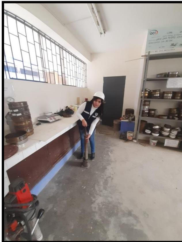
**Figura 30.** Realizando el proctor modificado
