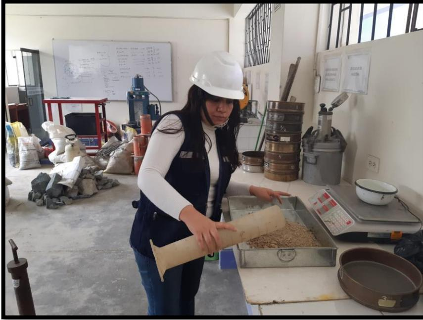
**Figura 29.** Agregando la humedad para el proctor modificado del afirmado.
