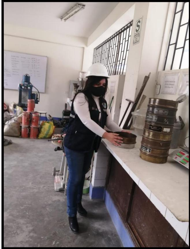
*Figura 27.* Realizando el análisis granulométrico del afirmado.
