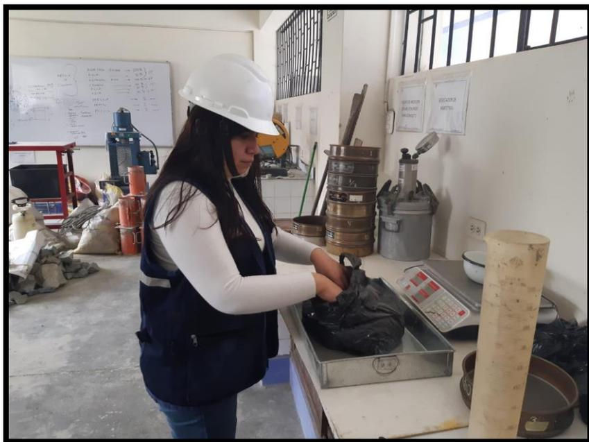
*Figura 28.* Seleccionando la muestra para proctor y CBR
