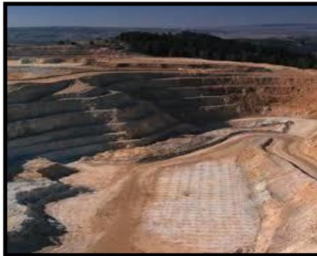
**Figura 01.** Excavación de una cantera por banqueo
