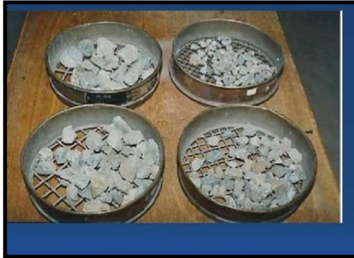
**Figura 20:** gradación de agregado grueso
