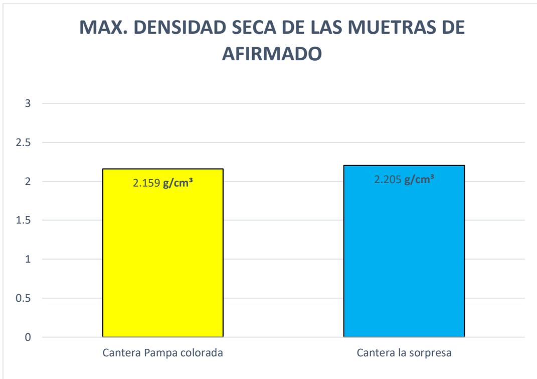
**Figura 16.** Se observa en la figura que la cantera Pampa Colorada tiene menor densidad que la cantera la Sorpresa.
