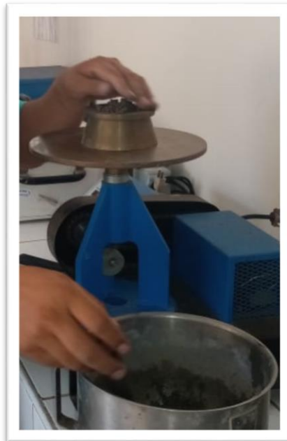
Foto N° 14: se realiza la fluidez del mortero
