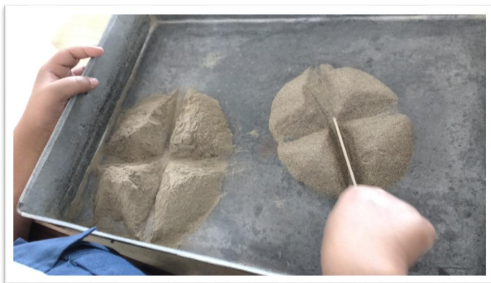
Foto N° 12: Se procede a hacer el cuarteo de la arena gradada, para luego mezclarla con el cemento antes de poner en la mezcladora.
