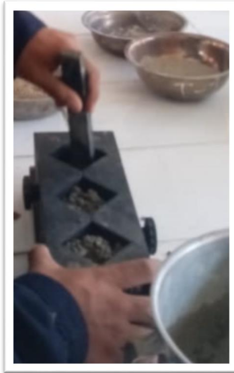
Foto N° 15: Se procedió a vaciar la mezcla de mortero en el molde, y con el apisonador de madera se compactó 32 veces que se hizo en 4 partes cada una con 8 lados en sentido horizontal y vertical
