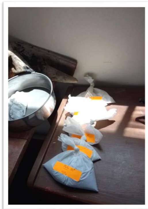
Foto N° 06: Pesos del relave minero según la malla retenida desde la malla N° 4 hasta el plato.
