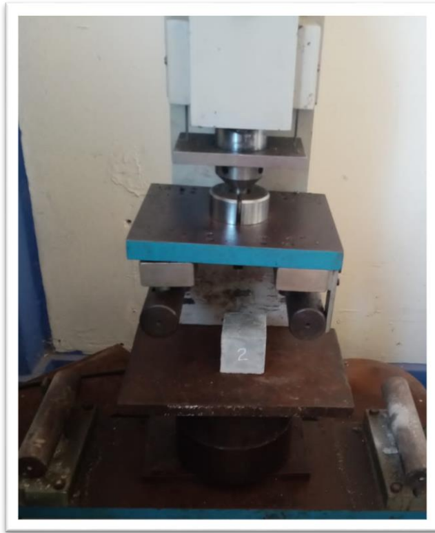
Foto N° 19: Prensa donde se realizará la rotura de los especímenes de mortero. (LABORATORIO DE SUELOS DE LA UNIVERSIDAD SAN PEDRO)
