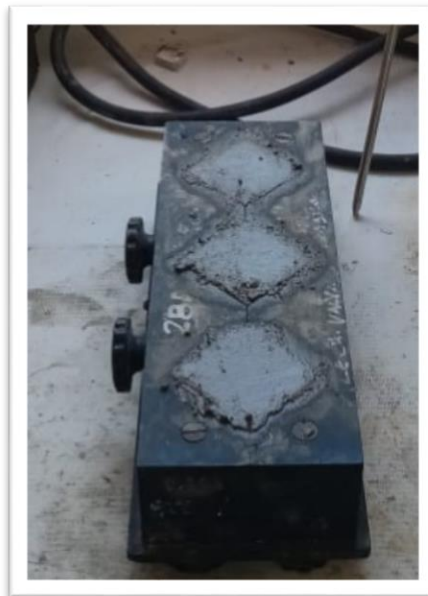
Foto N° 16: Terminado el anterior proceso, se procedió a enrasar, quedando de esta manera listo para el fraguado, de un tiempo de 24 horas. Luego se procede al curado de acuerdo a los días 3, 7 y 28 respectivamente
