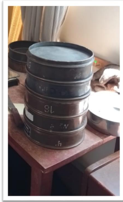
Foto N° 05: Tamizado del relave minero, para determinar en qué tamiz se encuentra las partículas con mayor porcentaje de retención.
