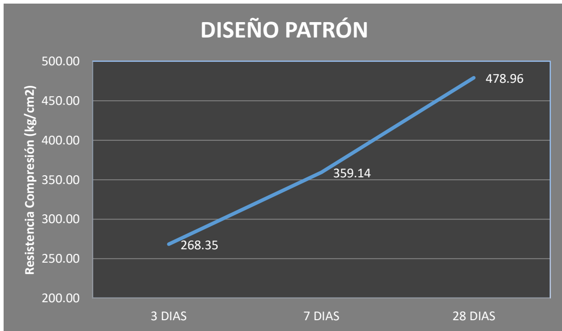
Figura 1. Resistencia a la Compresión (Kg/cm 2 ) Vs. Edad (Días)
