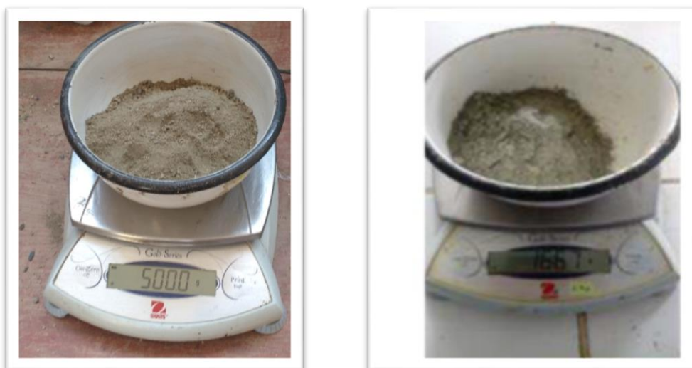
Foto N° 11: Se pesaron cemento, arena y agua para la elaboración del mortero patrón
