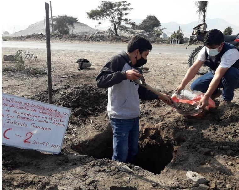
**Foto 4:** Excavación de calicata N° 02, con la supervisión del personal de Laboratorio de Ensayo de Materiales de la USP
