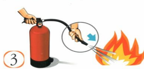
PASO 3: Dirigir el chorro a la base de la llama, procurando mantener la botella en posición vertical.
