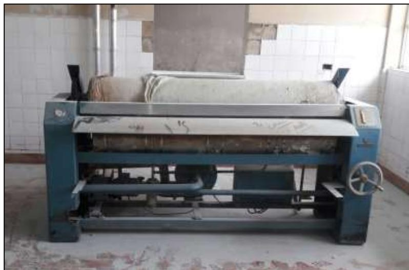
**Figura 18.-** Fotografía Equipo Plancha tipo rodillo industrial.
