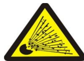
Material con riesgo de explosión.
