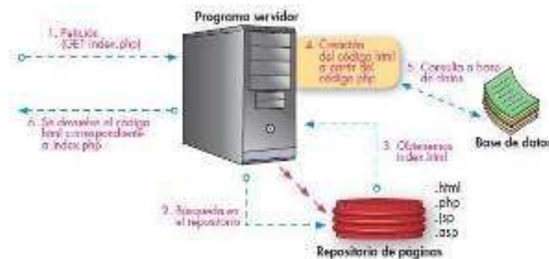
Figura 03: Funcionamiento del servicio web con páginas dinámicas Fuente: Fuente: smr214apweb.blogspot.pe
