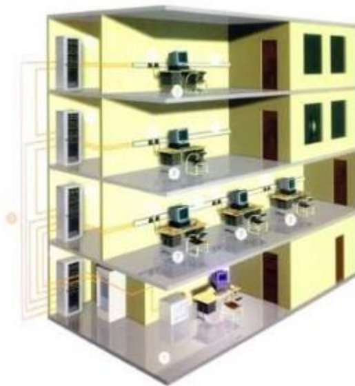
Figura N° 05. Sistema de Cableado Estructurado Fuente. Lescano, 2009.
